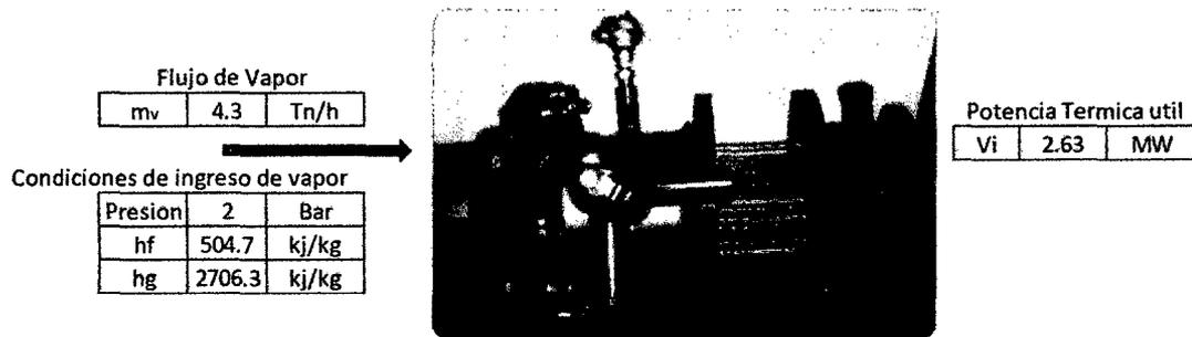
Figura N°37 Determinación de Potencia Térmica Útil en Servicios Auxiliares
