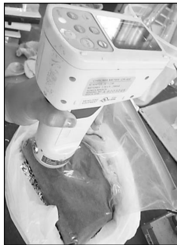
FIGURA N°18: TOMA DE DATOS DEL COLOR PARA LA MUESTRA: HARINA DE YUYO ( Chondracanthus Chamissoi )
