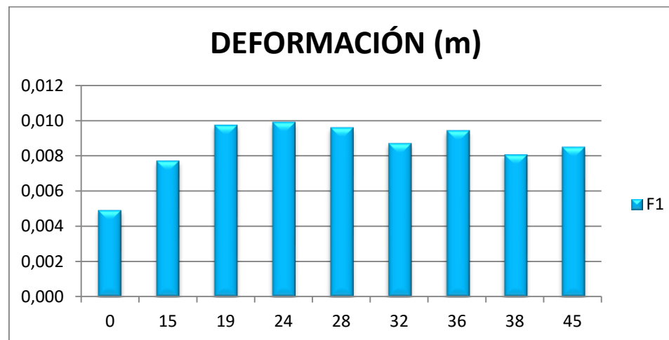
FIGURA A-8: Deformación de las Barras Energéticas durante los días de almacenamiento.
