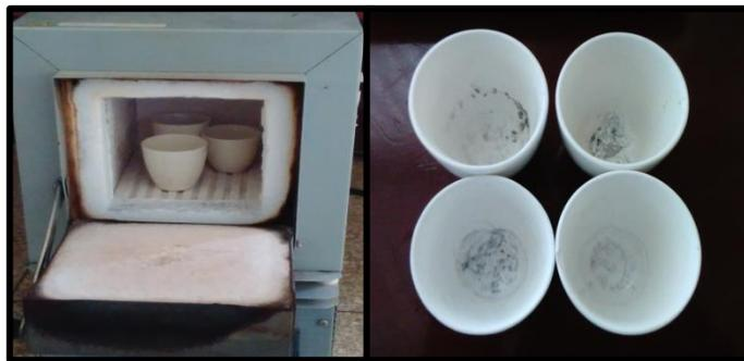
**Figura N°33:** Cenizas de la muestra después de la calcinación en la mufla.
