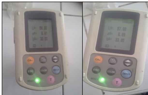
Figura N°41: Colorímetro con valores de  $L^*$ ,  $a^*$  y  $b^*$
