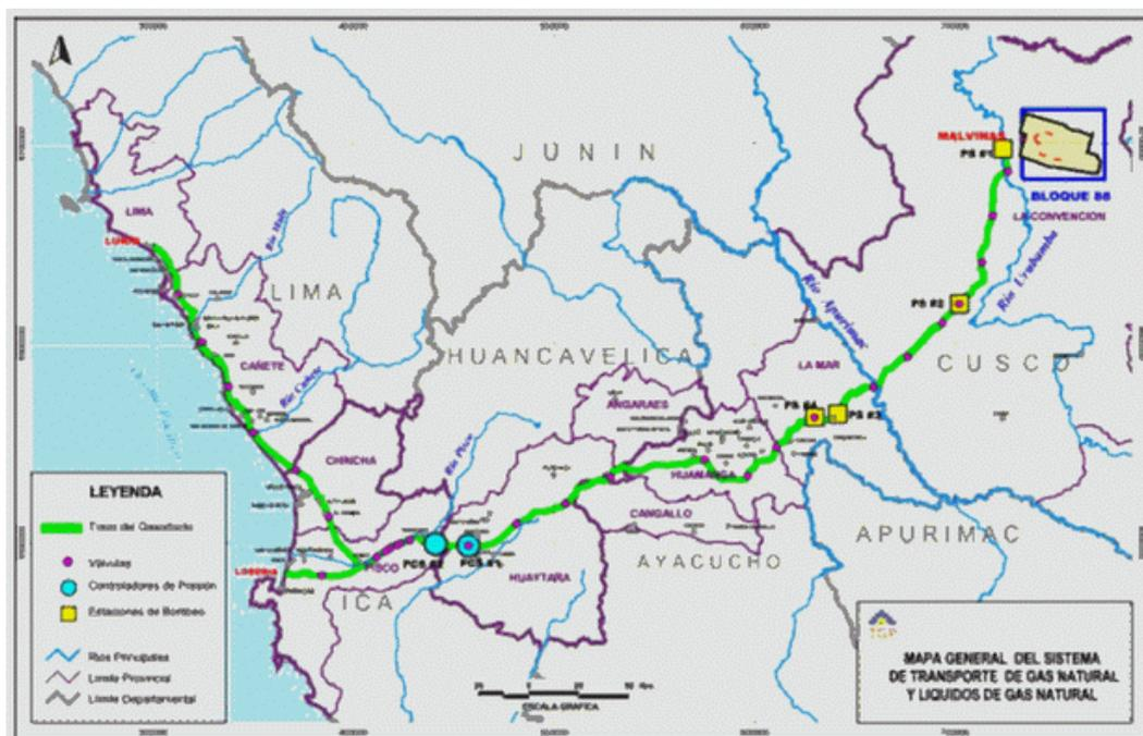
Figura N° 15 Ducto de transporte de Gas natural
