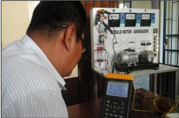
**Figura 53:** Realizando las pruebas del Módulo motor – generador.
