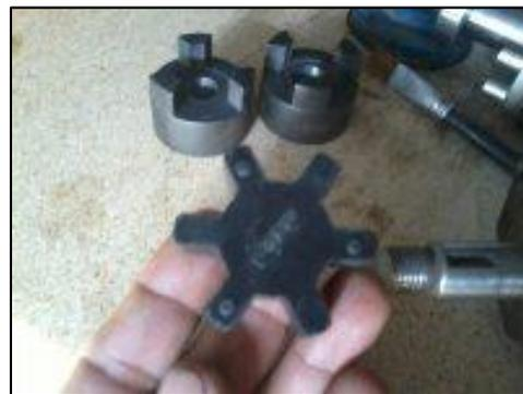
**Figura 47** Acoplamiento mecánico de goma.
