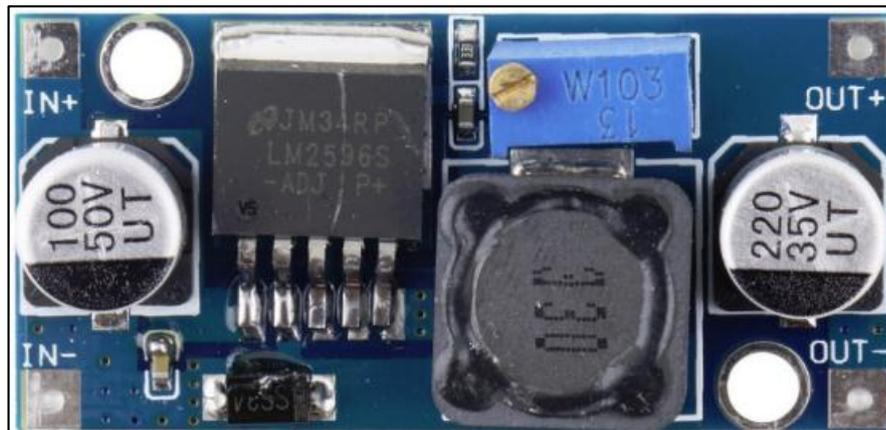
**Figura 42:** Fuente de alimentación con el LM 2596.
