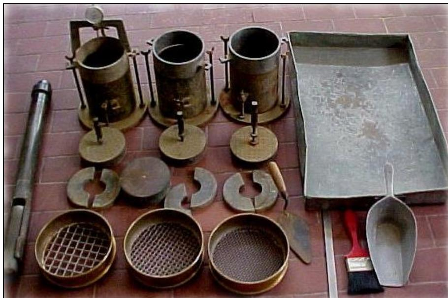
**Figura 3.5.1: Equipo necesario para el ensayo CBR.**
