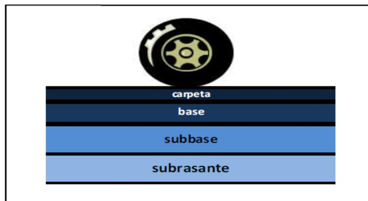
Fig. 2.1.1 Esquema típico de la estructural de un pavimento
