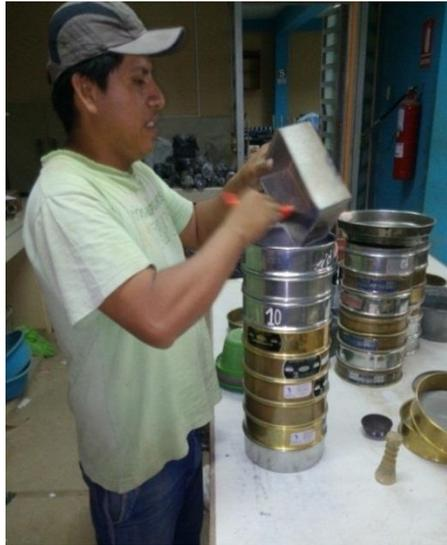
Fotografía. 3.5.1 Análisis granulométrico por tamizado.
