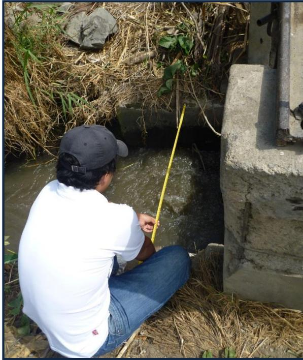
**Foto 09:** Tomando medidas de la sección del canal de inicio donde se colocara el desarenador -progresiva 0+000
