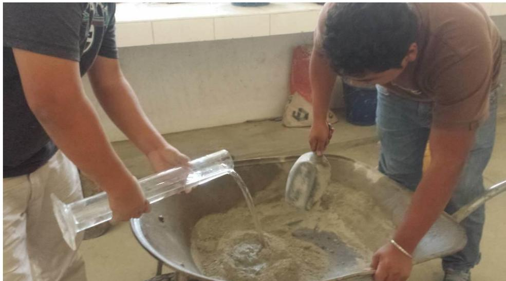
**Fig. N°08.-** Se observa la mezcla manual de los materiales en la fabricación de la escoria
