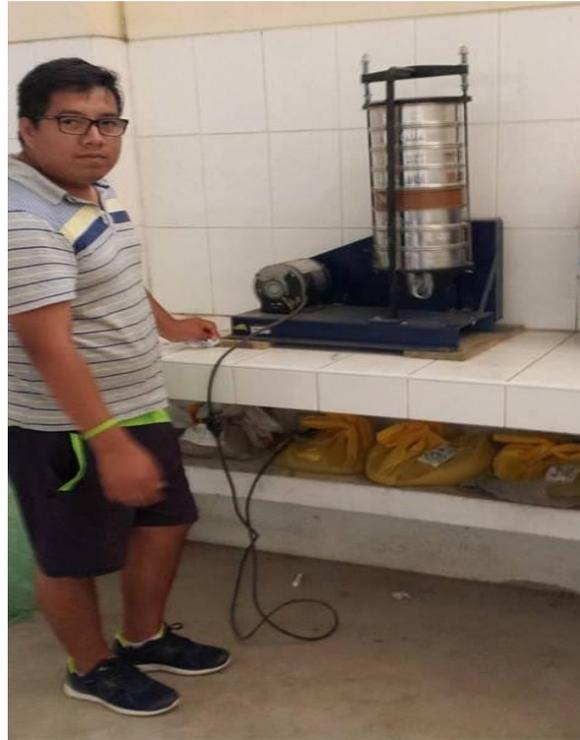
**Fig. N° 05.-** Tamizado de los agregados
