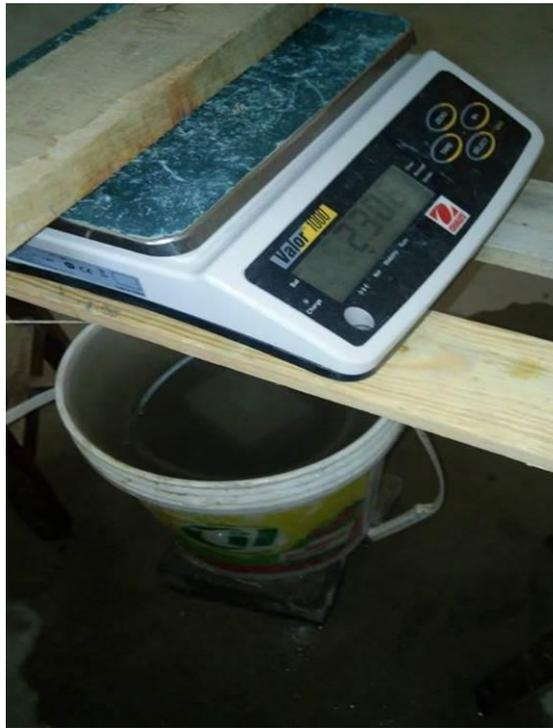
**Foto N°15.-** Se realizó el ensayo de densidad de adoquines
