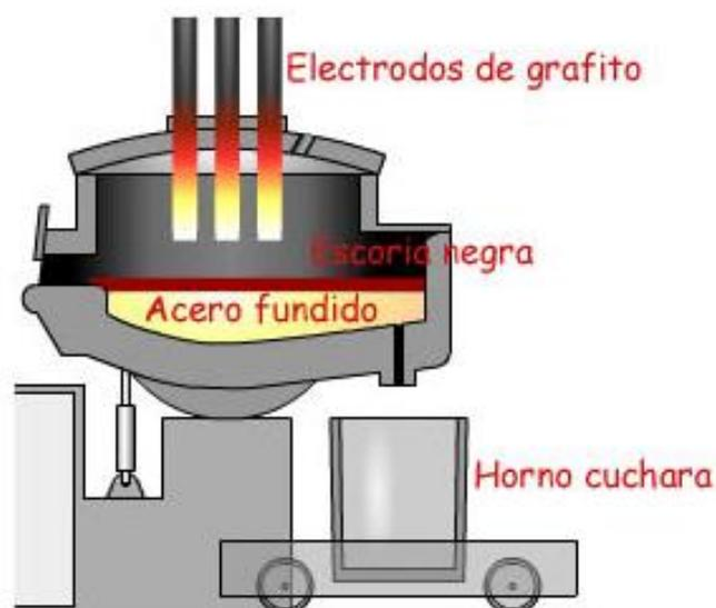
Figura N°07. Esquema de proceso de producción.
