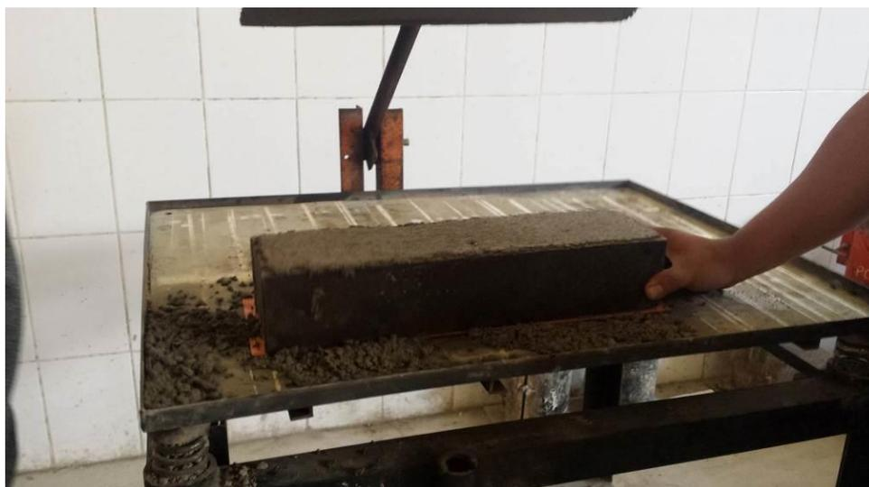
**Fig. N°10.-** Vibrocompactación del adoquín
