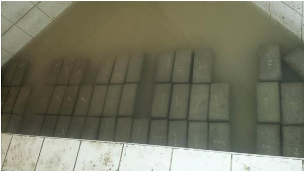
**Fig. N°12.-** Curados de los elementos de adoquines fabricados
