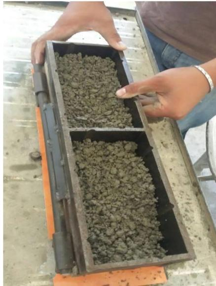
**Figura N°16 Moldeado del adoquín.**
