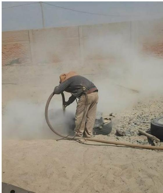
**Foto N°16.-** Se muestra el procedimiento del ensayo de desagaste al adquin mediante el método de chorro de arena a presión.
