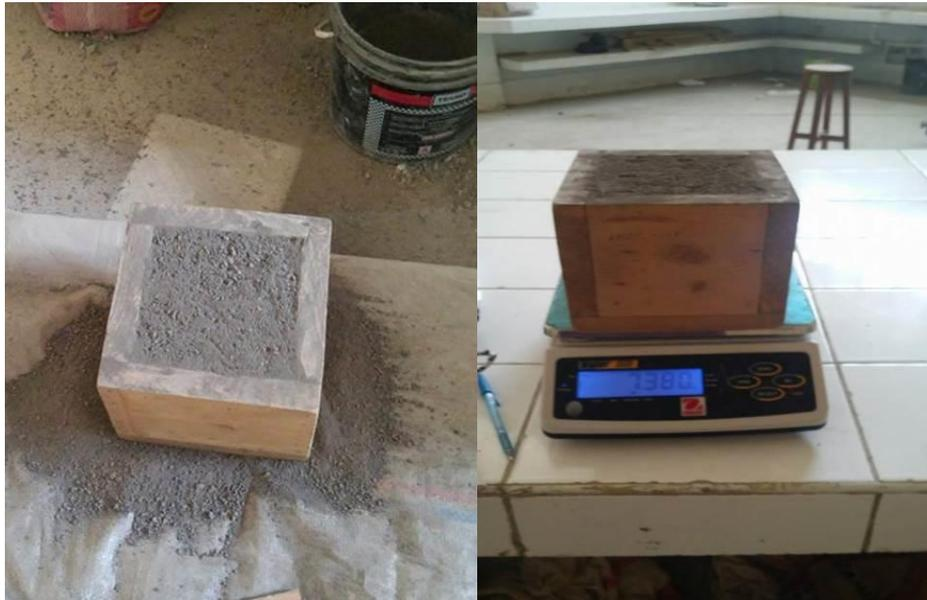
**Fig. N°04.-** Peso suelto y varillado de los agregados
