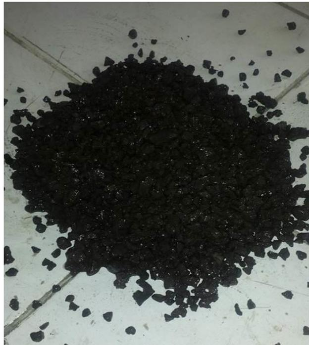
**Fig. N°02.-** Escoria empleada en la fabricación de los adoquines
