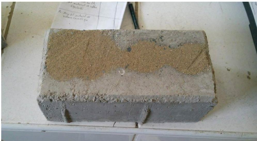
**Foto N°14.-** Se realizó el ensayo de desgaste de los adoquines
