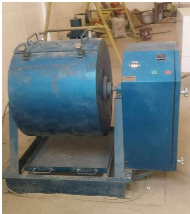
**Fig. N°06.-** Se aprecia la máquina de los ángeles empleada en la molienda de la escoria
