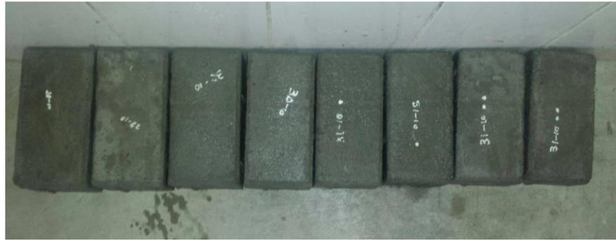
Figura N°17 Fraguado de los adoquines.
