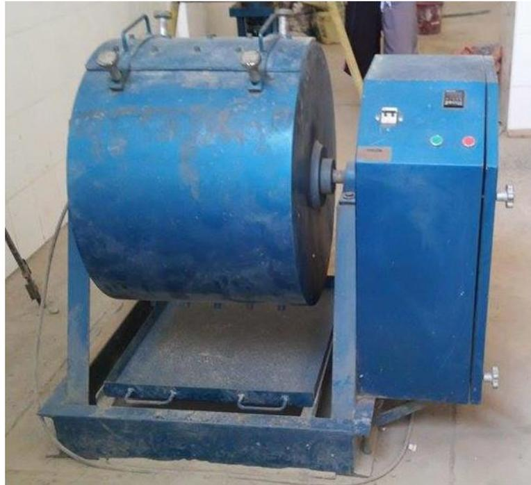
**Figura N°11. Proceso de molienda de la escoria de horno eléctrico.**
