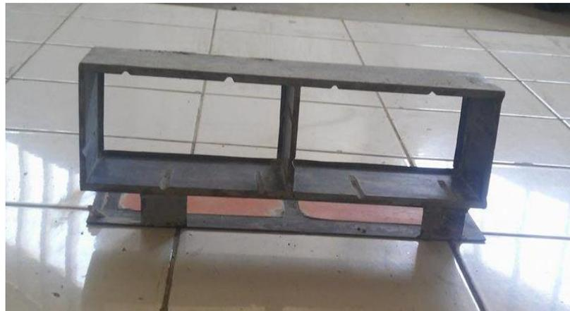
**Figura N°15 Molde de adoquín.**
