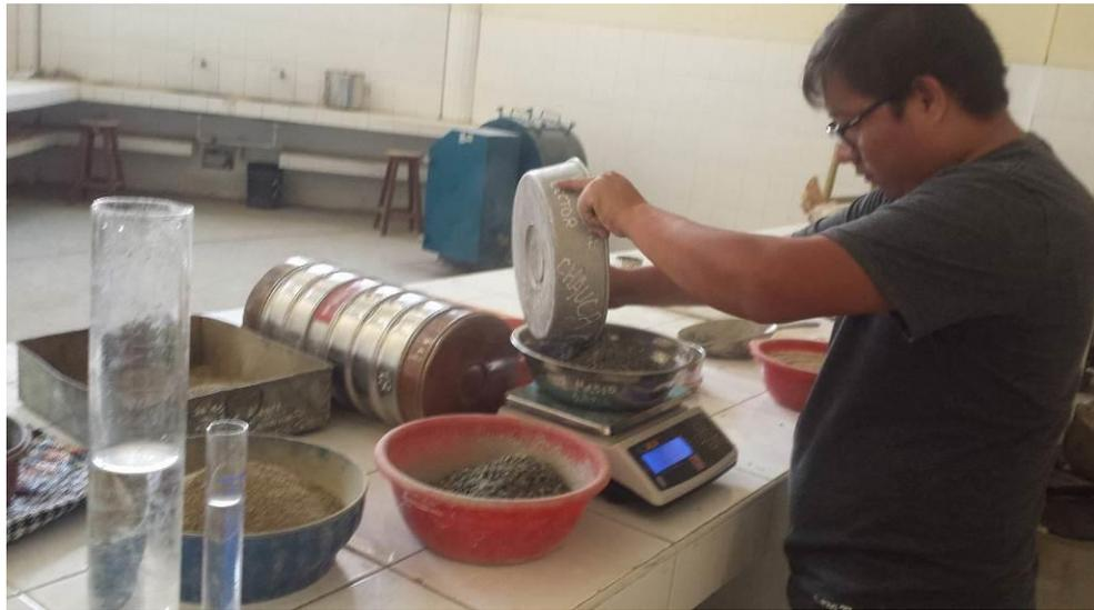
**Fig. N°07.-** Se muestra la dosificación de cada componente para la preparación de los adoquines
