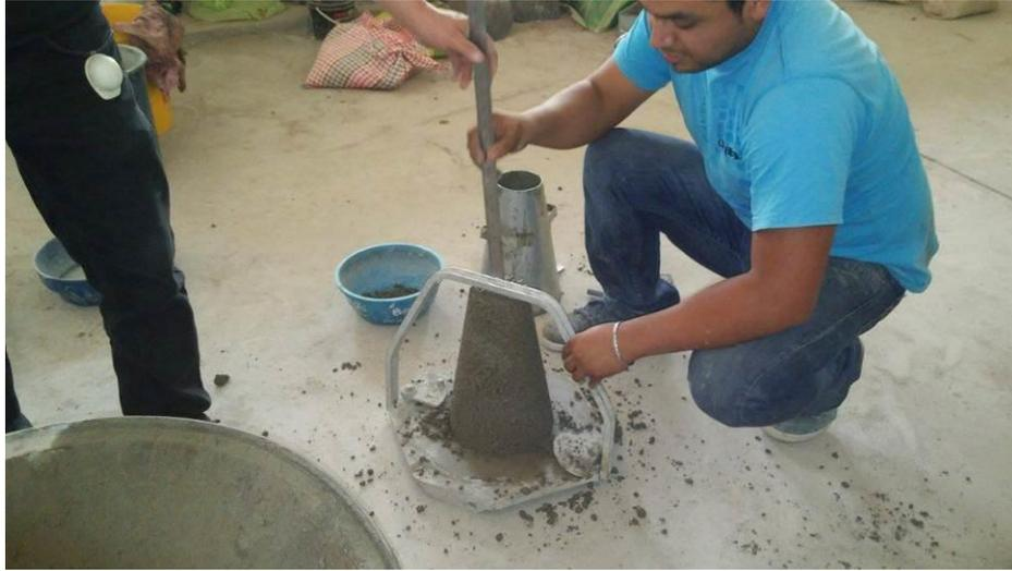
**Foto N°11.-** Determinación de la trabajabilidad de la mezcla (Slump)
