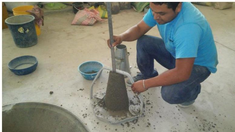
**Figura N°14 Consistencia del concreto (Slump.)**
