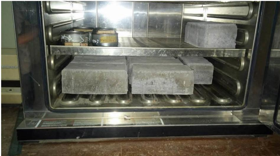
**Fig. N°17.-** Secado de los adoquines para obtener su contenido de humedad
