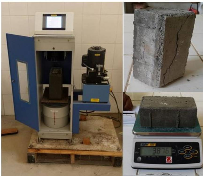
**Fig. N°18.-** Ensayos de resistencia a la compresión de los distintos adoquines fabricados
