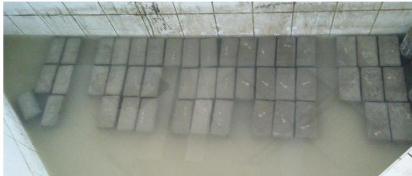
Figura N°18 Curado de los adoquines.
