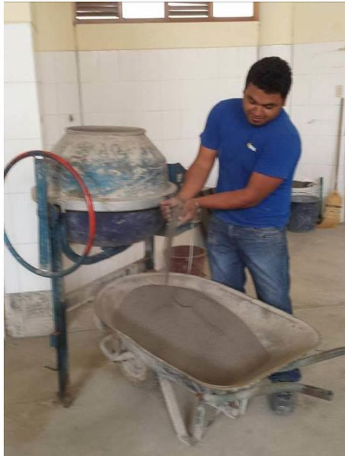
**Fig. N° 09.-** Mezclado de materiales para la fabricación de adoquines con trompo
