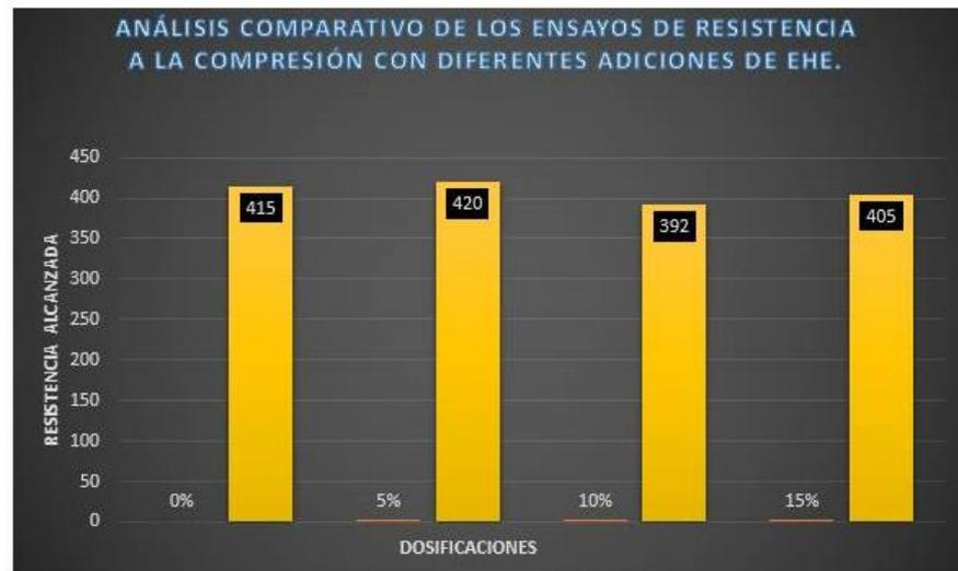
**Figura N°21 Análisis comparativo de los ensayos de resistencia a la
