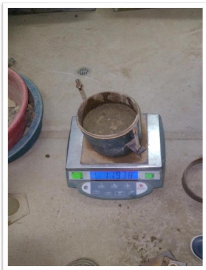
**Foto N°03:** Peso del molde más muestra después de ser compactado y enrasado antes de su saturación.
