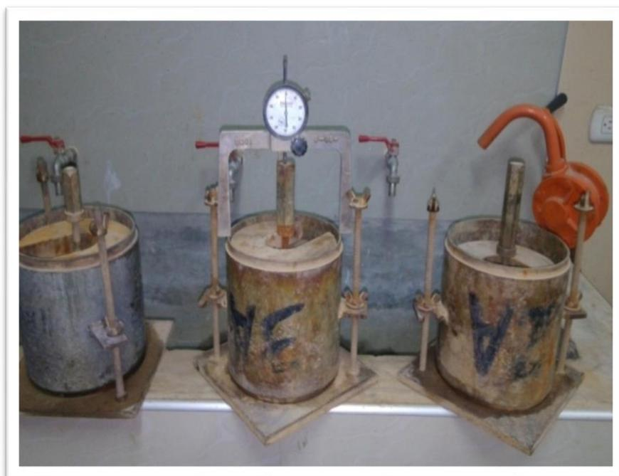
**Foto N°05:** Vista del dial, antes de la saturación de los especímenes.
