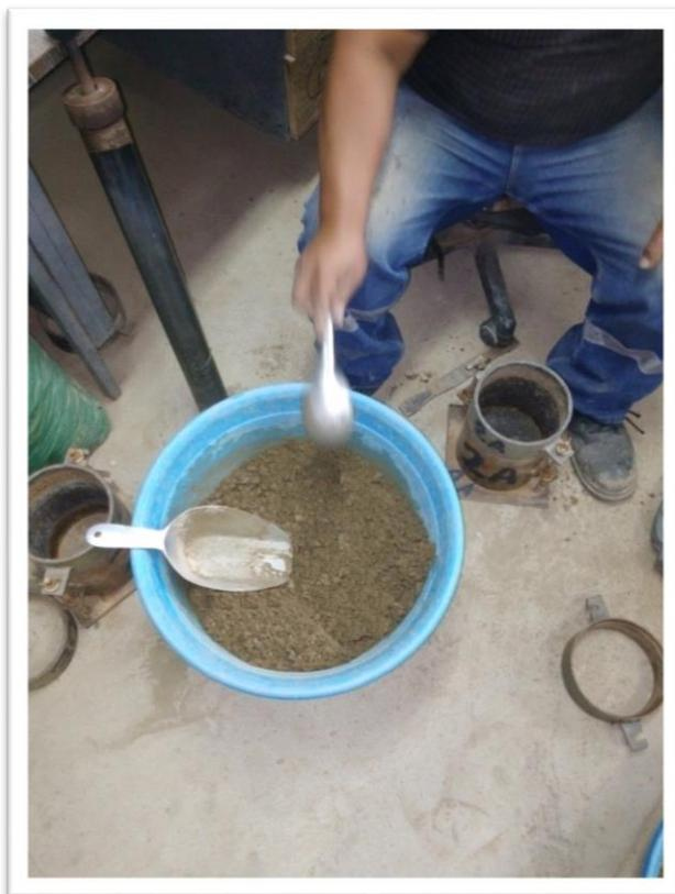
**Foto N°01:** Proceso de preparación de la muestra con el óptimo de humedad para elaboración del espécimen, para determinar el CBR.
