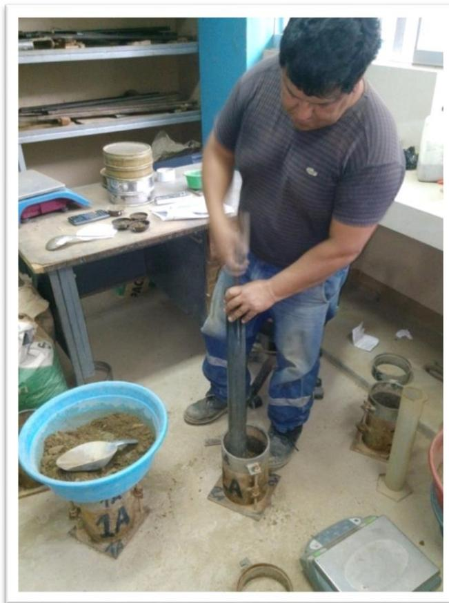
**Foto N°02:** Aplicación de grados de compactación para el CBR, realizados con 56, 25 y 10 golpes por capa, con el contenido óptimo de humedad correspondiente.
