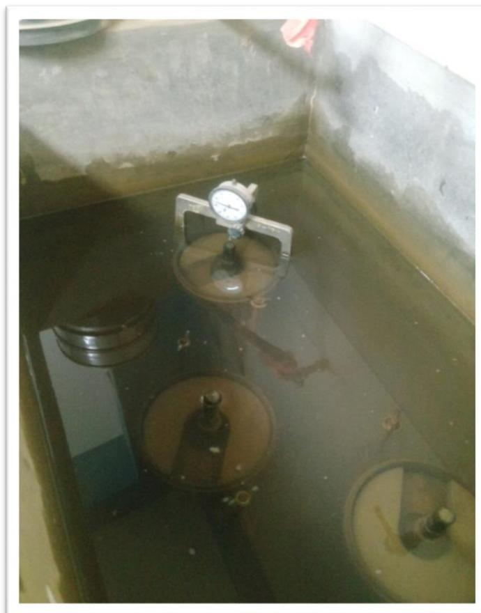
**Foto N°07:** Lectura del dial después de la saturación de los especímenes.
