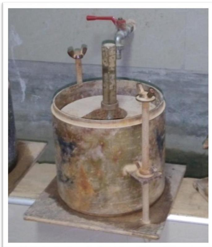
**Foto N°04:** Colocación de la sobrecarga en los especímenes.
