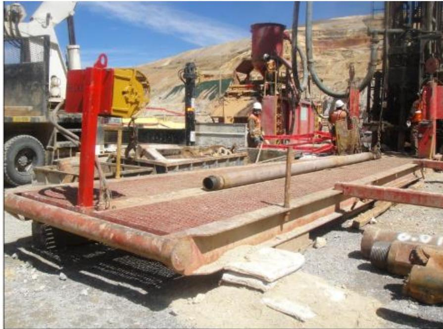
*Foto. Plataforma de barras para el pozo*
