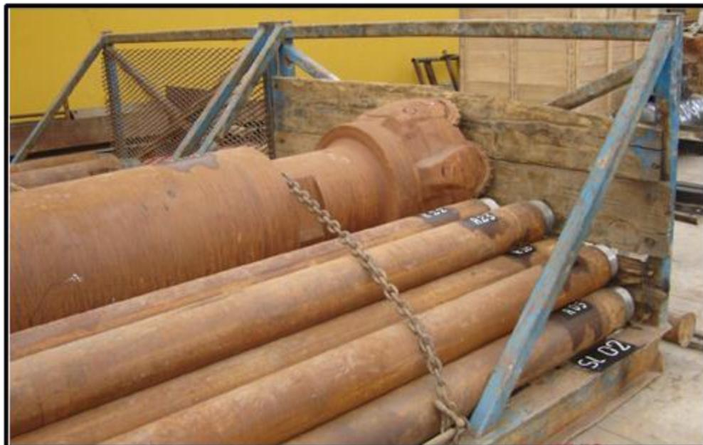
**FOTO N°2:** SE OBSERVA LAS HERRAMIENTAS DE PERFORACIÓN – TUBERÍAS Y ESTABILIZADOR
