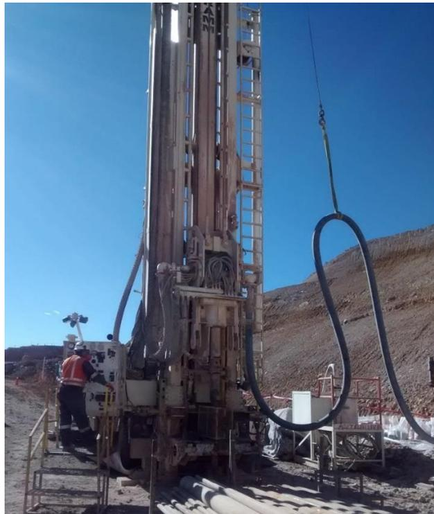
*Foto. Máquina perforadora Schramm T130XD*
