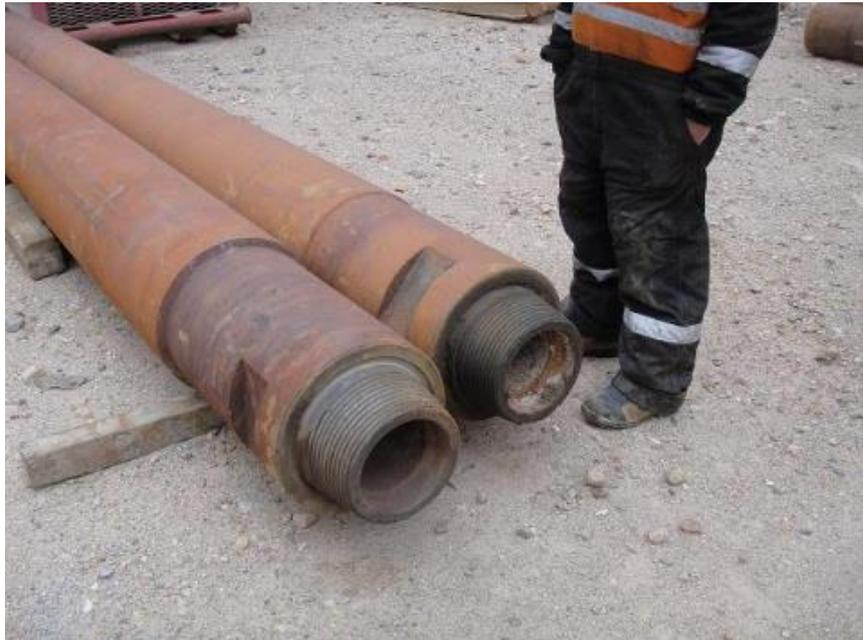
*Foto. Barras de peso para líneas de montaje*
