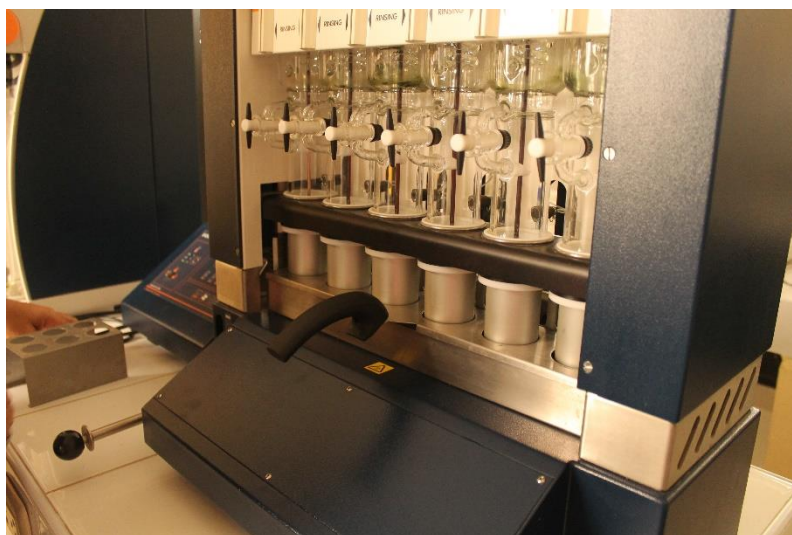
Figura 9: Determinación del contenido de aceite en la pulpa de palta por el método Soxhlet
