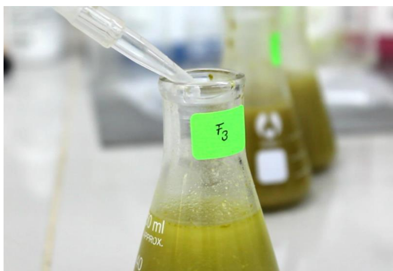
Figura 14: Determinación de la acidez en pulpa de palta por titulación con NaOH 0.1N
