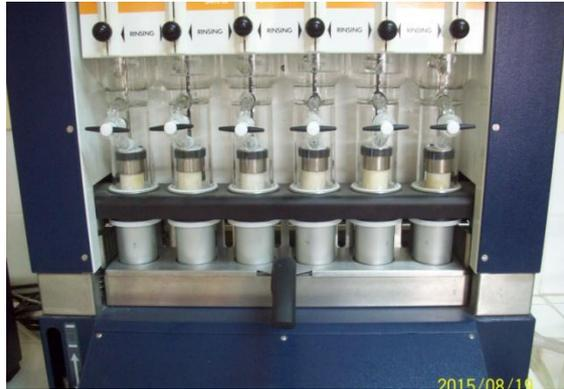
*Figura 19: Extracción de grasa en el equipo Soxtec Foss*
