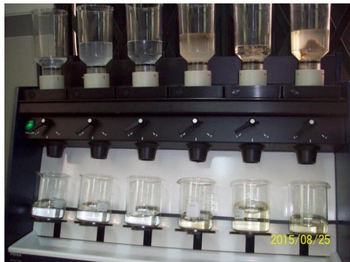
Figura 21: Determinación de Fibra mediante método enzimático – químico
