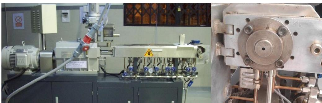
Figura 32: Extrusor de doble tornillo modelo DRX-50 y boquilla de 0.6 mm
