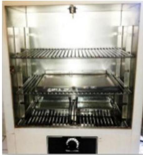
*Figura 18: Análisis de Humedad por método de la estufa*
