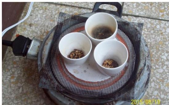
*Figura 20: Incineración para determinación de Ceniza*
