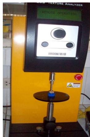
*Figura 38: Medición de textura instrumental mediante el texturómetro Brookfield CT3*
