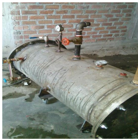
Instalación de los instrumentos del caldero pirotubular para pruebas preliminares.
