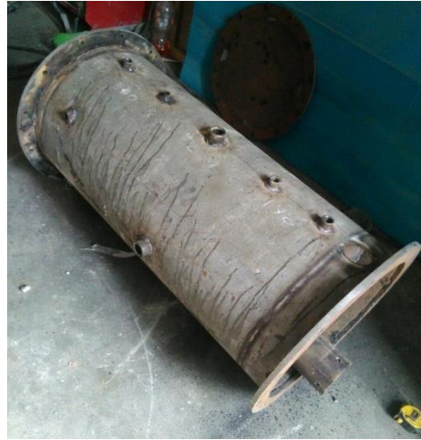
Vista de la Construcción de las entradas del cuerpo del caldero pirotubular
