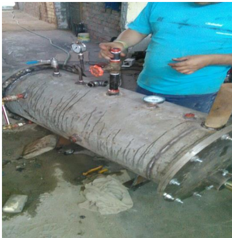
Instalación de los instrumentos del caldero pirotubular para pruebas preliminares.
