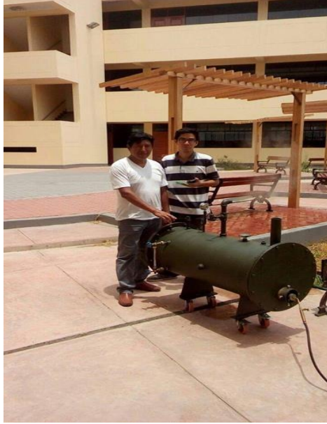
Prueba y toma de datos del caldero pirotubular de 6 BHP
