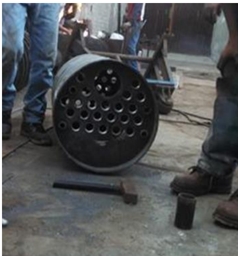
Vista de la Construcción de los espejos del cuerpo del caldero pirotubular
