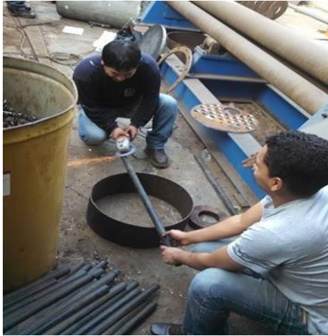
Preparación de los materiales para la caldera y rolado de la plancha del cuerpo principal.
