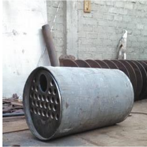
Preparación de los materiales para la caldera y rolado de la plancha del cuerpo principal.
