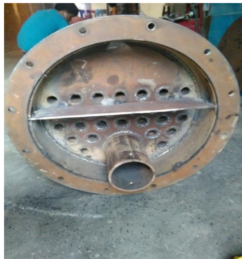
Vista de la Construcción de los espejos del cuerpo del caldero pirotubular
