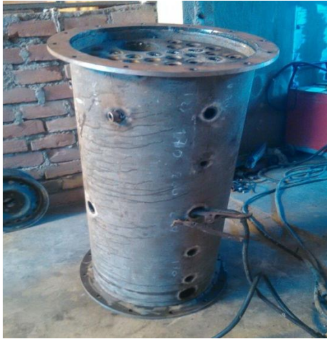
Vista de la Construcción de las entradas del cuerpo del caldero pirotubular
