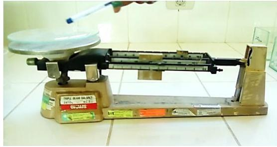
**Figura 41:** Balanza de triple brazo
