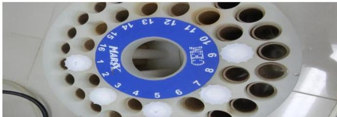
**Figura 70:** Tubos de digestión en el microondas
