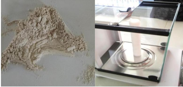
**Figura 68:** tamizado y pesado del  $\text{CaCO}_3$
