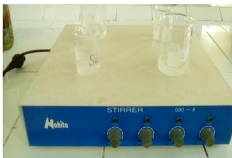
**Figura 37:** Agitador magnético
