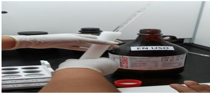
**Figura 69:** adición de ácido nítrico en tubos de digestión
