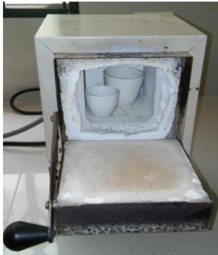
**Figura 73:** Determinación de cenizas en cáscara de huevo
