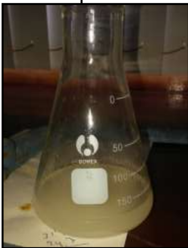
Se agita durante 1 minuto, se agrega Agua Destilada y al titular llega a una coloración amarilla pajizo
