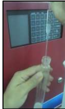
Se separa la fase superior y se procede a colocar en un vial para su análisis en cromatografía
