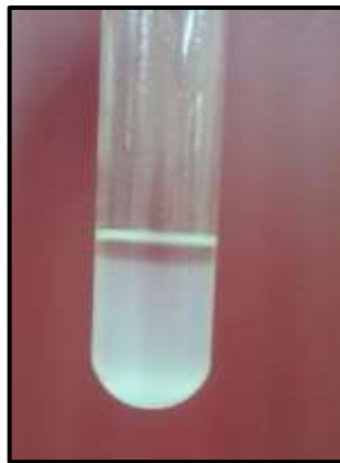
Obtención de las dos fases después de agregar Isooctano y \text{NaCl}
