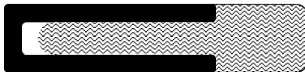
Figura 13. Sistema sólido-líquido. Evolución de la deformación relajación y HDM en un poro ideal (Fito et al., 1996 citado por Torres, 2007).
