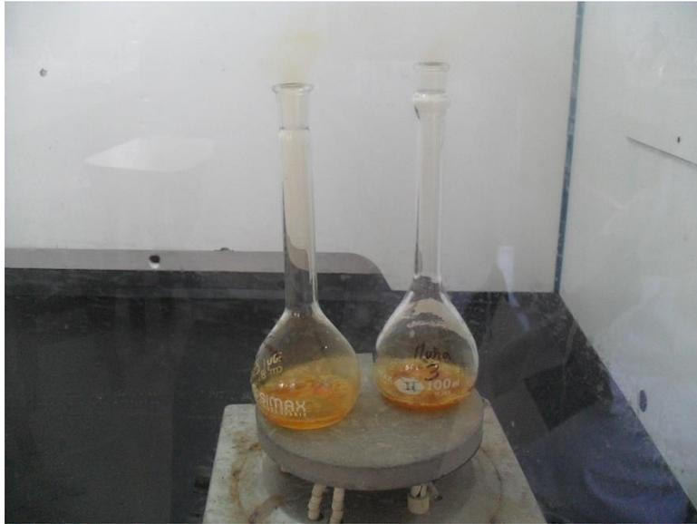
**Figura N° 13:** Digestión química de las muestras en la plancha eléctrica.
