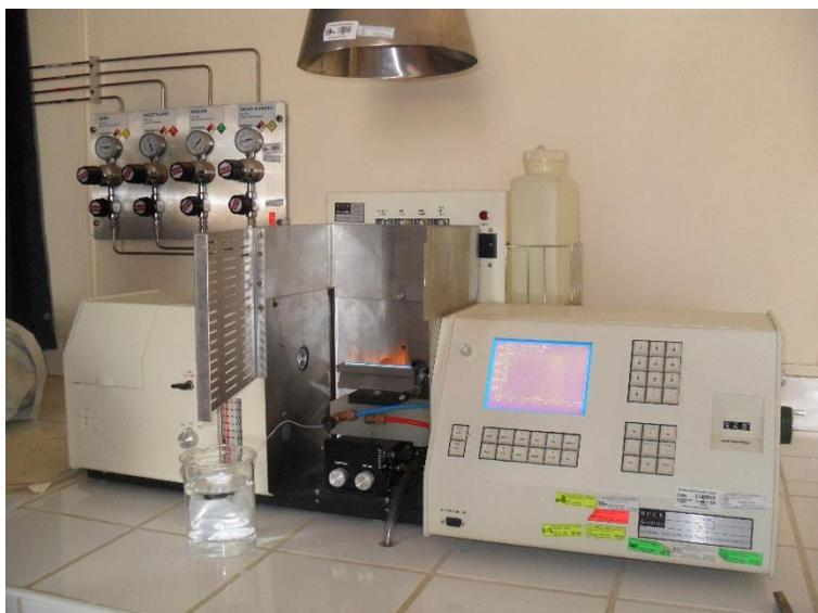
**Figura N° 18: Espectrofotómetro de Absorción Atómica Buck Scientific VGA 210.**
