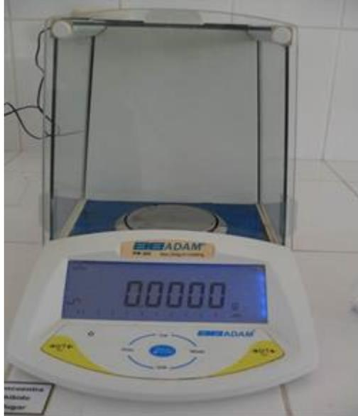
**Figura N° 9:** Calibración de la balanza analítica a cero.
