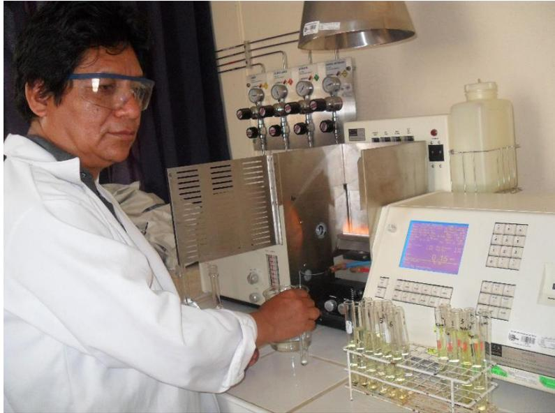
**Figura N° 19:** Lectura de Hierro y Cobre en el espectrofotómetro Absorción Atómica Buck Scientific VGA 210.
