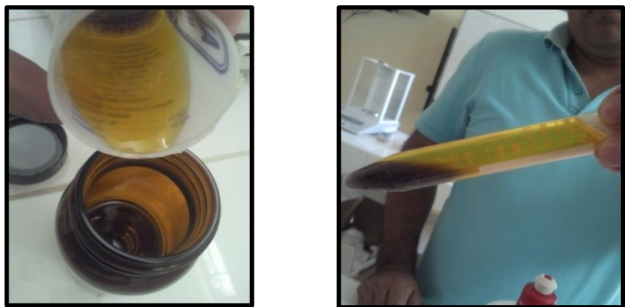
Figura 40: Centrifugación de aceite de semilla de granada
