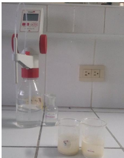
Figura A- 6: Determinación de Índice de Acidez
