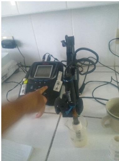
Figura A- 7: Determinación de pH del alfajor
