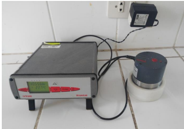
Figura A- 5: Determinación de la actividad de agua en el alfajor óptimo y control
