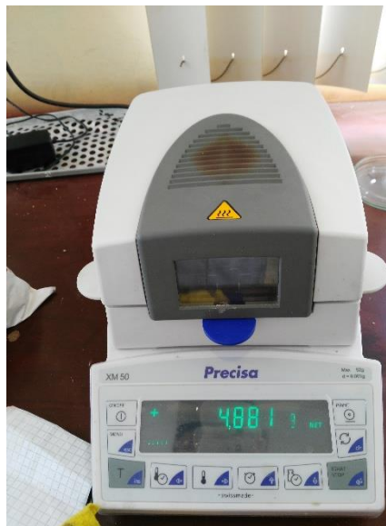
Figura A- 1: Determinación de la humedad en las harinas.
