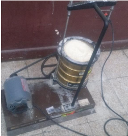
Figura 19: Tamizado de Harina de soya para la determinación de la granulometría
