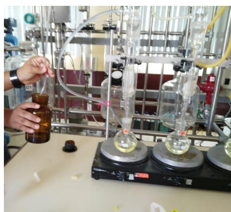
Figura A- 4: Determinación de Grasas por Soxhlet
