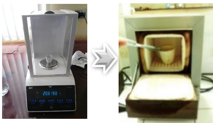
Figura A- 2: Determinación de Cenizas
