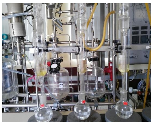
Evaporación-Condensación del Solvente
