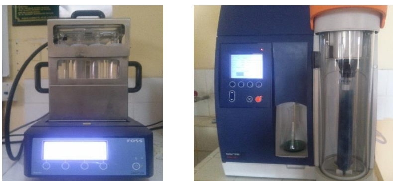
Figura: Determinación de proteínas por Kjeldahl.
