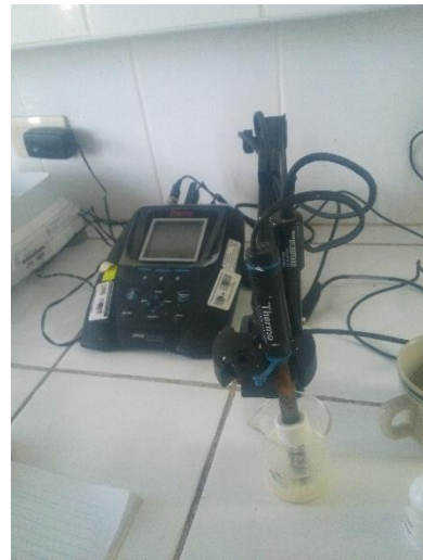
Figura A- 7: Determinación de pH del alfajor
