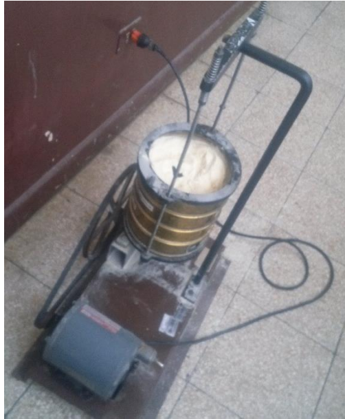
Figura 14: Tamizado de Harina de Camote para la determinación de la granulometría
