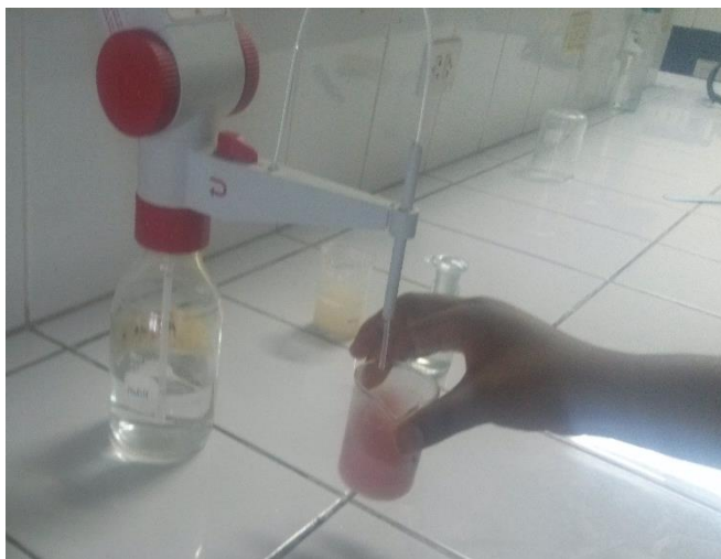
Figura A- 6: Determinación de Índice de Acidez
