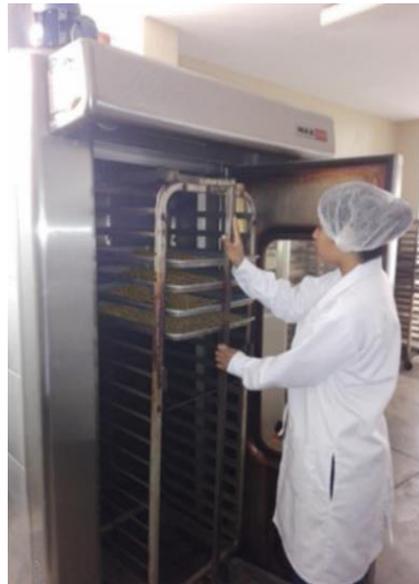
Figura 14: enfriamiento de las galletas tipo cookie
