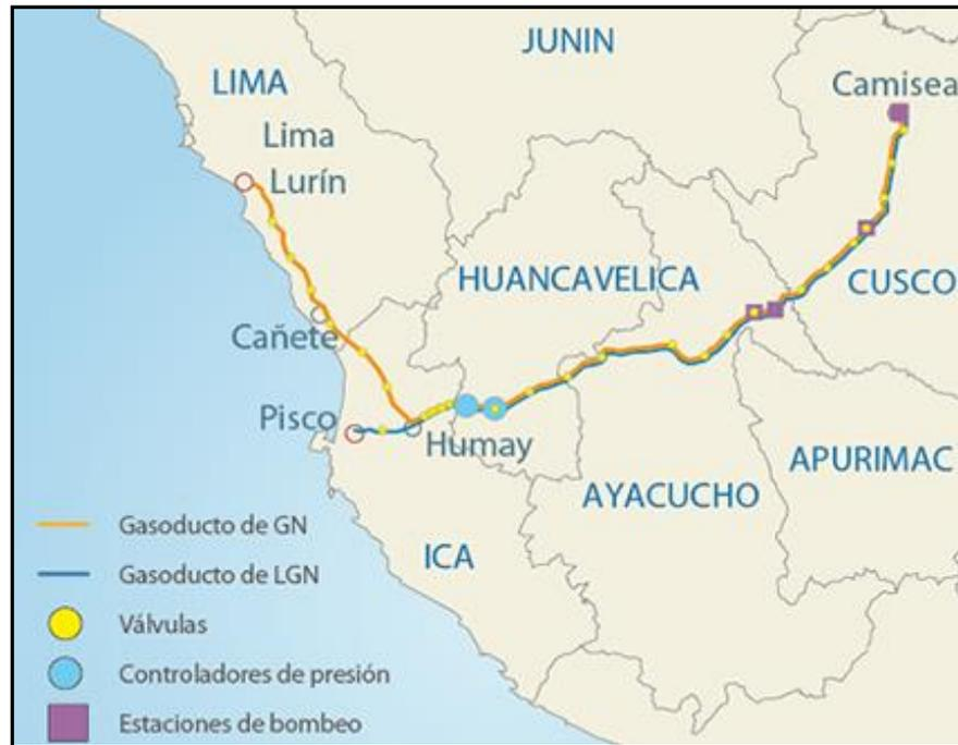
Fig. 2.7. Gaseoducto y poliducto de Camisea hacia Lima y Pisco.
