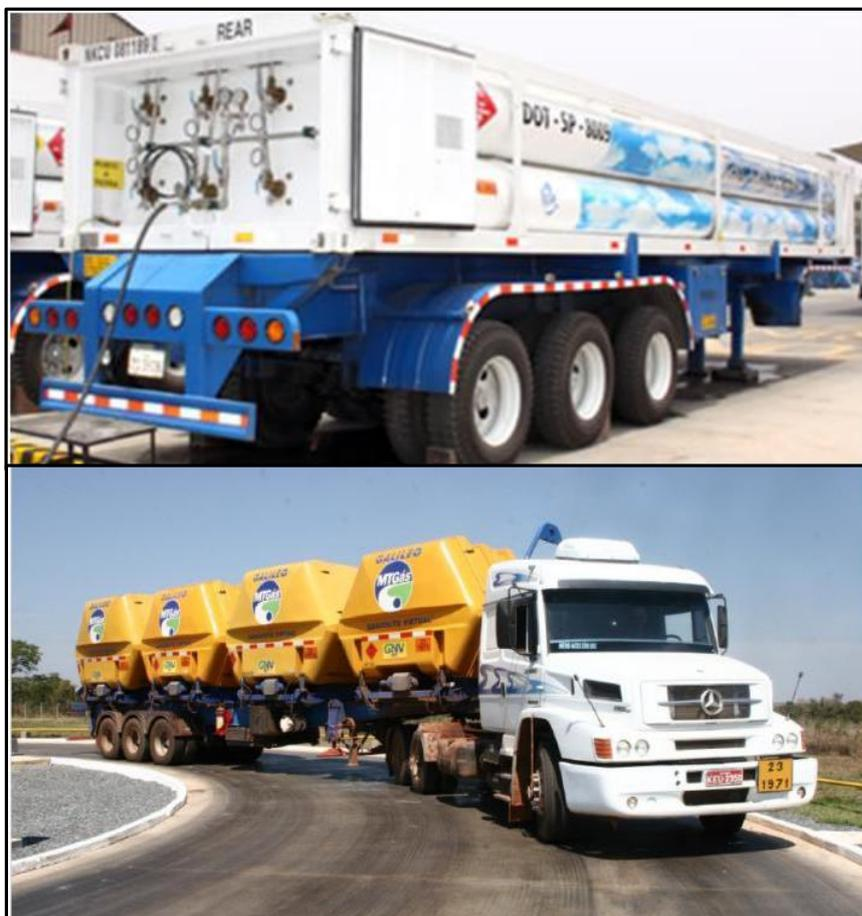
Fig. 2.22. Modelos de unidades semirremolques utilizados para el transporte de GNC, del tipo cilindros (arriba), del tipo modular (abajo).
