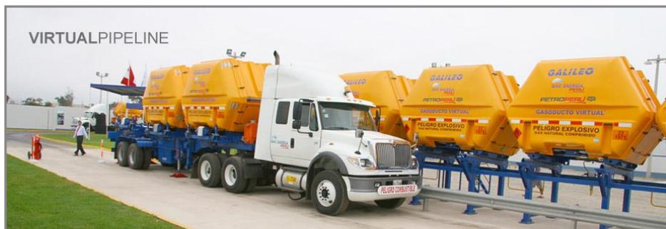
Fig. 4.5. Unidades semirremolques para transporte de MAT's de 1500 m<sup>3</sup> de GNC cada uno - GNC ENERGÍA PERU.
