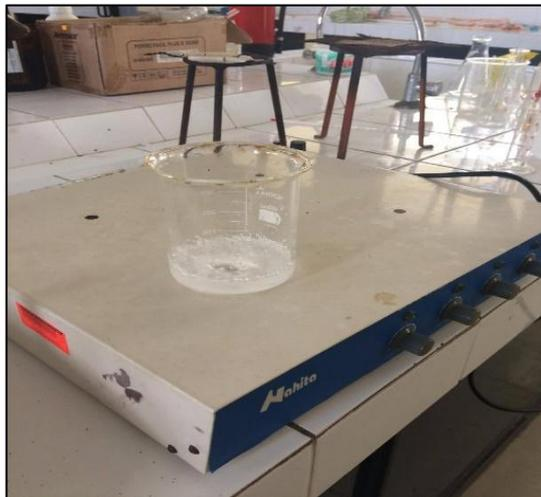
Se calentó el aceite a 60 °C. Se agregó el metóxido de sodio al aceite y se agitó. Se calentó y se agitó por 100 minutos.
