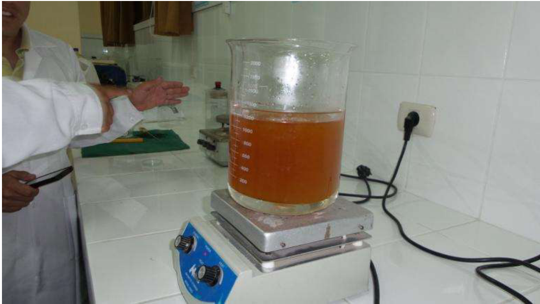
Fig. N° 5 Combinación del Metóxido de Sodio con el Aceite (grasa animal), manteniéndolo a 55 °c.
