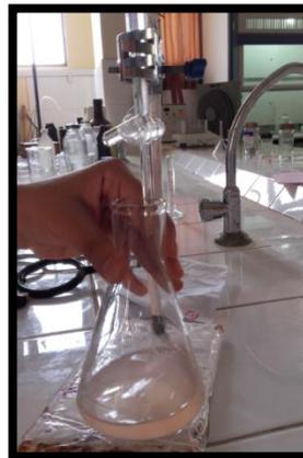
Titulación con sulfato de sodio hasta un color transparente.
