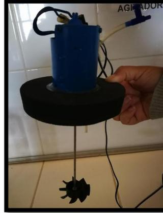
El contenedor empleado cumple con la función de mantener a el agua de sanguaza a las condiciones estables descritas en el diseño experimental, y brindarle mediante el agitador de turbina la velocidad necesaria (indicada también en el diseño experimental) para realizar la difusión de los agentes empleados, así mismo permitió realizar de forma adecuada el desarrollo de los ensayos programados, evaluando la variación de las variables propuestas (SST, Dureza Total y  $DBO_5$ )
