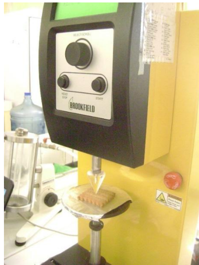
FIGURA A - 4: Determinación de textura de las galletas de cada formulación (incluido, formulación óptima y de control).
