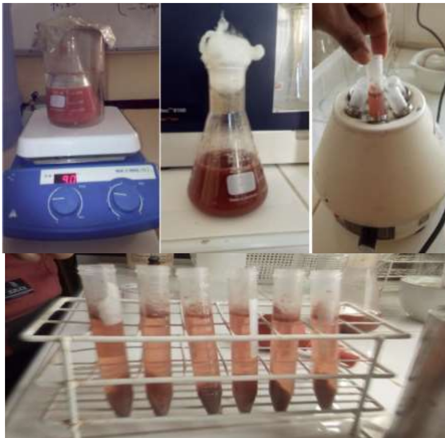
Figura 35: Proceso de hidrólisis - Centrifugación y separación de sólidos.
