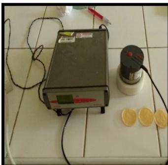
Figura 12: HIDROLAB, marca rotronic, modelo Aw – Dio
