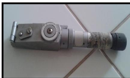
Figura 13: Refractómetro modelo N-1E, rango escalar de: 0,0 a 32°brix, escala mínima de 0,5.
