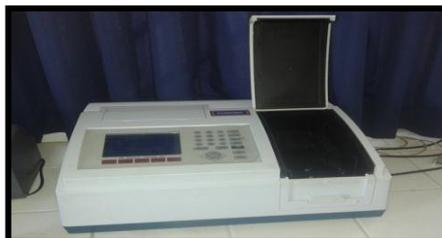
Figura 8: Espectrofotómetro Uv, Marca Turner – Barnstead International, Modelo N°:SM110250-33
