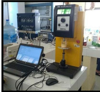
Figura 15: Texturometro Marca BROOKFIELD, modelo BKTACTPRO, USA.
