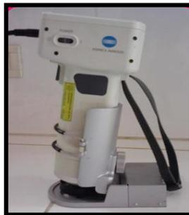
Figura 11: Colorímetro Chroma Meter: Marca Konica Minolta Modelo Cr – 400, Japan
