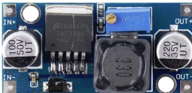
**Figura N° 24** Fuente de alimentación con el LM 2596.
