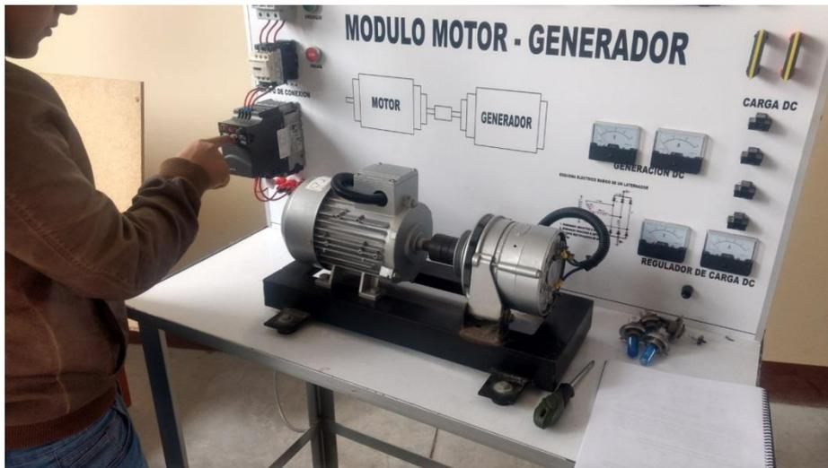
**Figura N° 30** Prueba del módulo Motor-Generador variando la frecuencia en el variador
