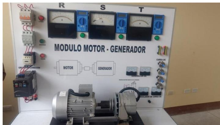
**Figura N° 28** Modulo Motor-Generador con variador
