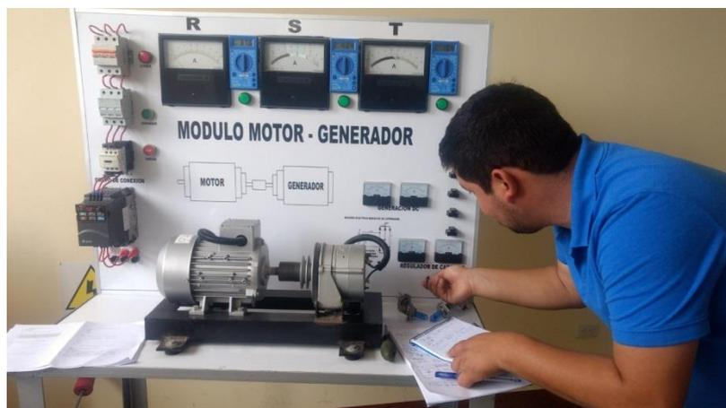
**Figura N° 29** Prueba del módulo Motor-Generador variando la excitación
