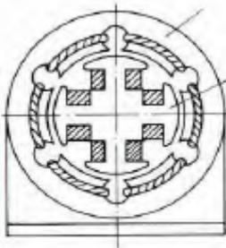
**Figura N° 9** Bobina de corriente Alterna.
