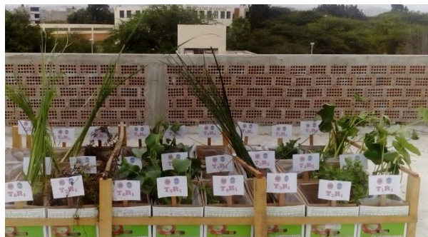
Fig. 4: Exposición de macrofitas al agua contaminada
