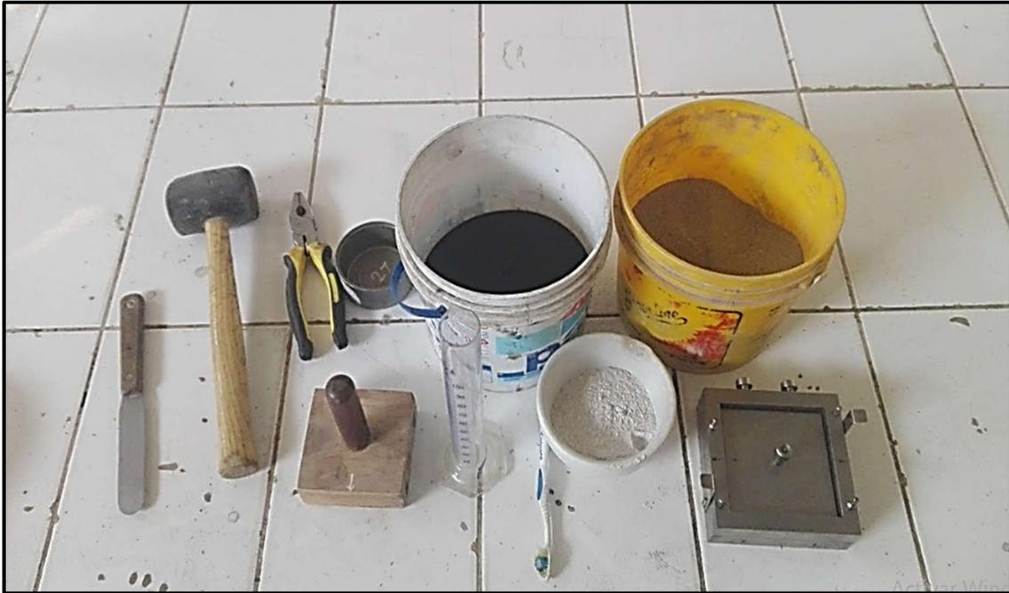
**Fotografía N°23:** Herramientas y materiales utilizados para la realización del ensayo de corte directo
