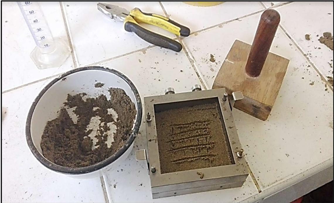
**Fotografía N°25:** Compactación de la muestra dentro de la caja de corte con ayuda de un pisón.
