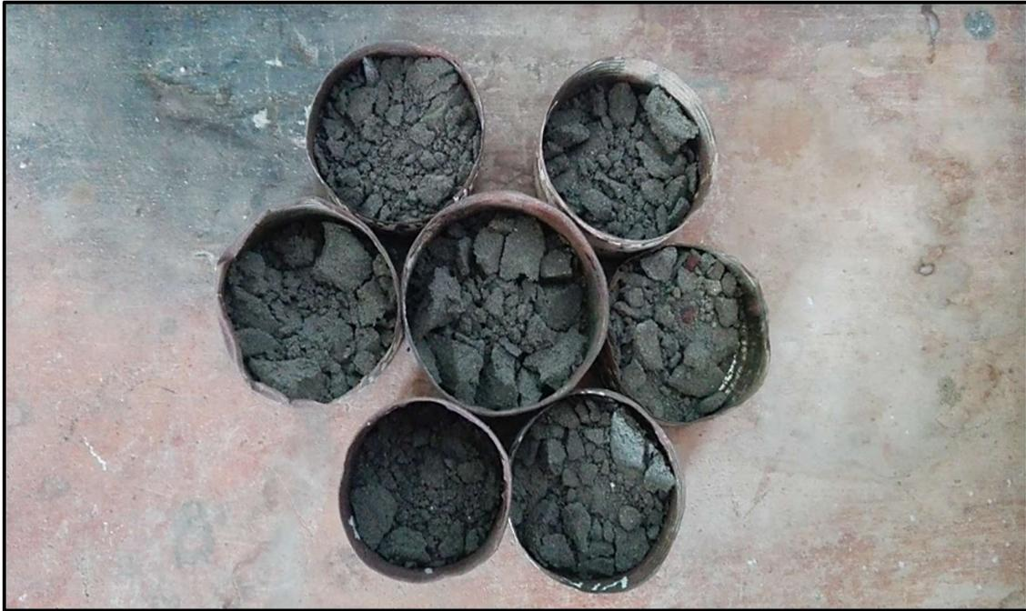
**Fotografía N°21:** Muestras secas luego del proceso de compactación
