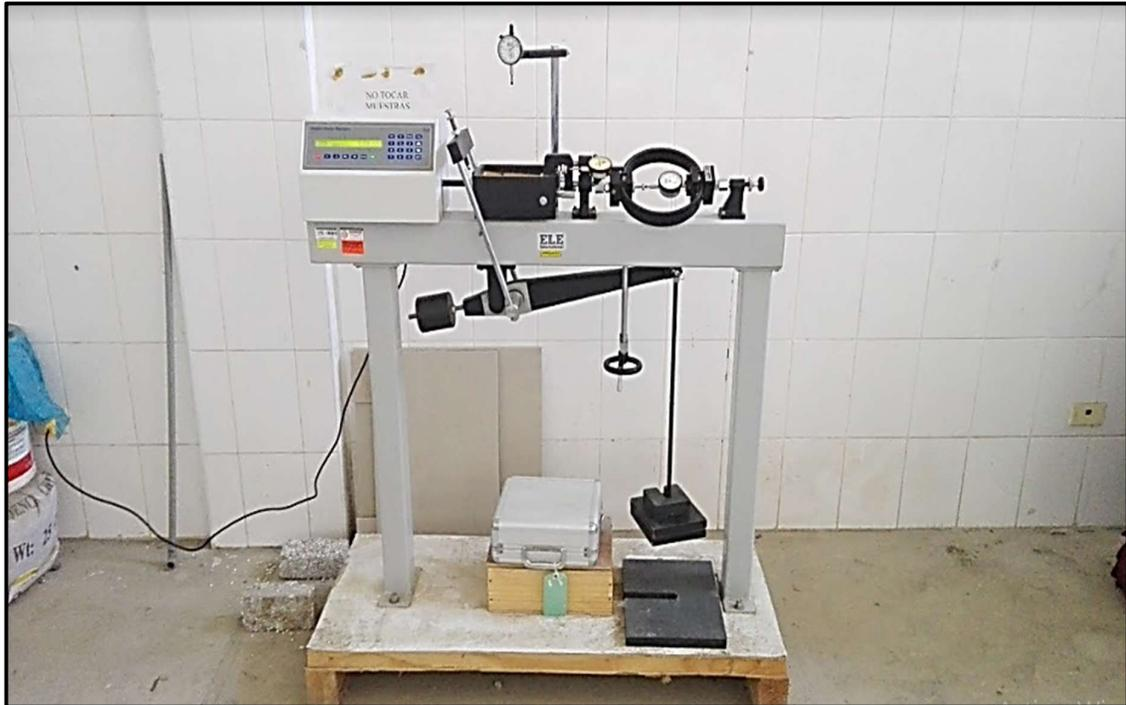
**Fotografía N°22:** Máquina para la realización del ensayo de corte directo consolidado drenado (MTC E123).
