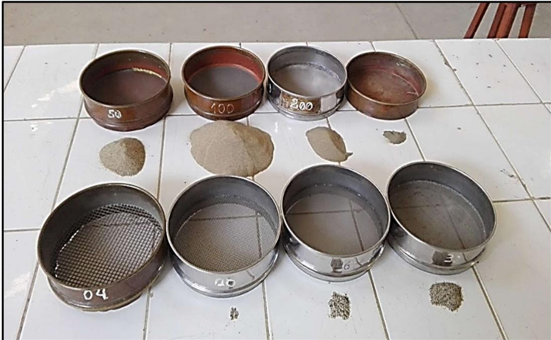
**Fotografía N°09:** Distribución granulométrica de una muestra de suelo arenoso.
