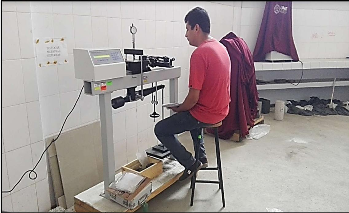
**Fotografía N°27:** Ejecución del ensayo de corte directo, registrando los desplazamientos horizontales y fuerzas cortantes.
