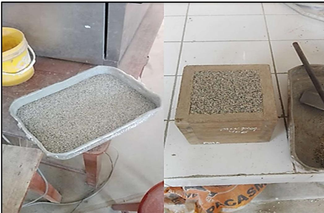
**Fotografía N°04:** Lavada, secado y obtención del peso específico de la arena calibrada.
