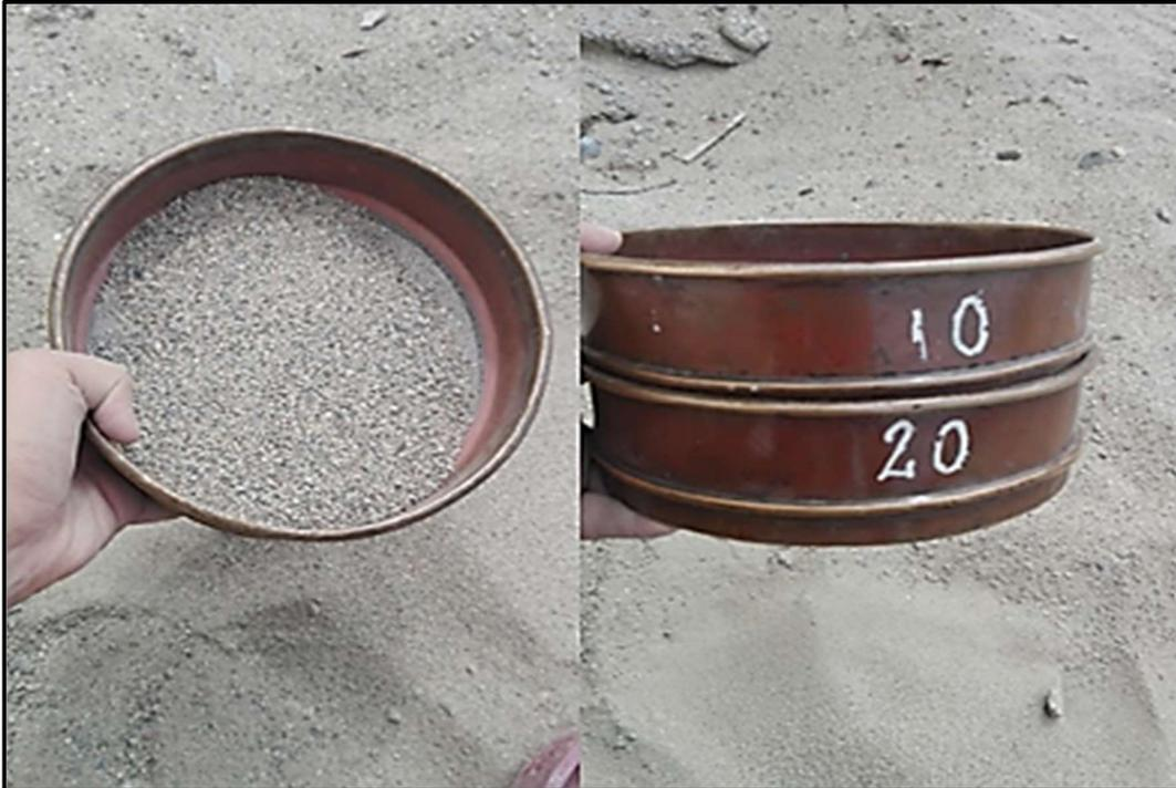
**Fotografía N°03:** Obtención de la arena calibrada (arena de Ottawa) para el ensayo de densidad de campo.
