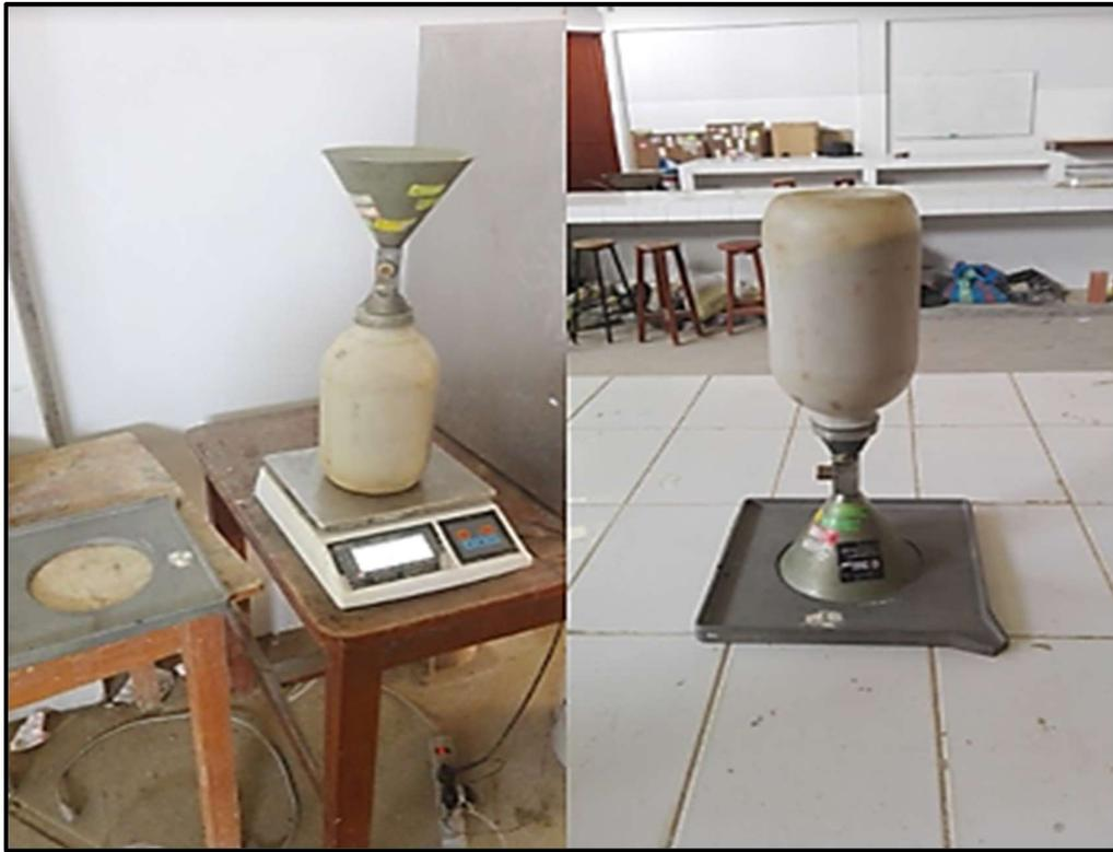
**Fotografía N°05:** Calibración del cono de densidad
