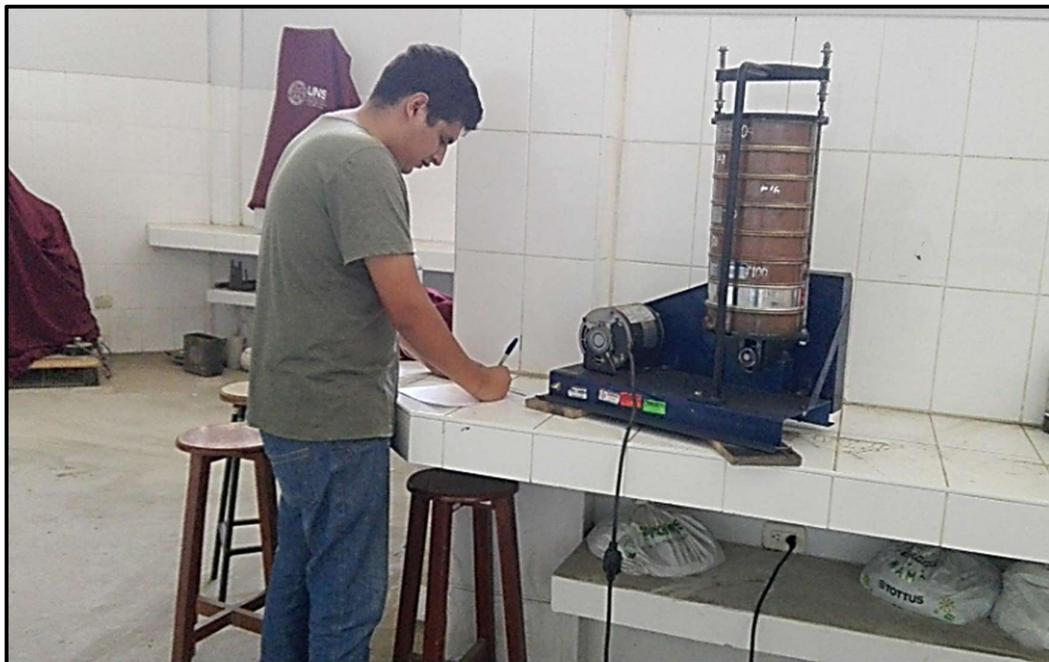
**Fotografía N°08:** Realización del análisis granulométrico de la muestra de suelo utilizando una tamizadora mecánica (MTC E107)
