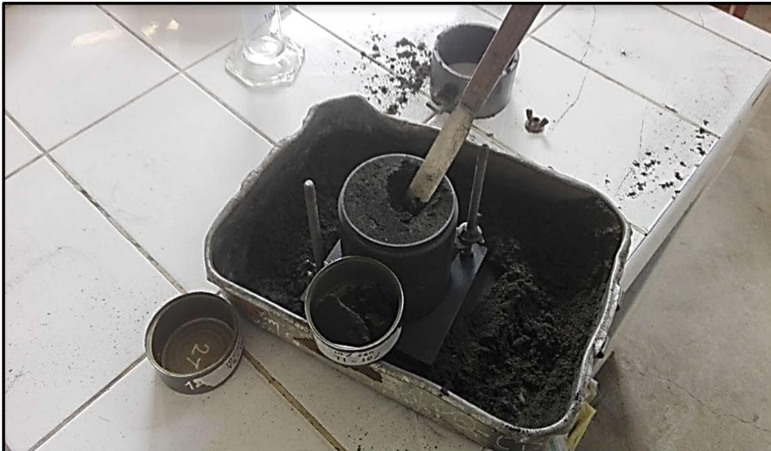
**Fotografía N°19:** Toma de muestras de la mezcla compactada para determinar su contenido de humedad.
