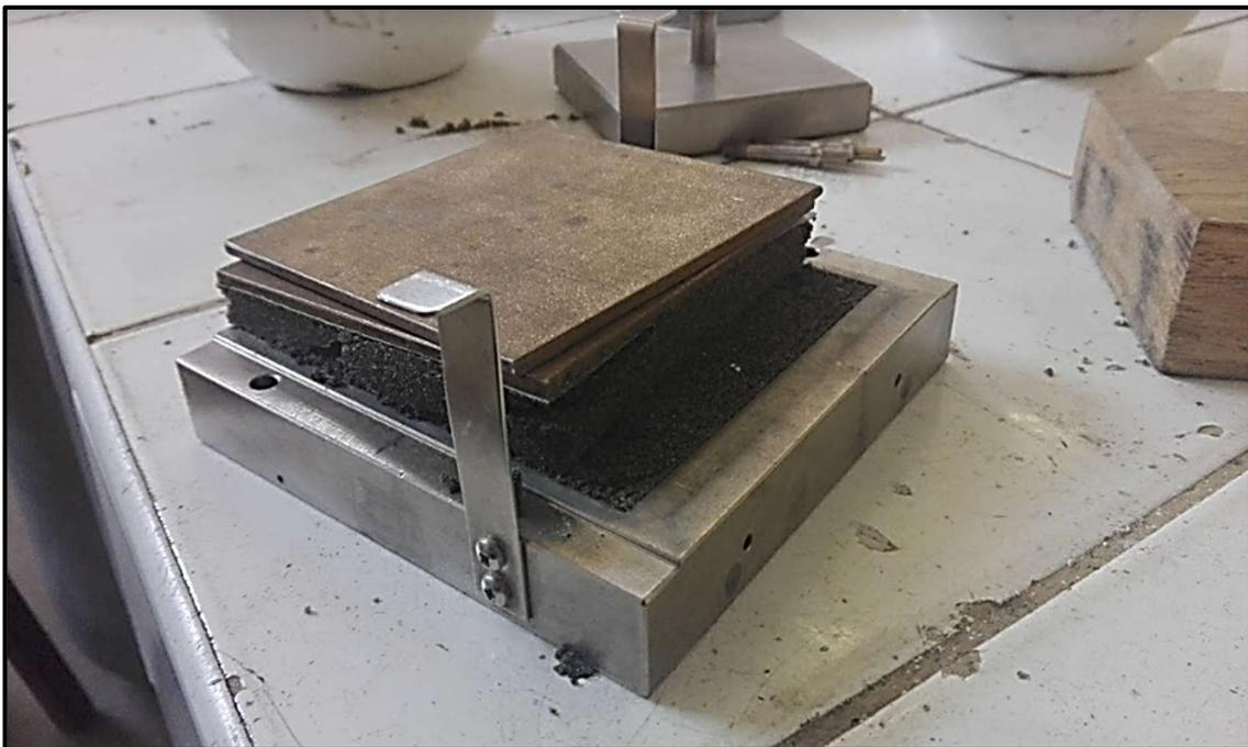
**Fotografía N°28:** Vista del corte de la muestra luego del ensayo de corte directo
