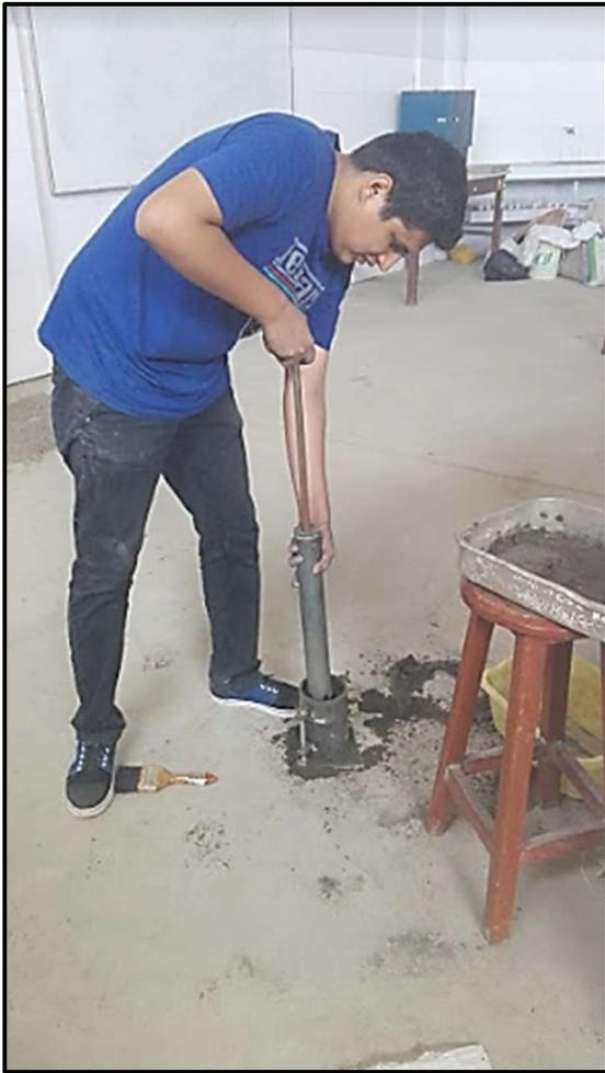
**Fotografía N°17:** Compactación de la mezcla en 3 capas de 25 golpes con pisón manual.
