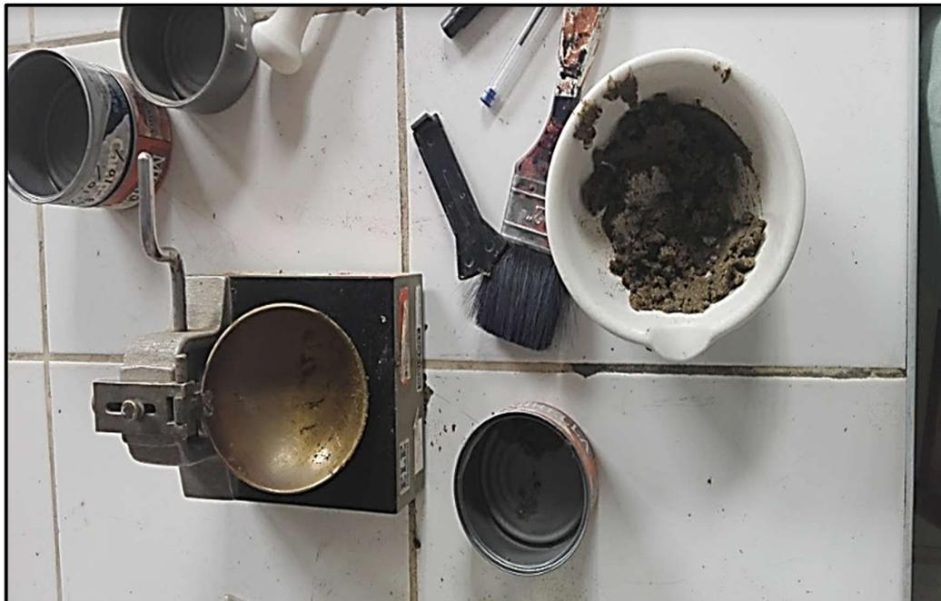
**Fotografía N°12:** Determinación del límite líquido (MTC E110) y límite plástico (MTC E111) de la muestra obtenida en la zona de estudio.
