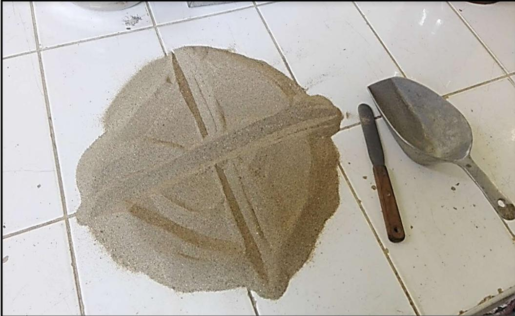
**Fotografía N°07:** Obtención en laboratorio de muestra representativa o conocido comúnmente como cuarteo (MTC E105)
