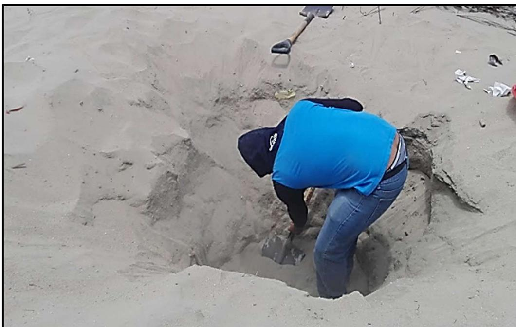
**Fotografía N°02:** Excavación y toma de muestra de suelo de la calicata C-02 en el Campus I de la UNS.
