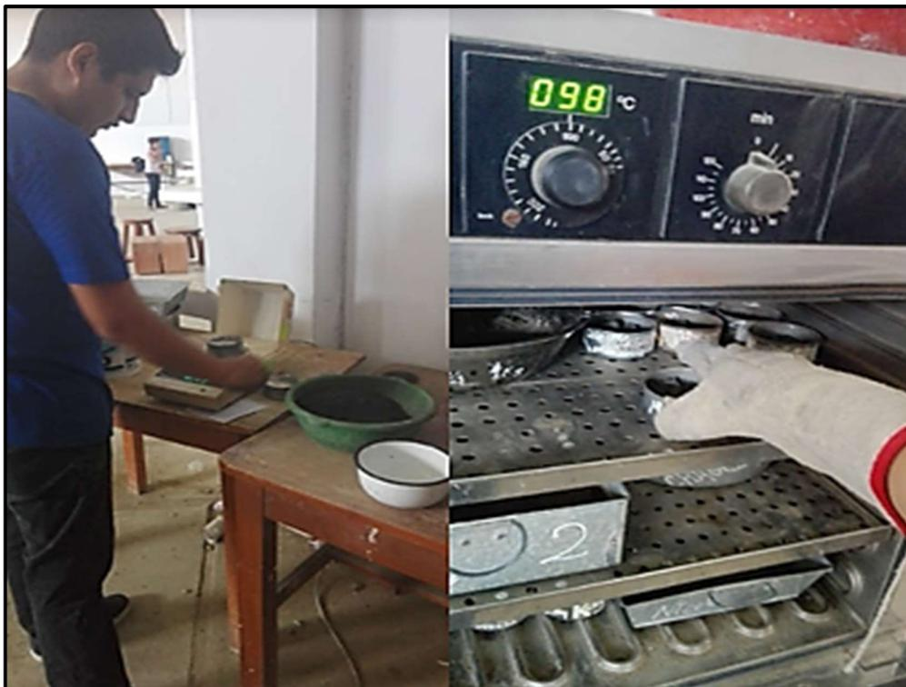
**Fotografía N°20:** Pesaje de las taras con muestras húmedas y luego puestas en el horno eléctrico.
