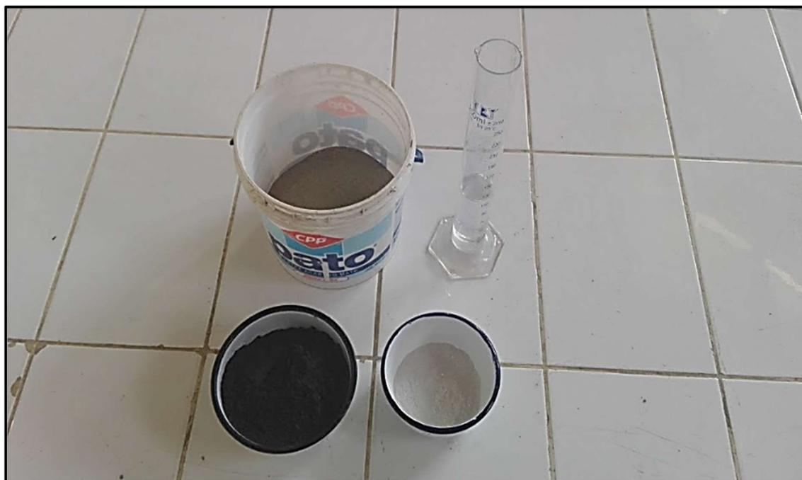
**Fotografía N°14:** Materiales utilizados en el ensayo Proctor: suelo arenoso, cal, ceniza de hojas de caña de azúcar y agua.
