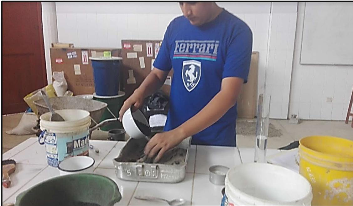
**Fotografía N°15:** Preparación de un tipo de mezcla de suelo con cal y ceniza de hojas de caña de azúcar.
