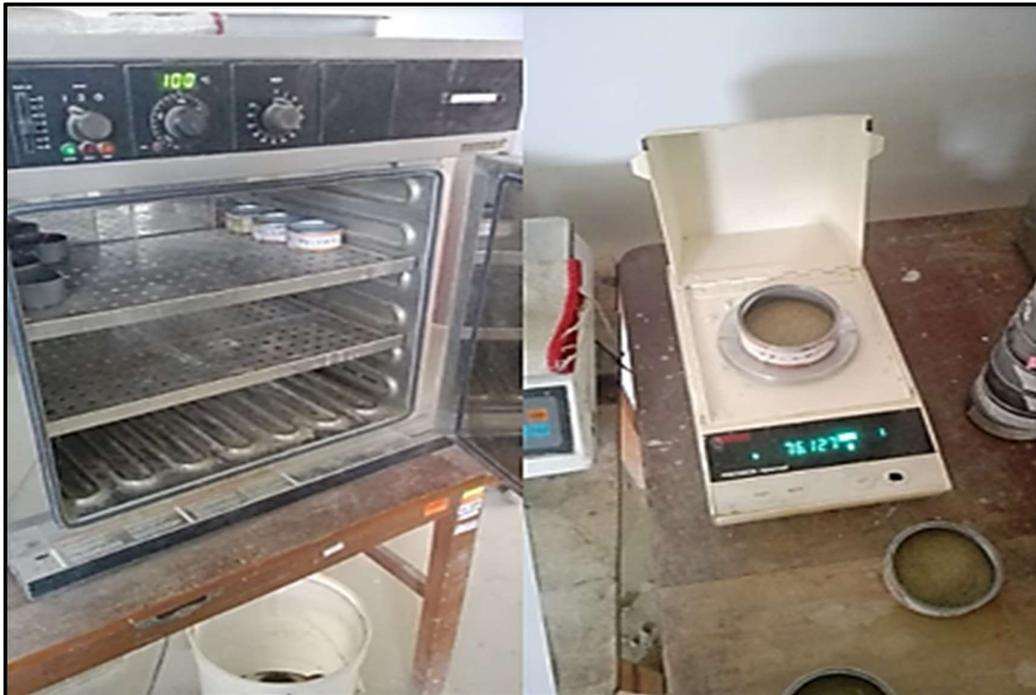
**Fotografía N°11:** Muestra de suelo puesta en el horno eléctrico y posterior pesaje de las mismas para la determinación del contenido de humedad.
