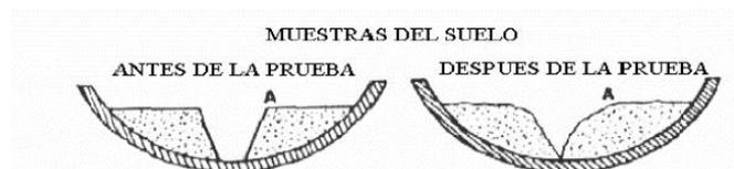
Figura 2.9. Muestras de suelo antes y después de la prueba. Manual de Ensayos de Materiales. MTC, 2016, p. 69.
