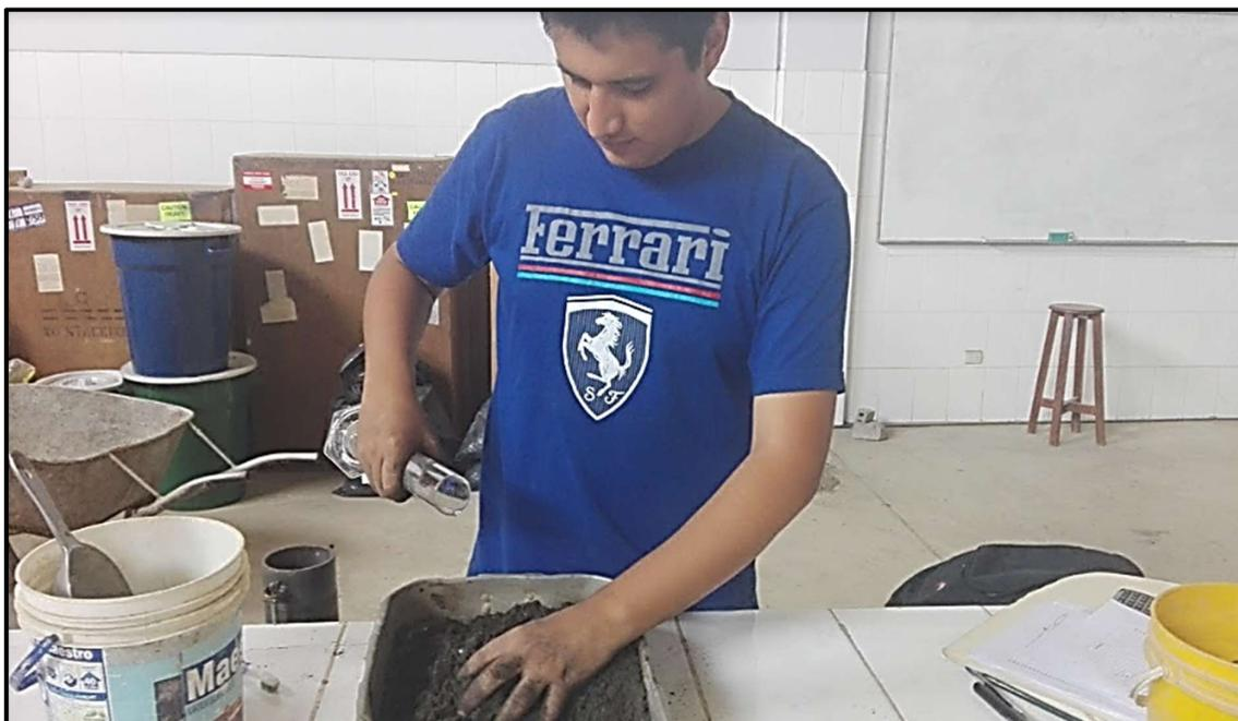
**Fotografía N°16:** Humedecimiento de la mezcla utilizando una determinada cantidad de agua, la cual se iba variando.
