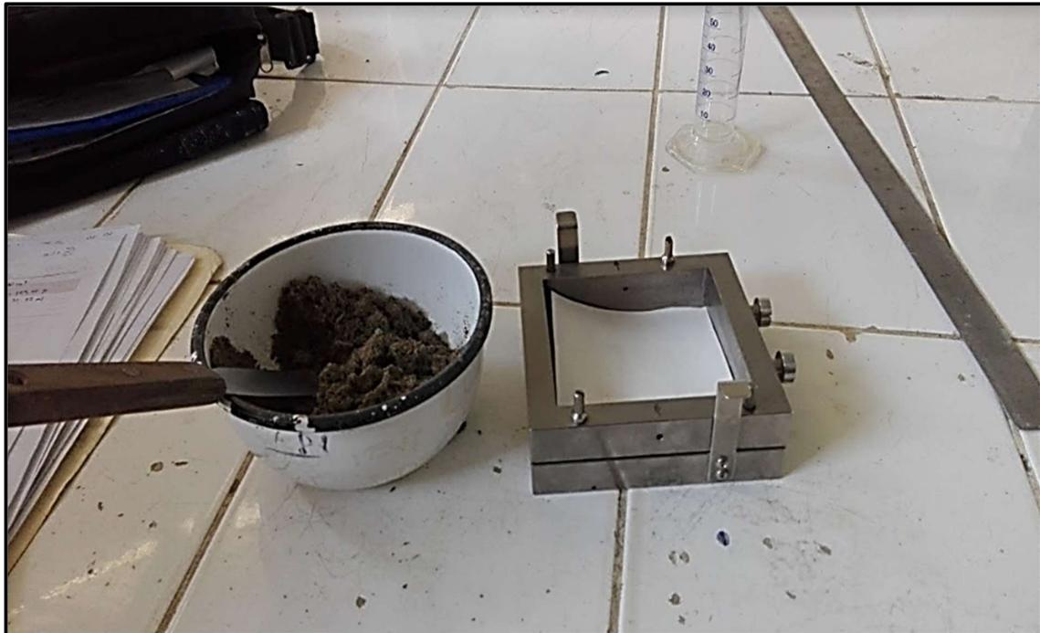
**Fotografía N°24:** Preparación de la muestra antes de ser colocada a la caja de corte directo
