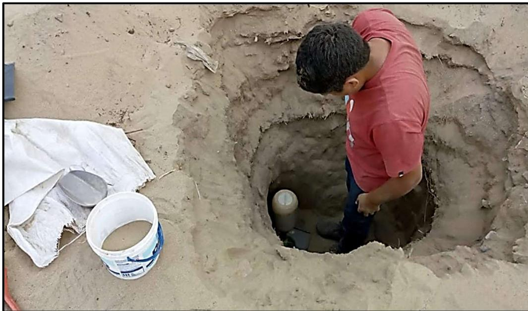
**Fotografía N°06:** Realización del ensayo de densidad de campo insitu, a una profundidad de 1.50m (MTC E117)
