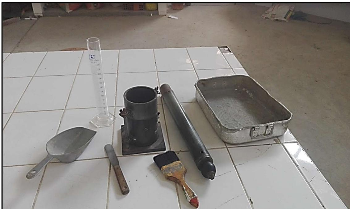
**Fotografía N°13:** Equipos y herramientas para la realización del ensayo Proctor Estándar (MTC E116).
