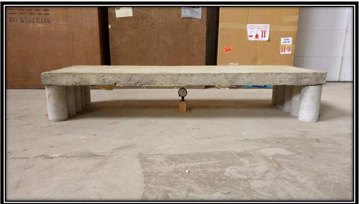
**FOTO 52:** Losa simplemente apoyada lista para recibir las cargas requeridas.
