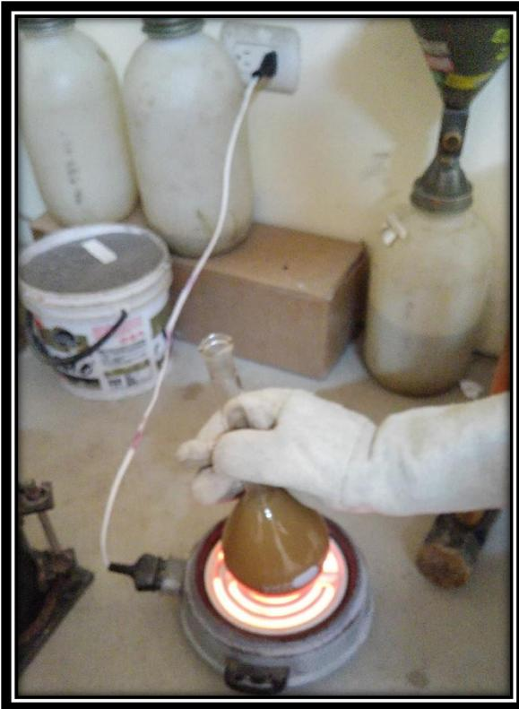
**FOTO 13:** Realización del calentamiento de la fiola para la eliminación de las burbujas formadas en el interior de la muestra.
