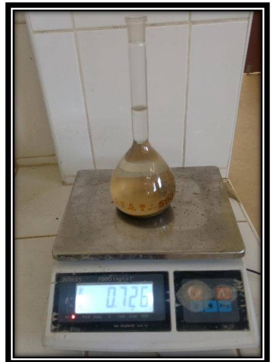
**FOTO 16:** Se determina el peso de la fiola más agua más muestra de agregado fino para hallar la densidad relativa del agregado fino.
