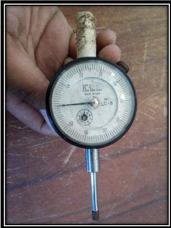
**FOTO 51:** difractómetro utilizado para ver las deformaciones de la losa.
