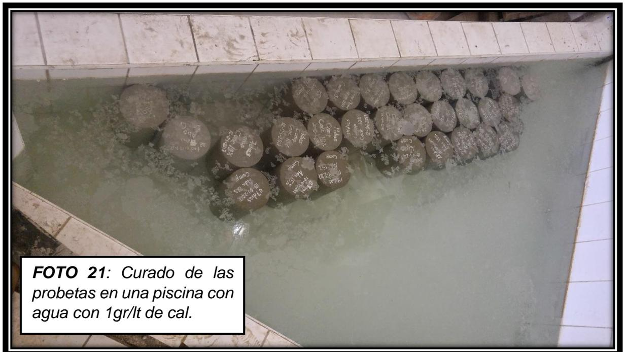
**FOTO 21:** Curado de las probetas en una piscina con agua con 1gr/lit de cal.
