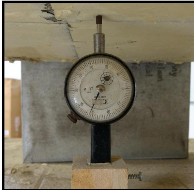
**Figura N° 4.2. Deformímetro en el Centro de la Luz**
