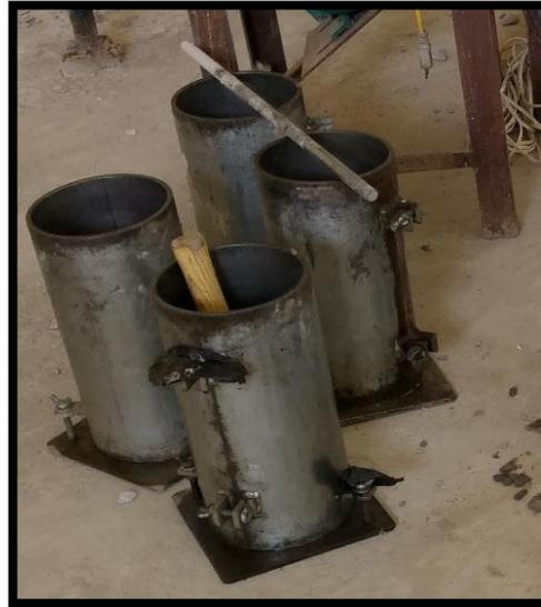
**Figura N° 3.6. Moldes Preparados para el Vertimiento de Concreto**
