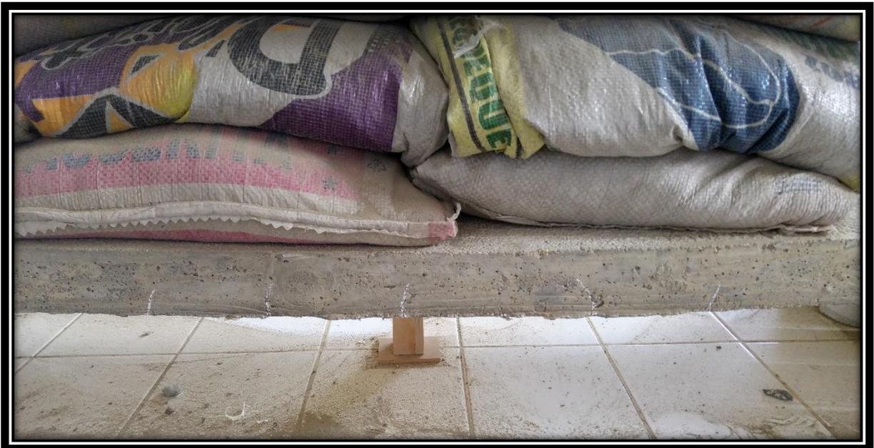
**FOTO 54:** Se observaron 5 fisuras que empezaron a aparecer luego de 24 horas de cargada con 1520 kg/m<sup>2</sup> .
