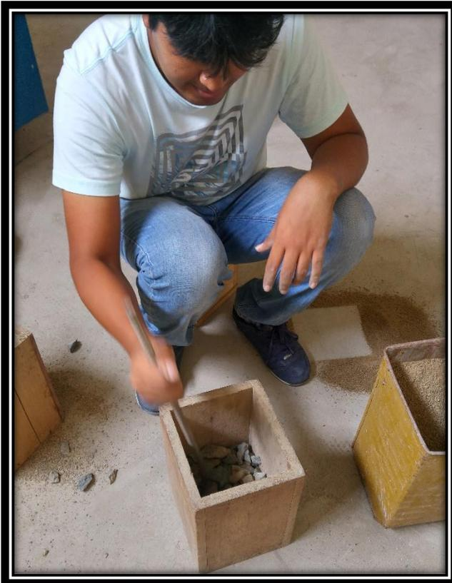
**FOTO 9:** Se realiza la compactación por capas del agregado grueso para determinar el peso unitario compactado.
