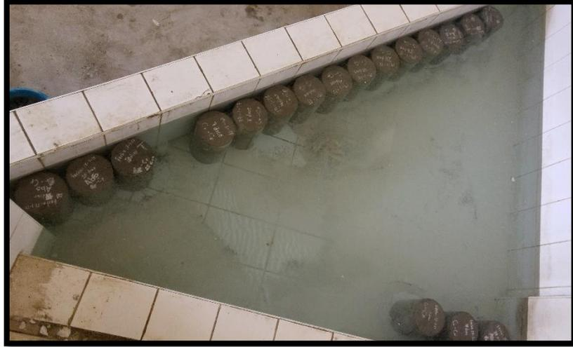
**Figura N° 3.8. Probetas Conservadas y Sumergidas en Agua**
