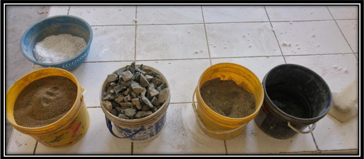
**FOTO 43:** Agregado grueso, agregado fino, cemento, agua y MEPS listos para ser mezclados.
