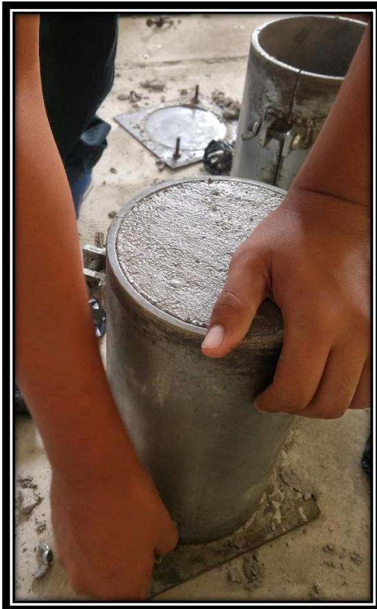
**FOTO 26:** Realizando el desmolde de las probetas con MEPS.
