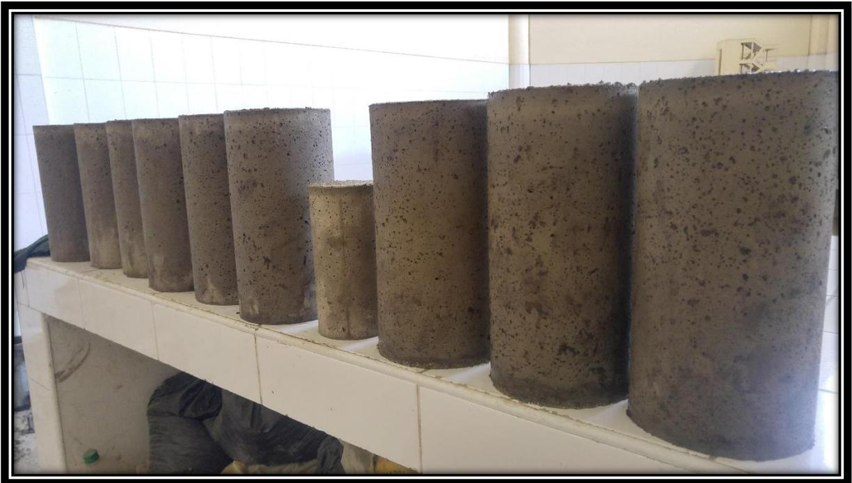
**FOTO 44:** Porosidad del concreto a la adicional mayor cantidad de MEPS en la mezcla.
