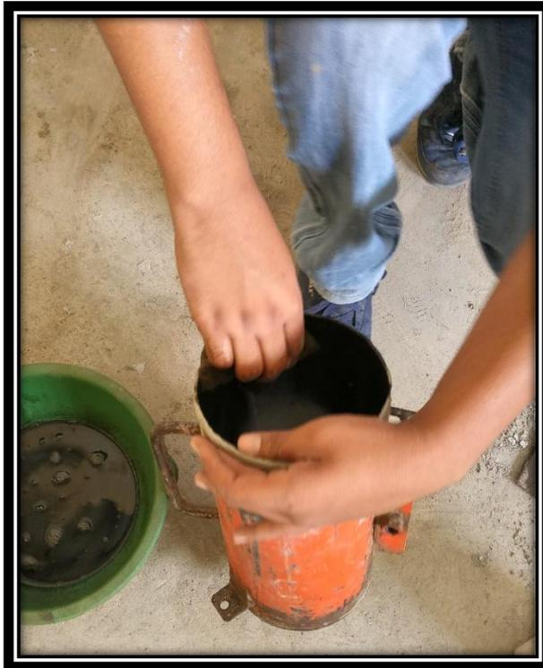
**FOTO 22:** Limpieza de los moldes y colocación de petróleo para evitar que los moldes se peguen al concreto.
