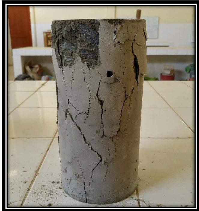
**FOTO 35:** Se presentan fisuras verticales a través de los cabezales, como no bien definido en el otro extremo.
