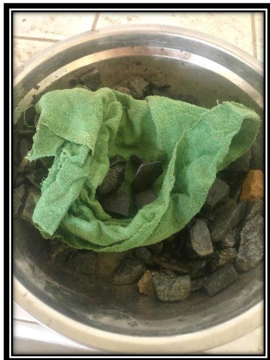
**FOTO 14:** Realización del secado del agregado grueso luego de ser saturados para el cálculo del peso saturado superficialmente seco.
