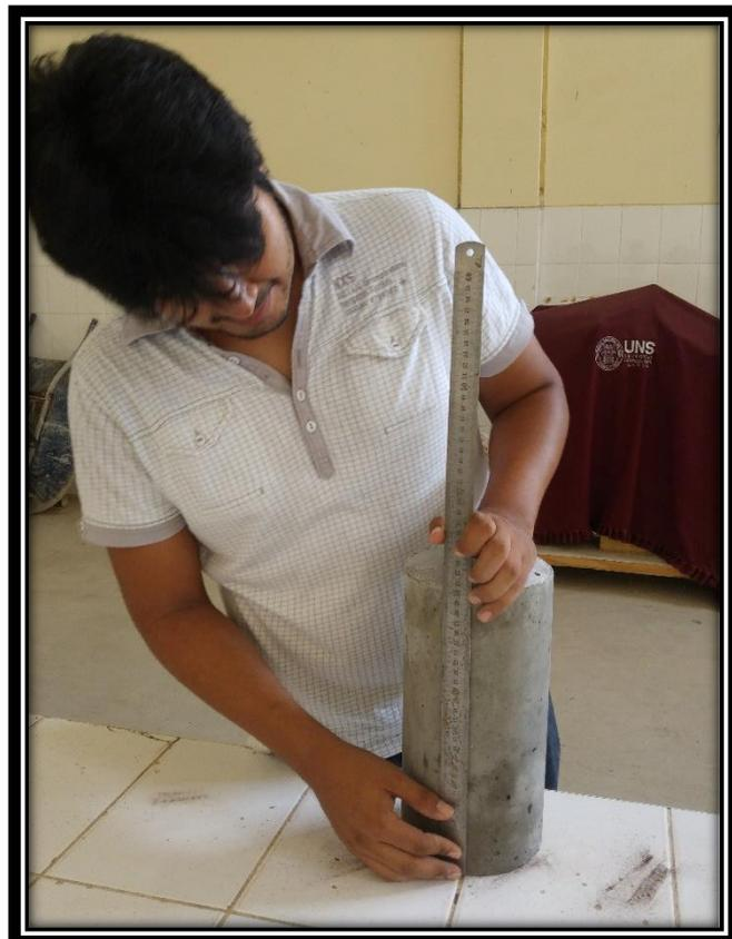
**FOTO 29:** *Medición de las probetas de su altura previa al ensayo de compresión del mismo.*
