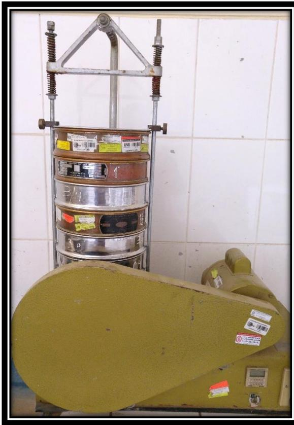
**FOTO 3:** Tamizador mecánico para el ensayo granulométrico tanto de los agregados como del MEPS.
