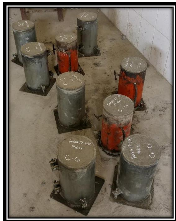
**FOTO 25:** Probetas de concreto con MEPS endurecidas luego de fraguar por 24 horas.
