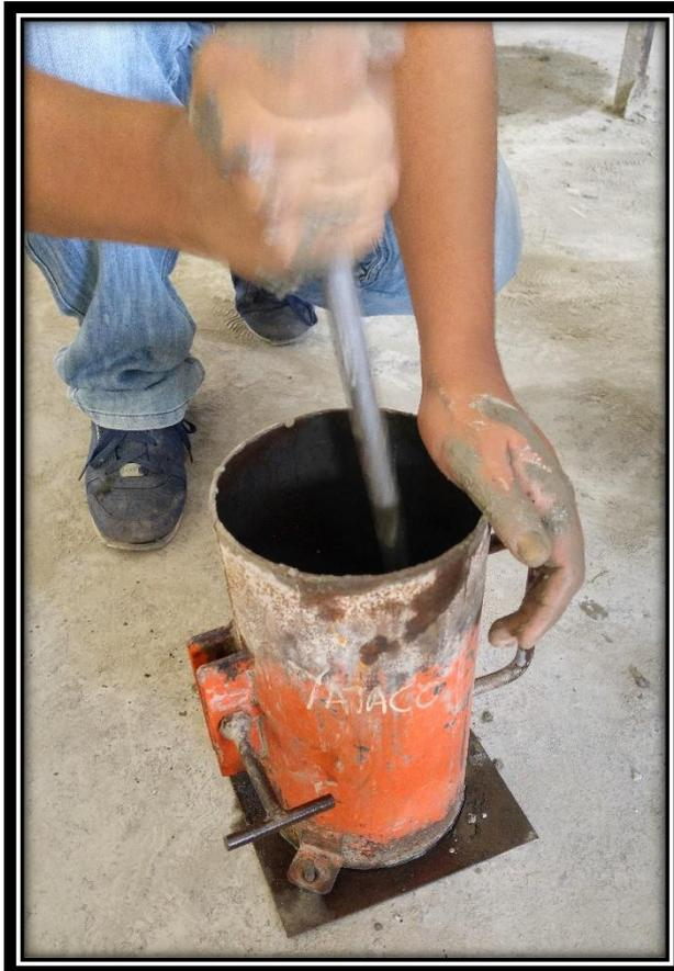
**FOTO 24:** Varillado del concreto con MEPS para eliminar las burbujas de aire atrapadas en el concreto mediante el vaciado.
