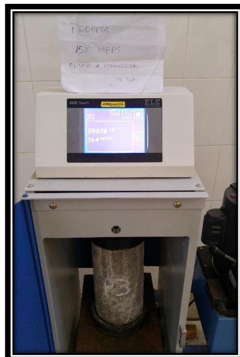
**FOTO 33:** Ensayo a compresión de las probetas con MEPS a los 28 días en el laboratorio de la UNS.
