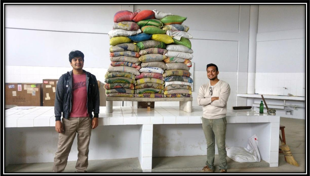
**FOTO 53:** Losa con carga distribuida en toda su área, hasta los 1520 kg/m<sup>2</sup> que se empezó a fisurar.
