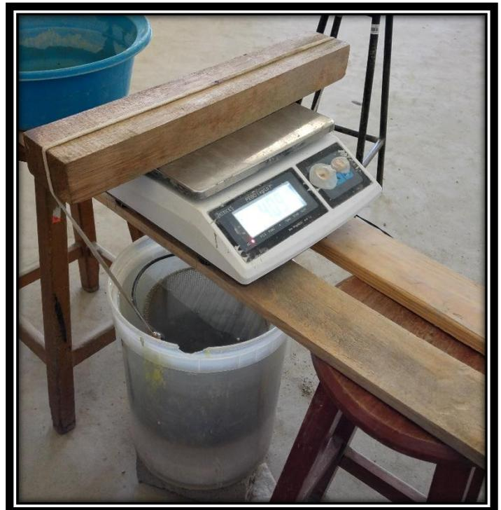
**FOTO 18:** Realizando el ensayo para determinar la densidad relativa del agregado grueso según la NTP 400.021
