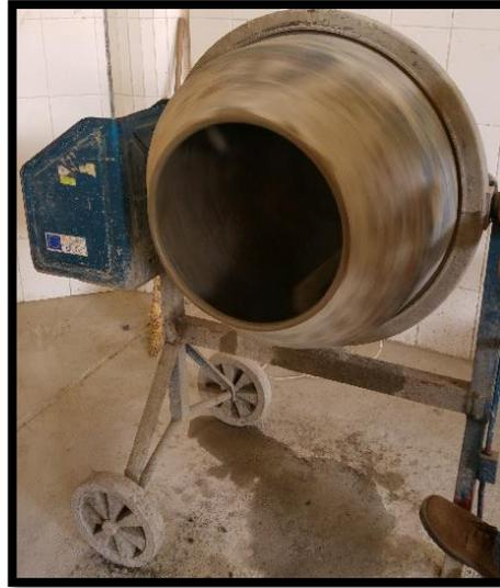
**Figura N° 3.5. Mezcladora de Concreto con MEPS**
