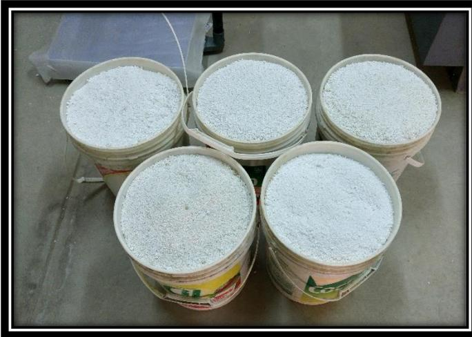
**FOTO 41:** MEPS listo para ser utilizado como adición en el concreto diseñado para una resistencia de  $210\text{kg/cm}^2$ .
