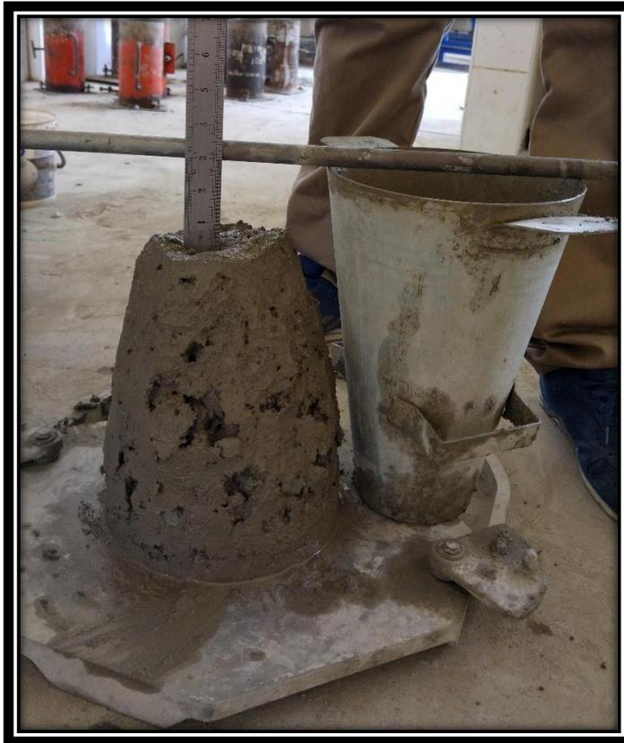
**FOTO 20:** Realizando la prueba del asentamiento del concreto fresco mediante el método del cono de abrams.
