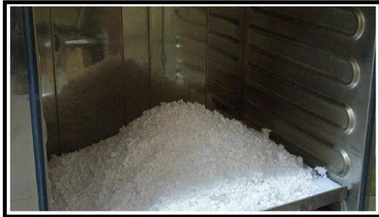
**Figura N° 2.12. Perlas de EPS Reciclado en el Horno antes de Tratamiento Térmico**
