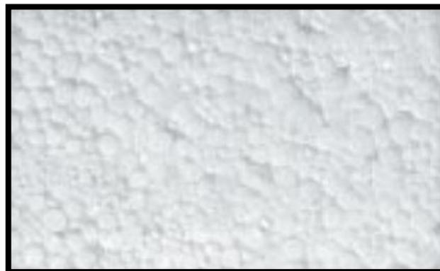
Figura N° 2.4. Poliestireno Expandido
