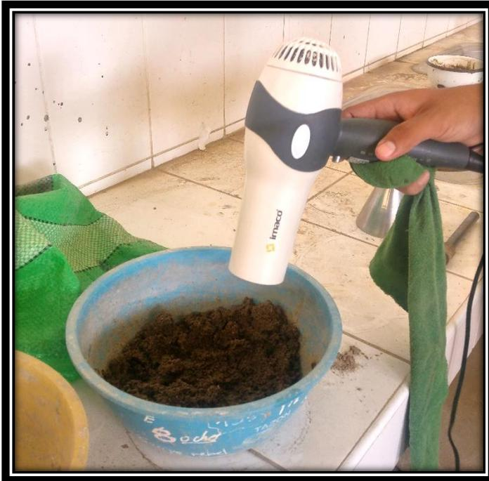
**FOTO 15:** Se realiza el secado de la muestra saturada del agregado fino mediante una secadora.
