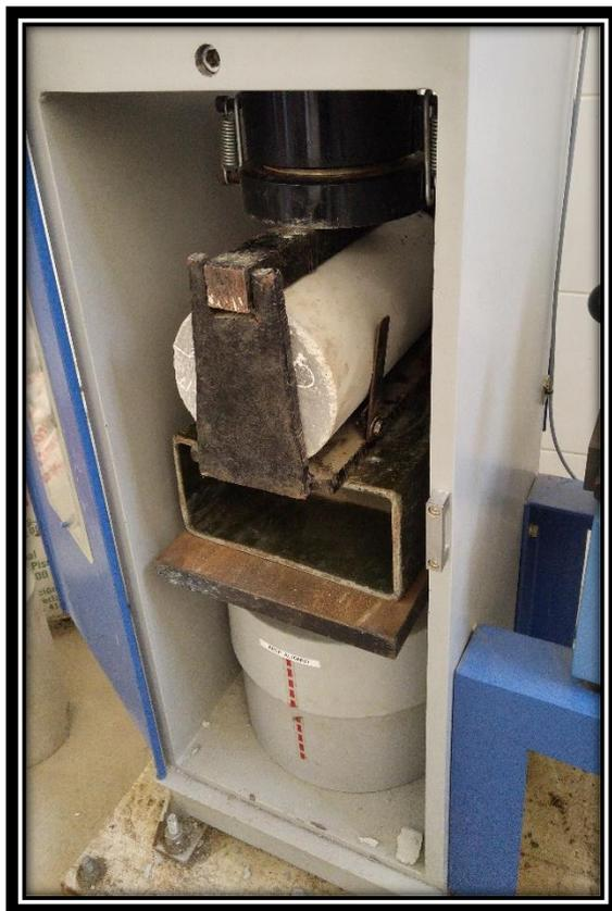
**FOTO 36:** Ensayo a la tracción de las probetas del concreto con MEPS a los 28 días.
