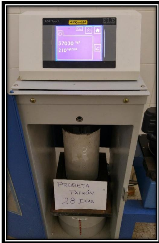
**FOTO 32:** Ensayo a la compresión de la probeta patrón a los 28 días en el laboratorio de la UNS.
