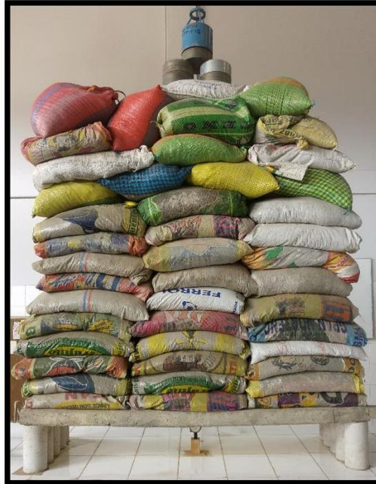
**Figura N° 4.3. Losa con Carga Máxima Impuesta**
