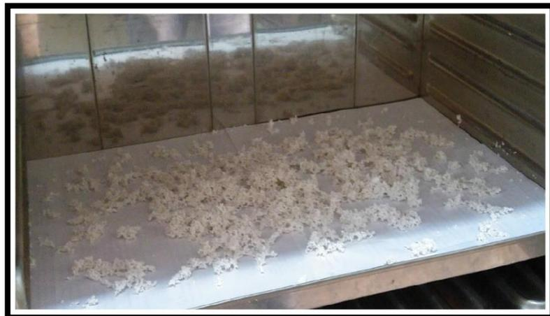
**Figura N° 2.13. Perlas de EPS Reciclado Luego del Tratamiento Térmico**
