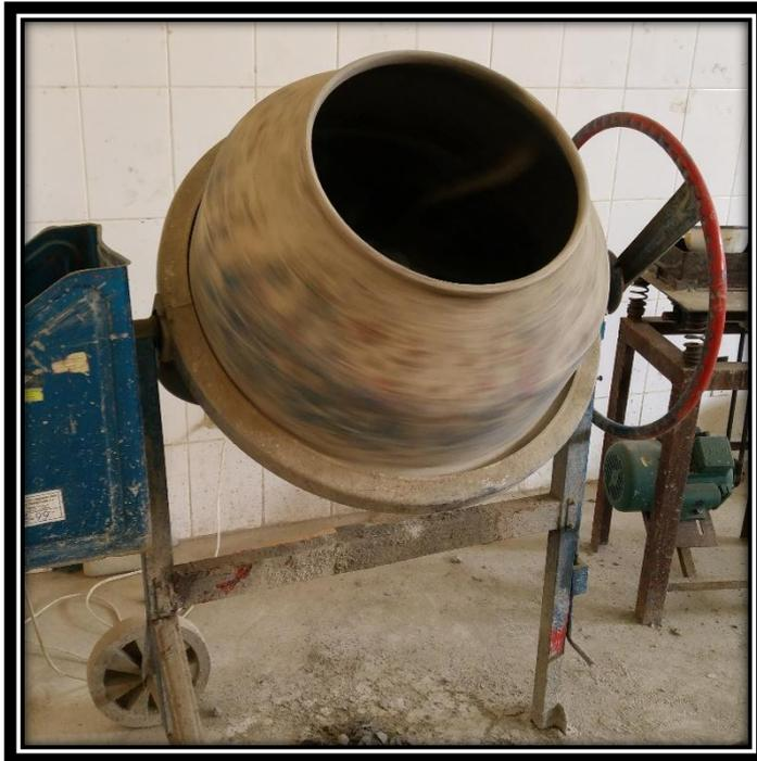
**FOTO 19:** Concreteira eléctrica para realizar el mezclado de los áridos, agua y cemento
