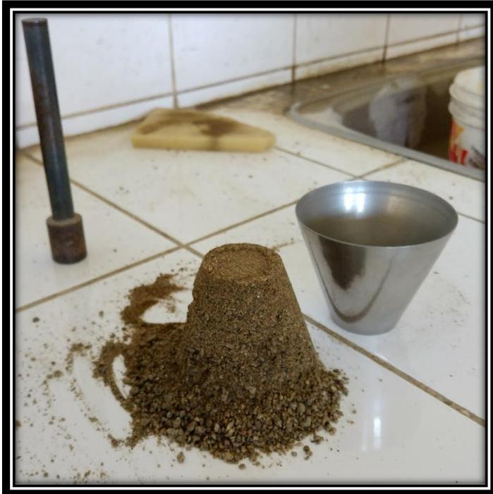
**FOTO 17:** Siguiendo el procedimiento del manual (NTP 400.022) para determinar la densidad relativa del agregado fino.
