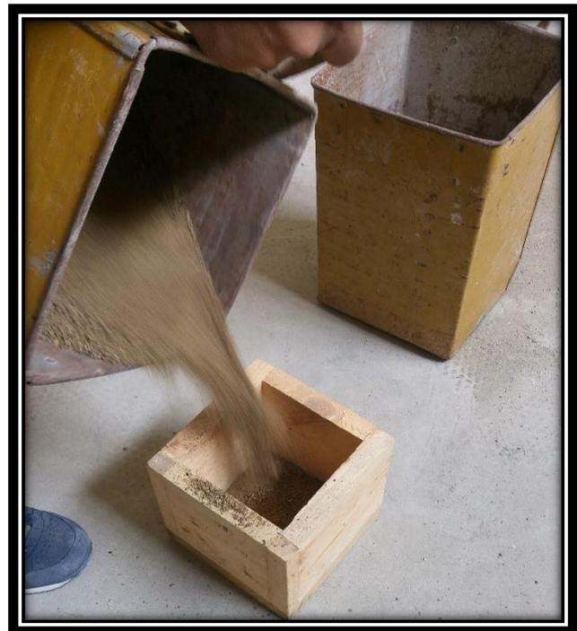
**FOTO 6:** Vaciando el agregado fino o arena gruesa en el molde hasta que ocupe todo el espacio del molde y enrazar.
