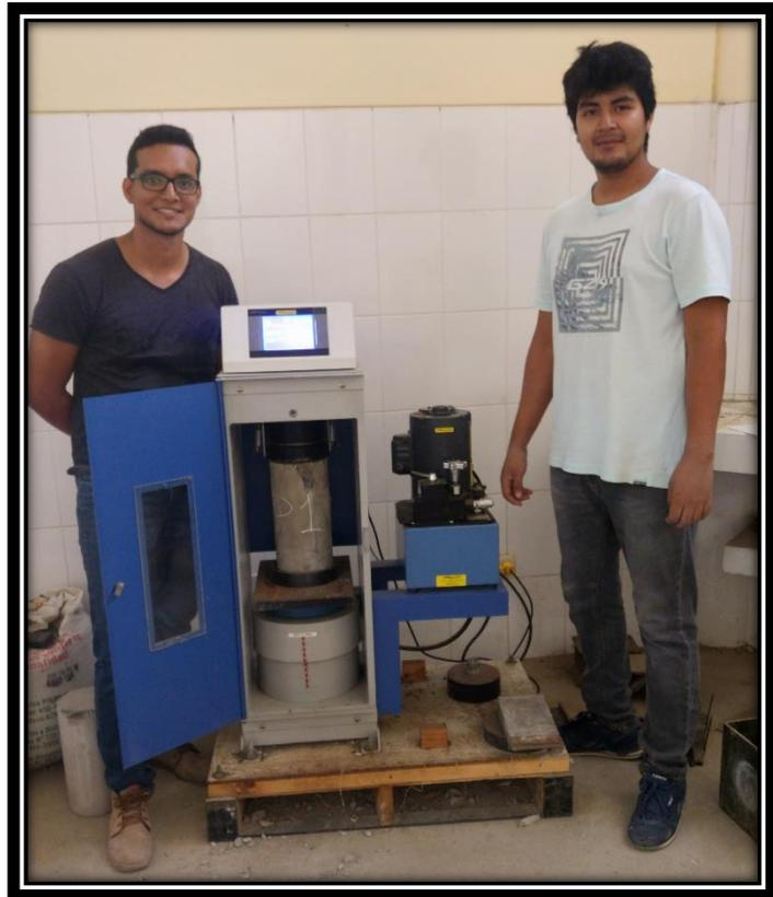
**FOTO 45:** *Ensayo de compresión de las probetas en el laboratorio de tecnología del concreto UNS.*
