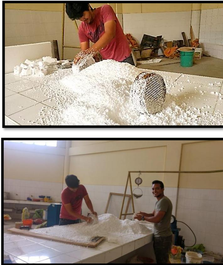
**Figura N° 2.11. Desintegración Mecánica de EPS Reciclado**
