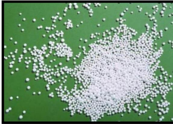
**Figura N° 2.5. Perlas de Poliestireno Expandido**
