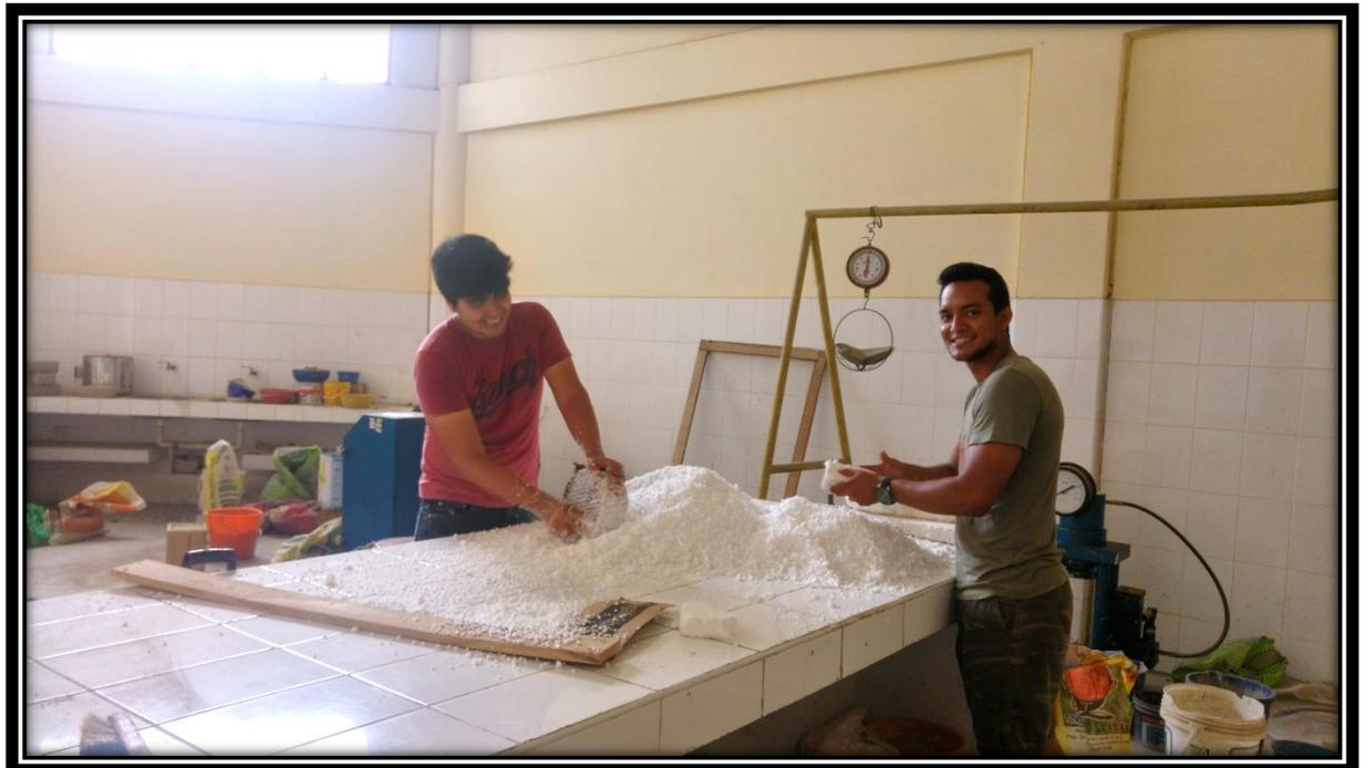
**FOTO 38:** Rayado y disgregado de los bloques reciclados de EPS para obtención en perlitas de Tecnopor antes del tratamiento térmico.
