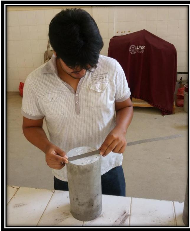
**FOTO 30:** Medición de las probetas de su diámetro previa al ensayo de compresión del mismo.
