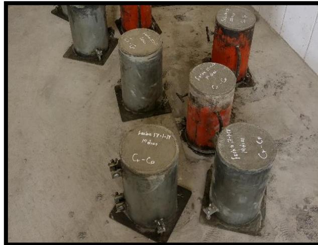
**Figura N° 3.7. Vertido y Compactación de Concreto**
