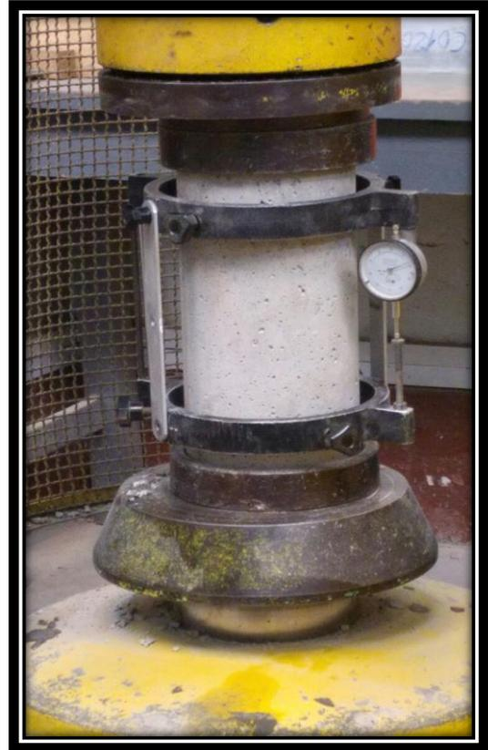
**FOTO 56:** Ensayo para determinar el módulo de elasticidad del concreto con MEPS con 20% de adición.
