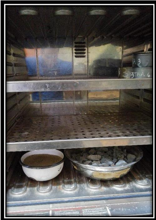
**FOTO 11:** Se procede a ingresar los agregados al horno por 24 horas para determinar el peso seco de los mismos.
