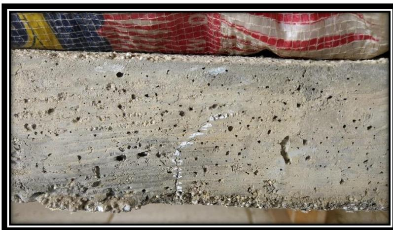
**FOTO 55:** Fisuras producidas por cargas permanentes a 1520kg/m<sup>2</sup>
