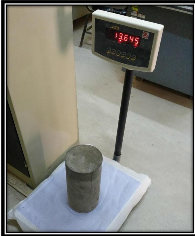
**FOTO 28:** *Pesado de las probetas después de su secado a temperatura ambiente.*
