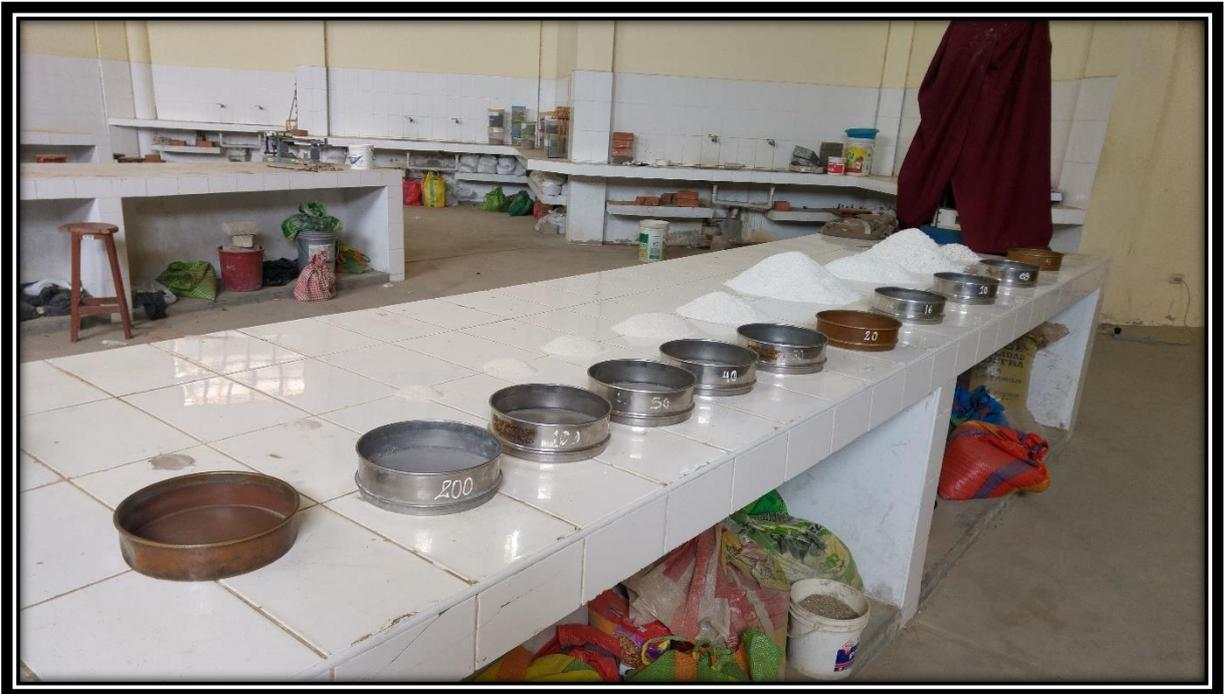
**FOTO 42:** Ensayo granulométrico del MEPS.
