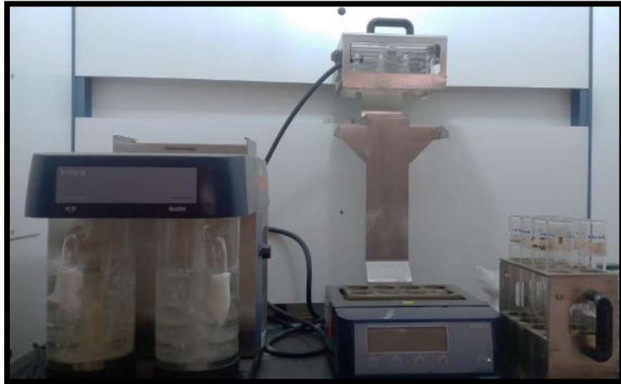
Figura A - 3: Sistema de digestión Foss
