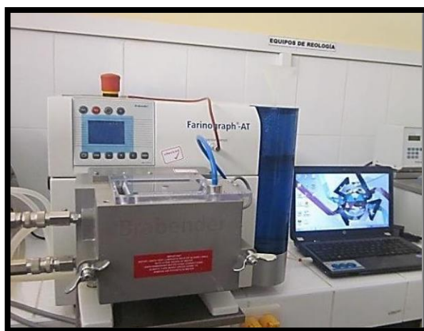
Figura A - 8: Farinógrafo Brabender
