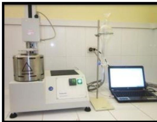
Figura A - 7: Amilógrafo Brabender
