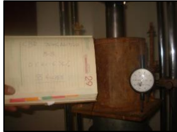
FOTO N°51 y N°52: Ensayo de suelo CBR listo para la penetración.
