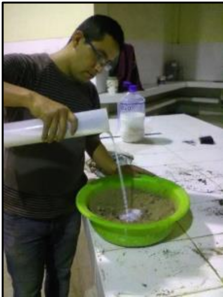
FOTO N°31 y N°32: Mezclamos con el suelo hasta homogenizar la muestra a ensayar. Compactamos el suelo en 5 capas dando 56 golpes con el martillo en caída libre.
