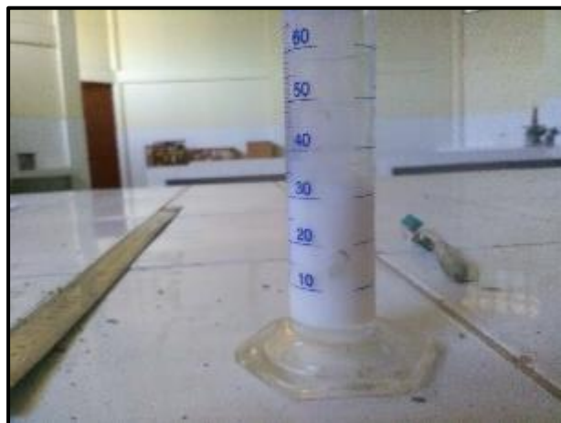
FOTO N°39 y N°40: 30 ml de aditivo para ensayo CBR. Se le Añade agua hasta el óptimo contenido de humedad obtenido en ensayo de Proctor Modificado
