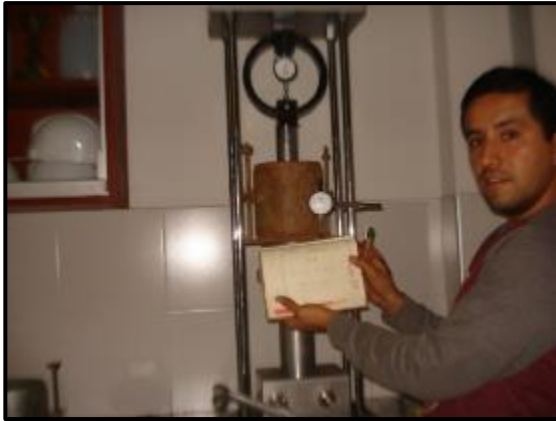
FOTO N°51 y N°52: Ensayo de suelo CBR listo para la penetración.
