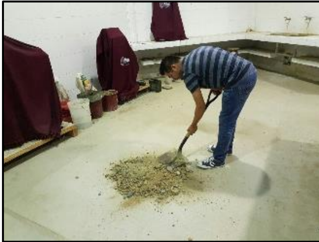
FOTO N°11: Preparación para la granulometría de cada calicata.
