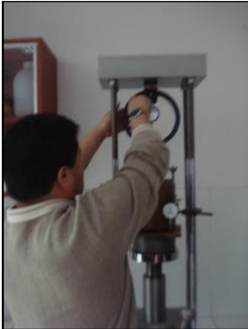
FOTO N°49 y N°50: Calibración y puesta en cero de los diales tanto de carga como de penetración
