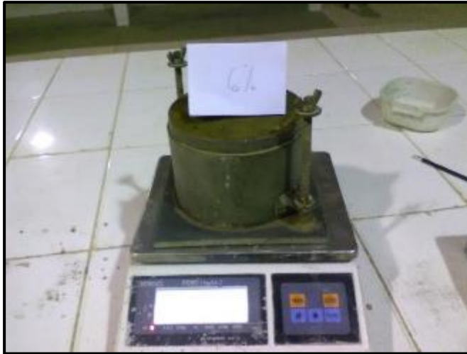
FOTO N°37: Peso de cada muestra de proctor modificado a diferentes contenidos de humedad.
