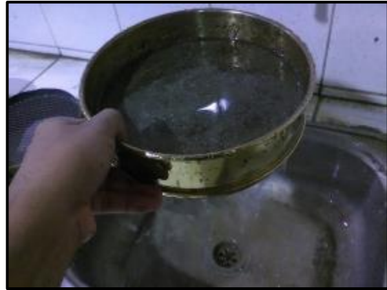
FOTO N°20 y N°21: Granulometría por lavado de arenas finas para obtener una curva más real. Se observa el paso del agua a través de la malla del tamiz N°200
