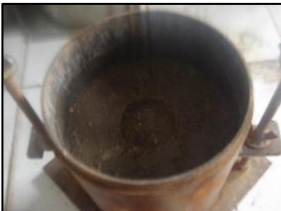
FOTO N°54: Muestra “A” tras el ensayo de CBR, sin aditivo.
