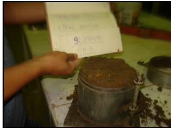
FOTO N°33, N°34, N°35 y N°36: PROCTOR MODIFICADO Muestras de suelos al 3%, 5%, 7% y 9% de líquido (agua + aditivo) para obtener el óptimo contenido de humedad.
