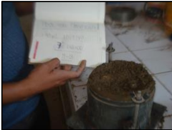
FOTO N°33, N°34, N°35 y N°36: PROCTOR MODIFICADO Muestras de suelos al 3%, 5%, 7% y 9% de líquido (agua + aditivo) para obtener el óptimo contenido de humedad.
