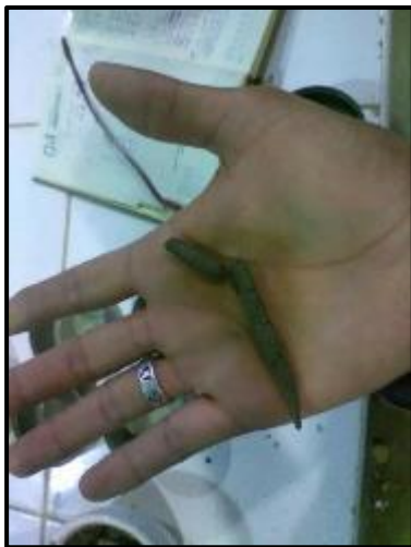
FOTO N°22: No se logró obtener los rollitos tal como pide el ensayo de límite plástico, debido a que carece de plasticidad.
