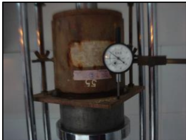
FOTO N°49 y N°50: Calibración y puesta en cero de los diales tanto de carga como de penetración
