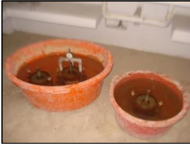
FOTO N°47 y N°48: Muestras CBR sumergidas totalmente por un periodo de 96 horas. No presenta expansión.
