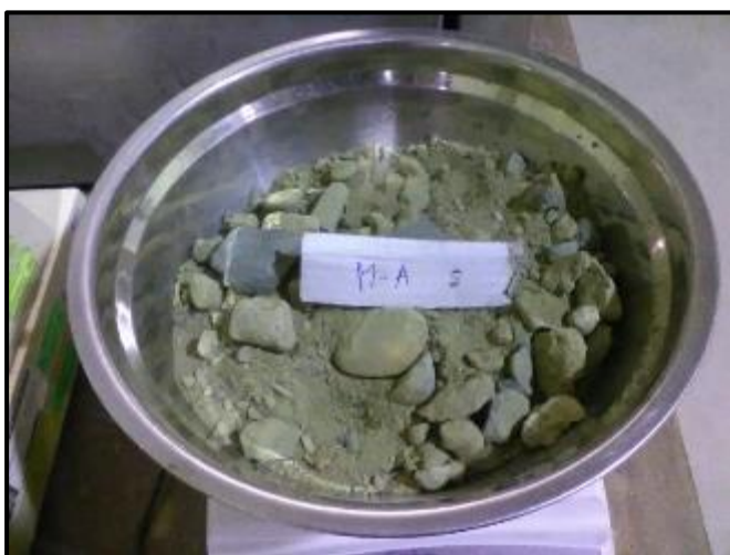
FOTO N°26: Muestra representativa de Muestra “A” para obtener el contenido de humedad y la granulometría correspondiente.
