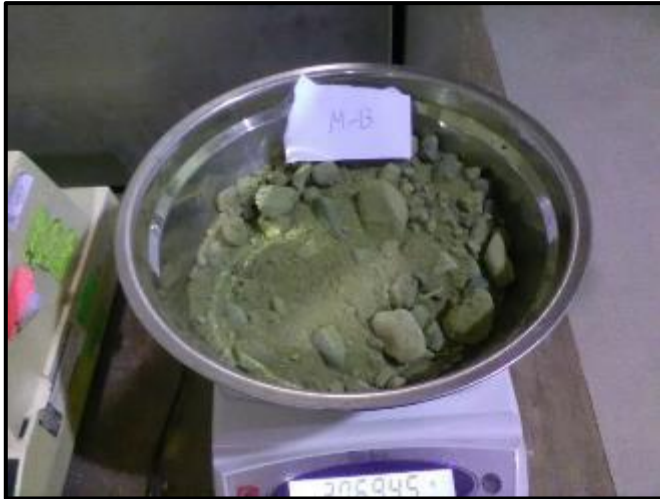
FOTO N°27: Muestra representativa de Muestra “B” para obtener el contenido de humedad y la granulometría correspondiente.
