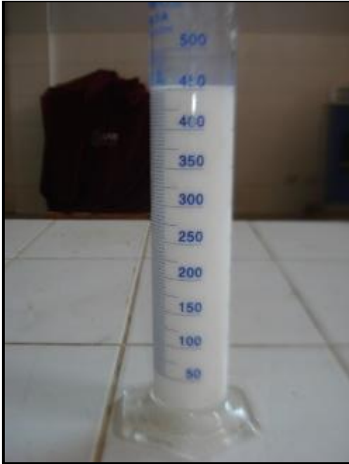
FOTO N°30: Añadimos agua hasta tener 450 ml, en esta imagen el 9%, para ensayo de proctor modificado.
