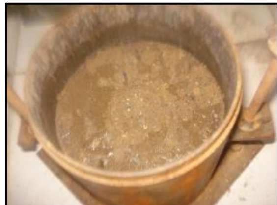
FOTO N°55: Muestra “B” tras el ensayo de CBR, con 30ml de aditivo.
