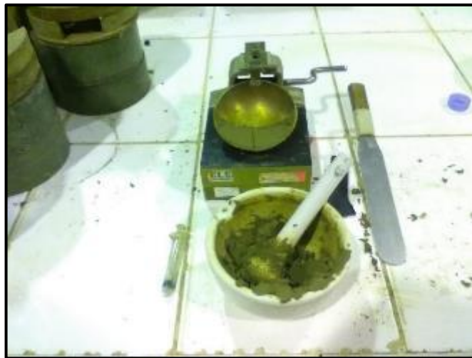
FOTO N°23: No se logró obtener el límite líquido, dificultad al hacer ensayo con la copa Casa Grande. Presencia de arenas no plásticas.
