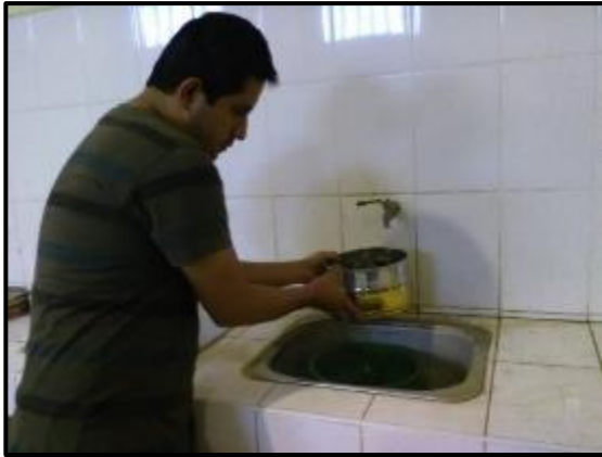
FOTO N°20 y N°21: Granulometría por lavado de arenas finas para obtener una curva más real. Se observa el paso del agua a través de la malla del tamiz N°200
