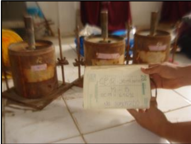
FOTO N°44: Moldes CBR de la Muestra “B” listo para penetración.
