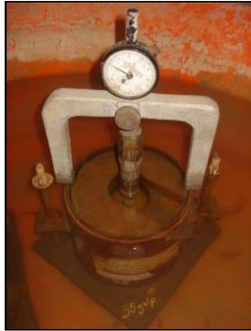
FOTO N°47 y N°48: Muestras CBR sumergidas totalmente por un periodo de 96 horas. No presenta expansión.
