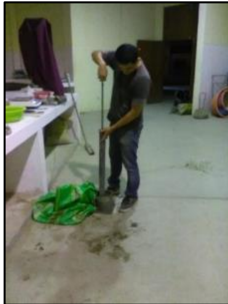
FOTO N°31 y N°32: Mezclamos con el suelo hasta homogenizar la muestra a ensayar. Compactamos el suelo en 5 capas dando 56 golpes con el martillo en caída libre.
