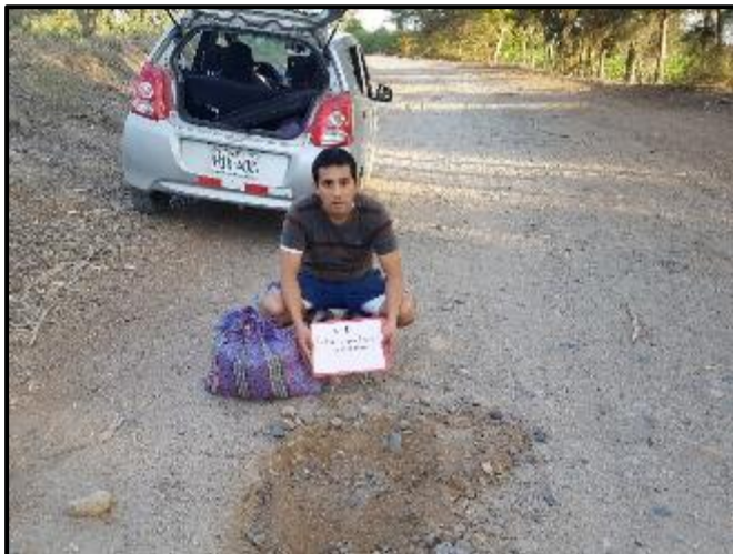
FOTO N°06: Toma de muestra de suelo en Tangay Alto (Calicata N°2)
