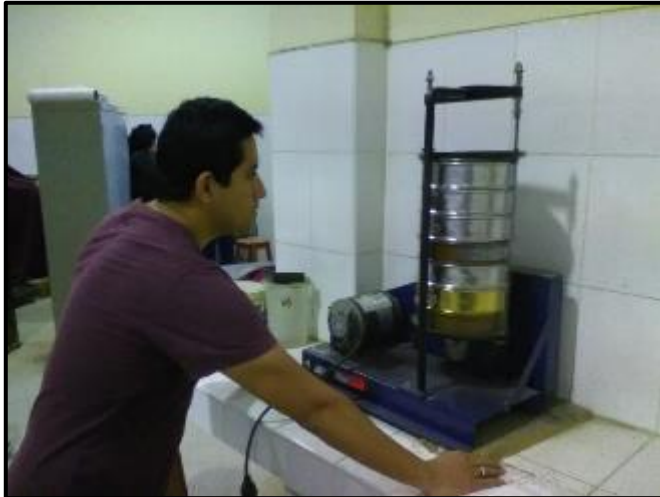
FOTO N°16: Tamizaje con equipo eléctrico para obtener curva granulométrica.
