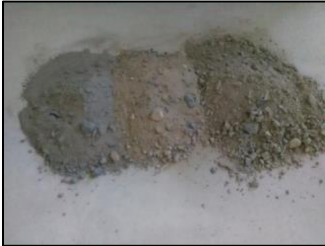
FOTO N°24: Muestra de suelos de las calicatas N°1, N°2 y N°3 para formar la Muestra “A”
