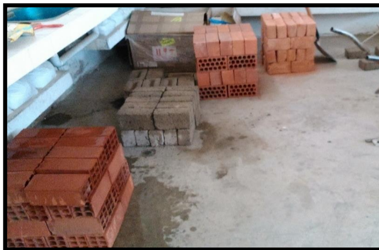
Figura N° 07. Unidades de albañilería de ferreterías Dino, en la ciudad de Nuevo Chimbote. (Fuente: propia).
