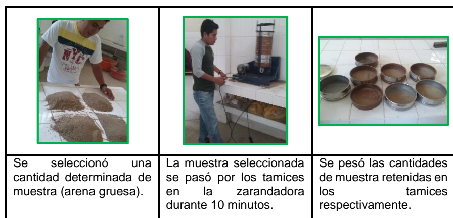
Figura N° 13. Ensayo de granulometría de la arena gruesa. (Fuente: propia).
