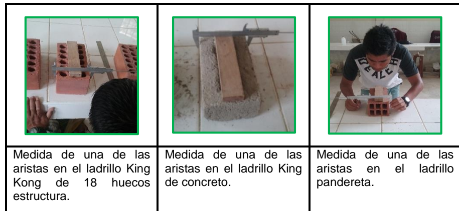
Figura N° 08. Medida de la caras de las unidades de albañilería. (Fuente: propia).
