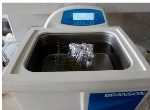
Algunas muestras en el lavado por ultrasonido para la extracción.
