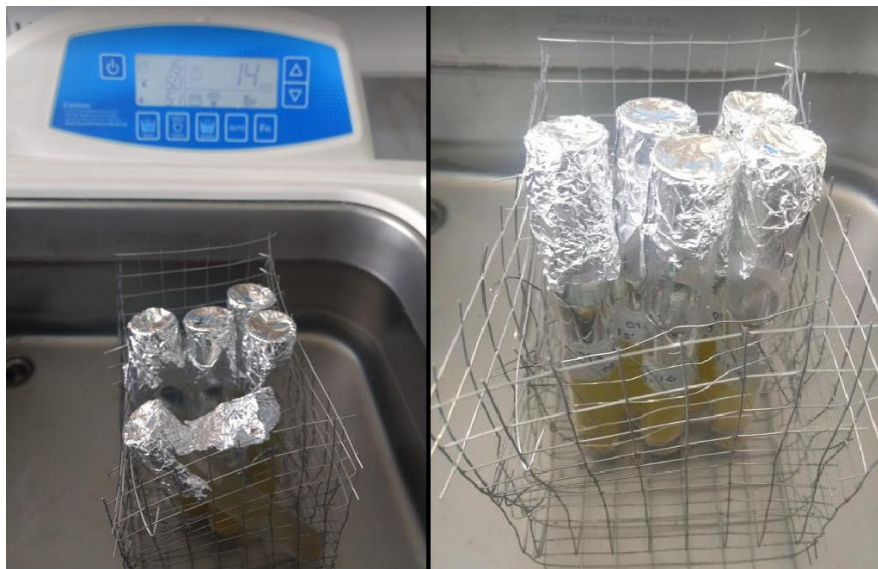
Figura 13. Vista del equipo de extracción asistida por ultrasonido, con muestras de desechos jalapeño verde, sometidos a diferentes variables.
