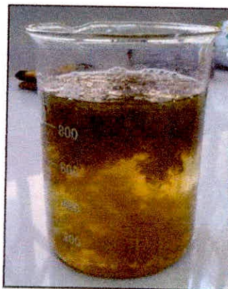
Figura 11: Etapa de precipitación con alcohol de 96° durante el proceso de extracción del hidrocoloide
