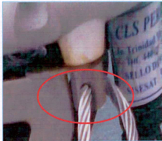
Fig. 21 Forma correcta de colocar el precinto en modelo de equipo SISESAT tipo “casco ciclista” (el precinto se asegura por el perno ciego, en un solo punto)
