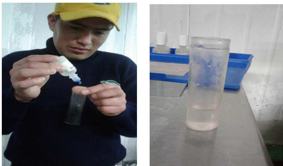
Figura 20. Adición de Tiosulfato de Sodio al 1.8%
