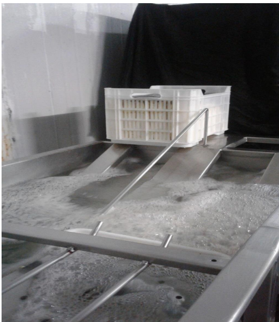
Figura 15. Hidrogenfriado y desinfección de producto terminado (PPC)
