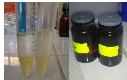
Separar la fase acuosa, almacenar con nitrógeno en refrigeración.
