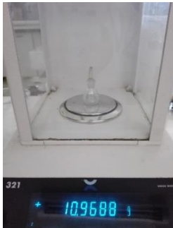
Peso del picnómetro vacío
