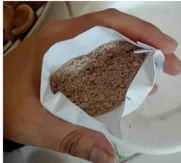
Pesar la muestra de harina y formar capachos con la muestra
