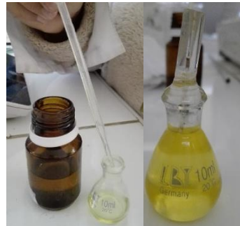
Adición de la muestra de aceite en el picnómetro
