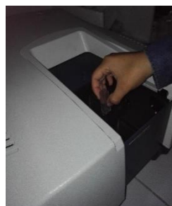
Colocar el vial en el espectrofotómetro
