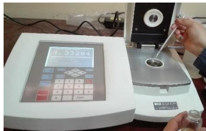
Adición de aceite en el refractómetro
