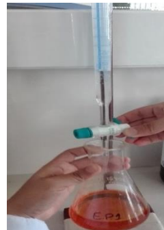
Titulación Tiosulfato de sodio 0.01 N
