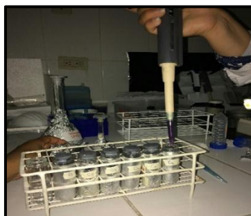
Figura 83. Adición de solución de DPPH en cada vial.
