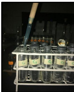
Figura 67. Adición de agua destilada en cada vial, completando un volumen de 3300 uL.
