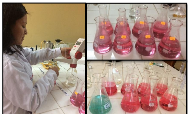
Figura 37. Titulación de las muestras con solución de HCl 0.1 N, valoración hasta virar a color rosa.
