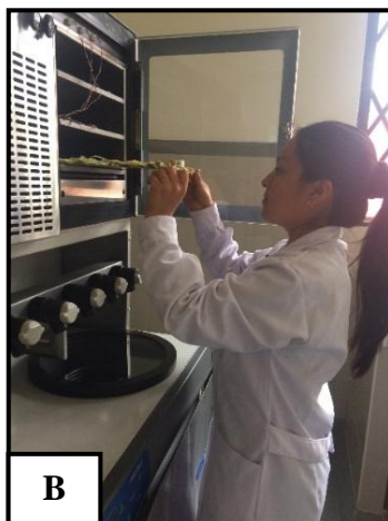
Figura 10. Secado por liofilización. A). Acondicionamiento de la alcachofa en la bandeja. B). Colocación de las bandejas en el liofilizador. C). Recepción de alcachofa liofilizada.
