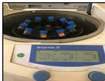
Figura 55. Centrifugación de las muestras, 3500 rpm durante 10 minutos.
