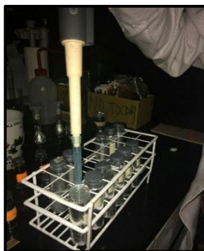
Figura 66. Volúmenes de 150, 300, 600, 900, 1200 y 1500uL de solución estándar de Ácido Gálico son colocados en viales de vidrio.
