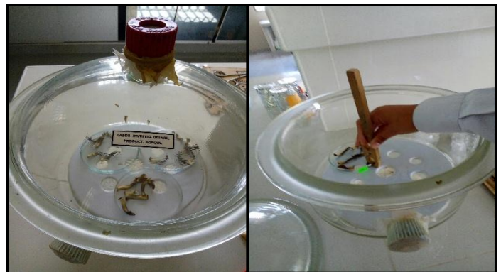
Figura 21. Campana de desecación conteniendo las muestras, después del proceso de secado en estufa.
