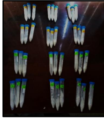
Figura 86. Pesar tres cantidades de almidón en proporción 1:30 (w/w) y colocarlas en Tubos
