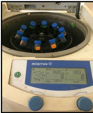
Figura 88. Centrifugación de las muestras, 3500 rpm durante 15 min.
