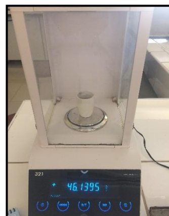
Figura 29. Pesado de las muestras luego de su completa incineración.
