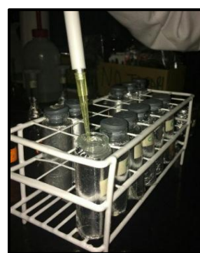
Figura 68. Adición de 150 uL de carbonato de sodio 7.5%.
