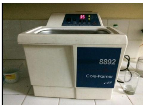
Figura 54 Colocación de las muestras en el equipo de ultrasonido durante 30 min a 60°C.
