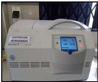
Figura 46. Centrifugación de las muestras, 3000 rpm durante 20 min.
