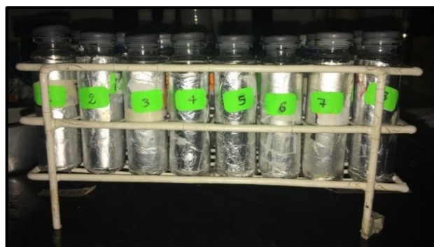
Figura 100. Viales con muestra y reactivo FRAP antes de la medición.
