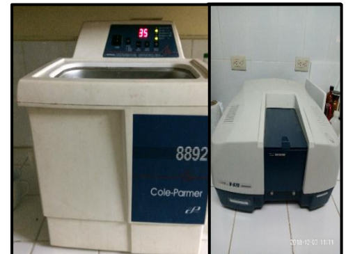
Figura 93. Incubación en baño María a 35°C por 2 horas, y posterior lectura de la abs a 517 nm.
