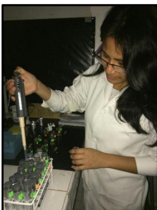
Figura 73. Alícuotas de 900uL de las muestras son colocadas en viales de vidrio
