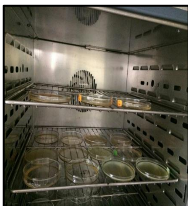
Figura 42. Secado en estufa de las muestras, 90°C durante 4 horas.
