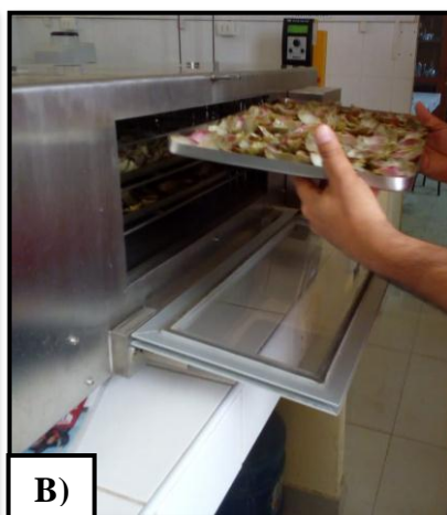
Figura 11. Secado en bandeja A). Acondicionamiento de la alcachofa en la bandeja. B). Colocación de las bandejas en el secador de bandeja. C). Recepción de alcachofa seca, por aire caliente.
