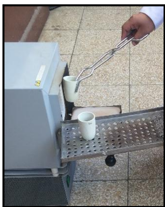
Figura 27. Muestras colocadas en la mufla por 3 horas a 600°C.
