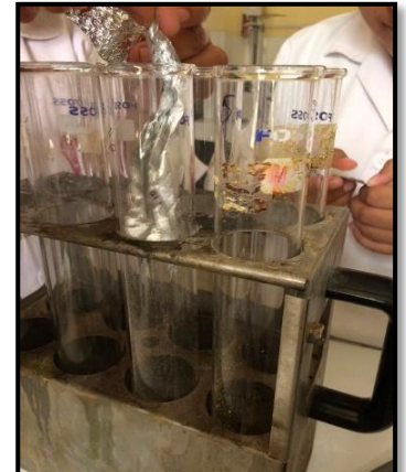
Figura 32. Adición de las muestras en los tubos de mineralización.
