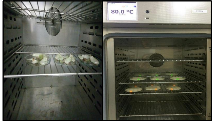
Figura 19. Secado en estufa de las muestras, 110°C durante 3 horas
