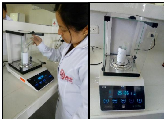
Figura 38. Pesado de la harina de brácteas de alcachofa (2.5 g) en tubos Falcom, previamente tarados.
