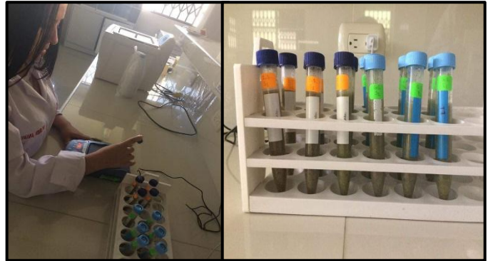
Figura 45. A) Agitación durante 1 minuto, de los Tubos Falcom los cuales contienen 1 g de harina y 10 ml de agua destilada, y B) dejar reposar durante 24 horas.
