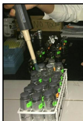
Figura 74. Adición de 2400uL de agua destilada en cada vial.
