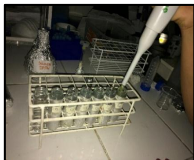
Figura 82. Alícuotas de estándar de Trolox (50mg/100mL) son colocados en viales de vidrio.
