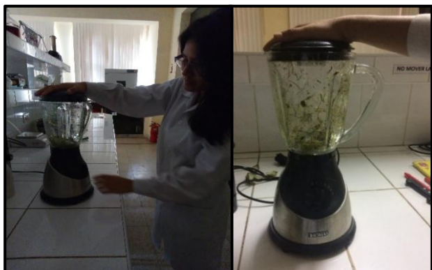
Figura 50. Licuado de brácteas de alcachofa (materia prima) utilizando solvente para su extracción.
