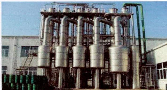
**Figura N° 16: sistema de Evaporadores en Serie**
