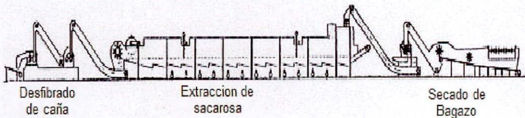
**Figura N° 14: Proceso de Molienda**
