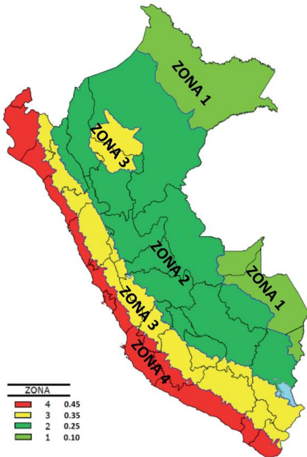
**Figura III-006. Zonificación sísmica**
