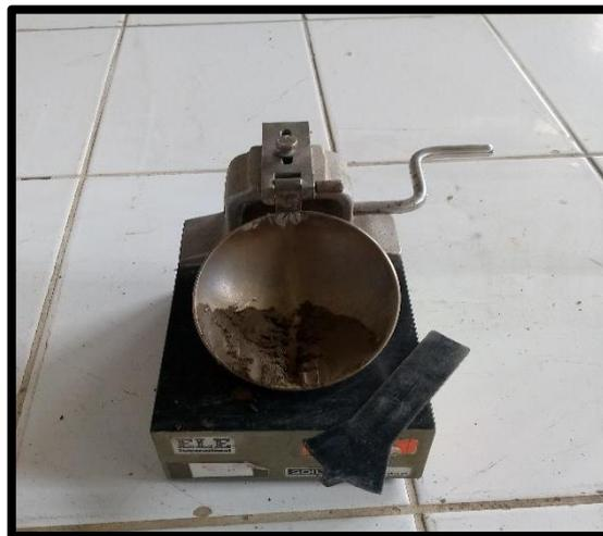
*Figura 2: Ensayo de límite líquido del suelo.*
