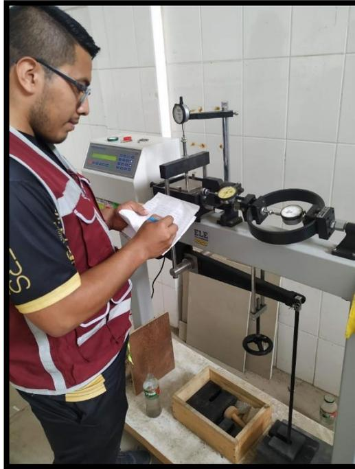
*Descripción: Apunte del corte y deformación de la muestra del suelo.*
