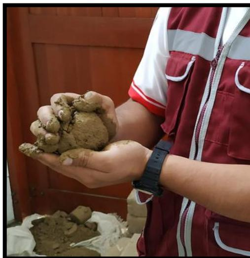
*Figura 14:* Prueba de resistencia seca
