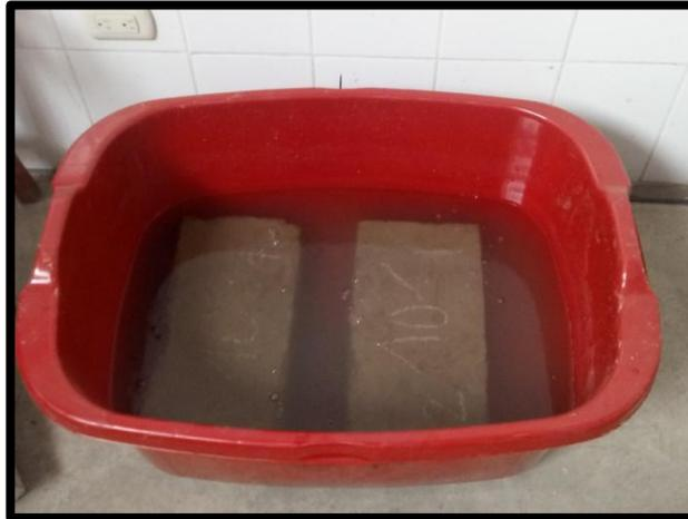
*Figura 21: Ensayo de absorción*
