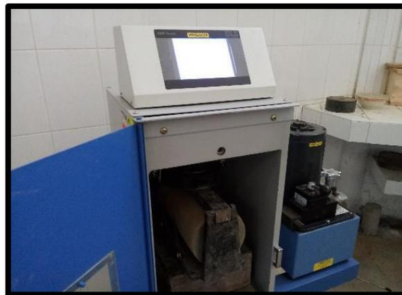
Figura 24: Ensayo de Tracción indirecta a las probetas de barro
