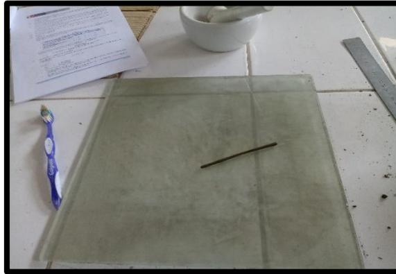
Figura 3: Ensayo de límite plástico del suelo.
