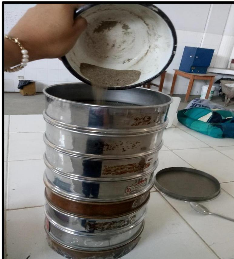
*Figura 4: Ensayo de Granulometría del suelo.*
