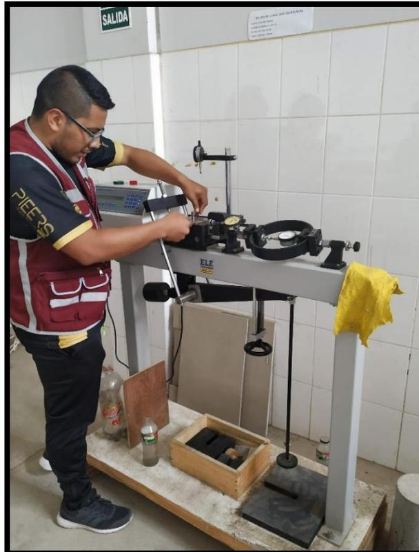
*Descripción: Colocación del molde con la muestra del suelo (remoldeado) en la máquina de Corte Directo.*
