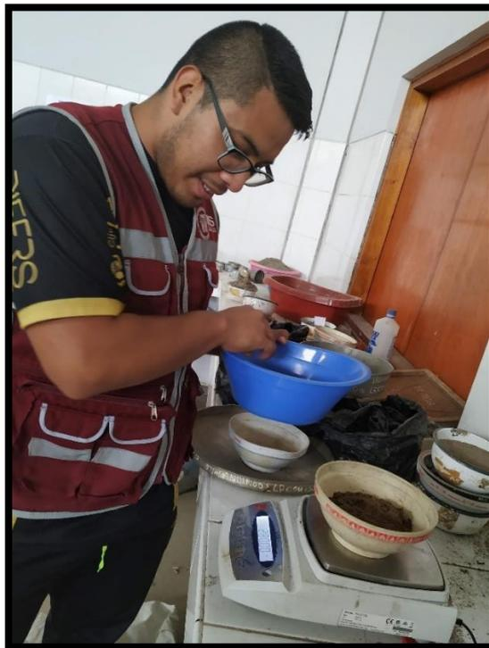
*Descripción: Peso 280gr de la muestra para realizar el ensayo de corte directo.*
