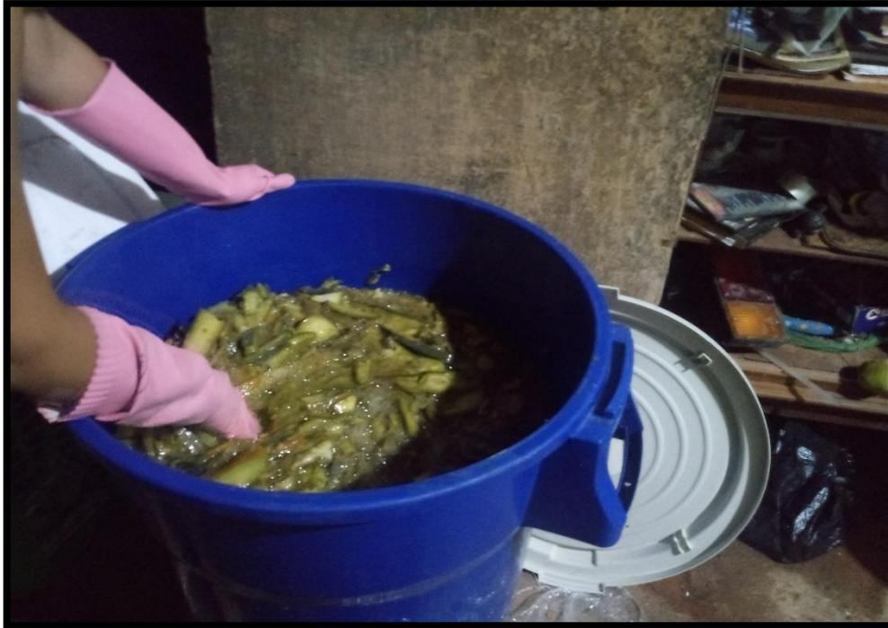
*Descripción:* Proceso de macerado de la tuna, previamente picada. Consiste en colocar en baldes la tuna más la misma cantidad de agua, hasta que se forme una goma con la mayor viscosidad.
