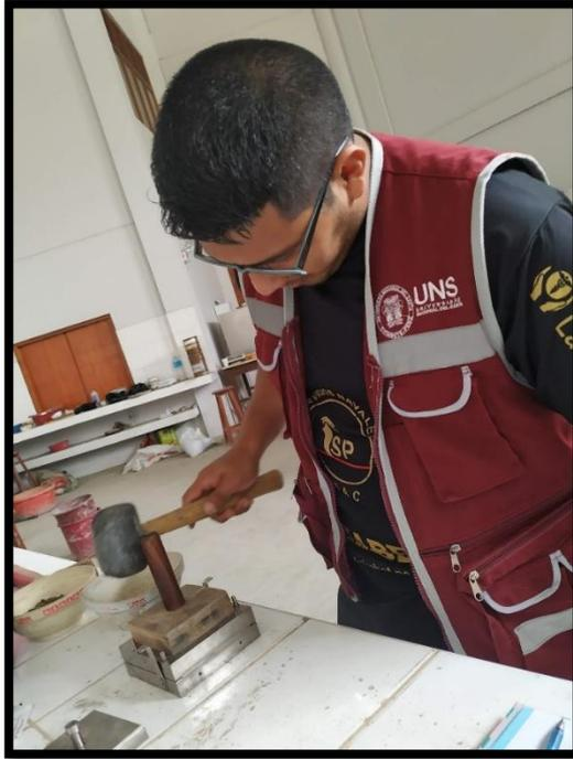
*Descripción: Apisonado de la muestra del suelo en el molde para el ensayo de Corte Directo.*
