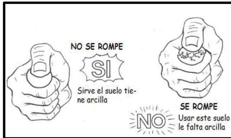
Figura 15: Prueba de resistencia seca.
