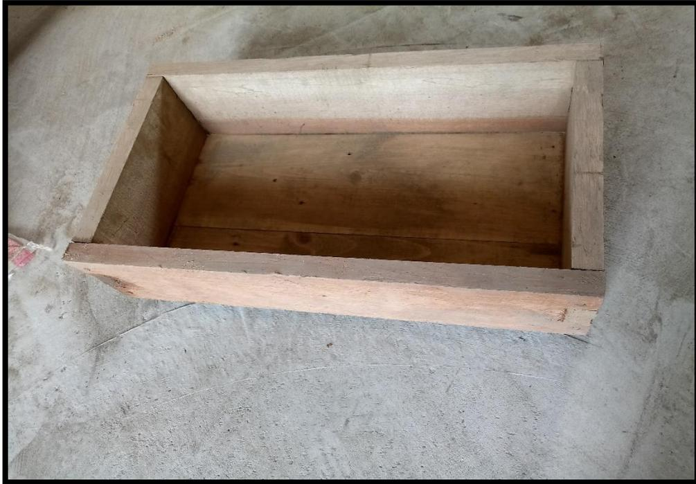
*Descripción:* Vista en planta del molde utilizado para la fabricación de las unidades de adobe con las dimensiones internas de 0.20 x 0.40 x 0.10 m.
