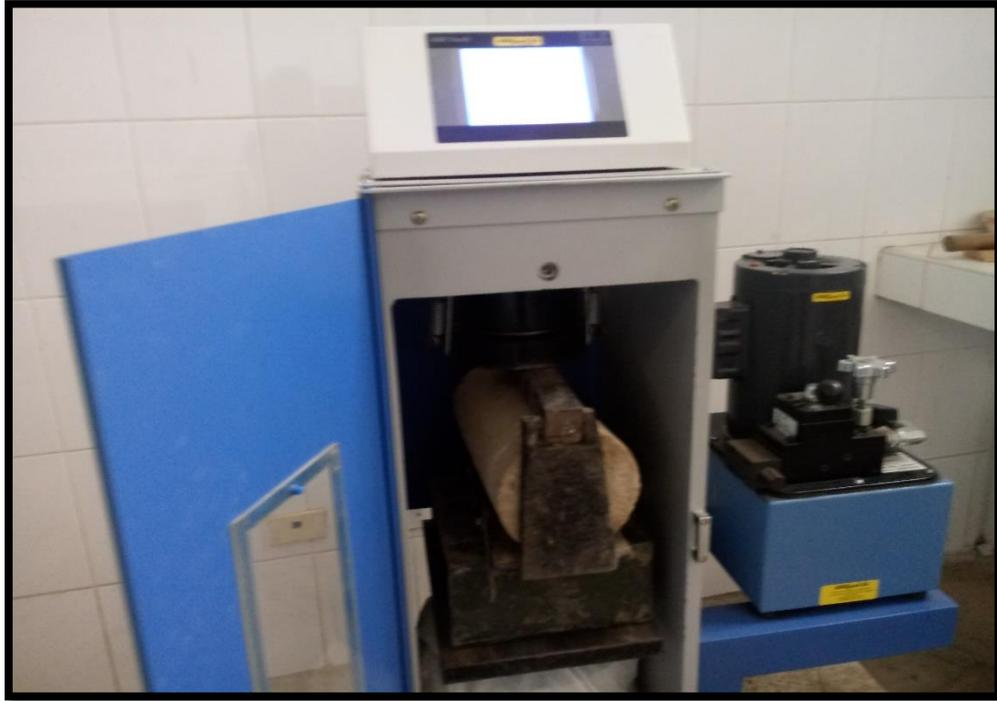
*Descripción: Probeta de adobe, sometida al ensayo de tracción indirecta, en el laboratorio de suelos de universidad Nacional del Santa.*
