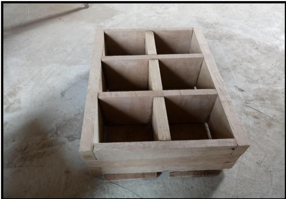
*Descripción:* Vista en planta del molde utilizado para la fabricación de los cubos de adobe, para la ejecución del ensayo de esfuerzo a la compresión. Presenta cubos con dimensión interior de 0.10m de arista.
