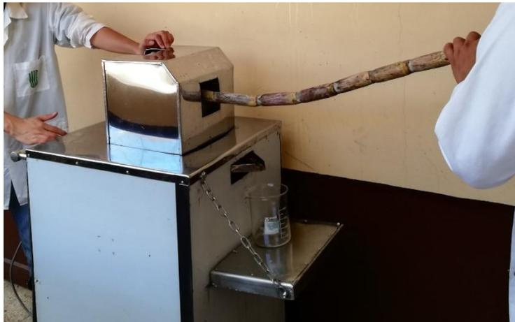
**Figura 41: Extracción de jugo de caña de azúcar mediante trapiche**
