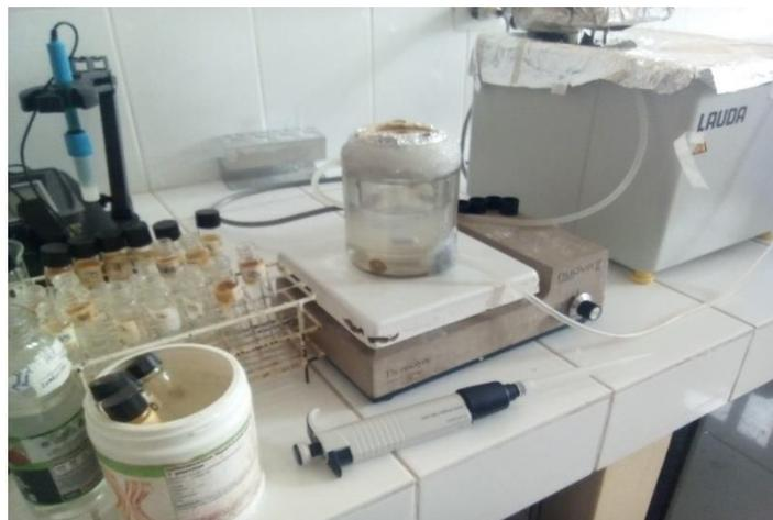
**Figura 39: Hidrólisis enzimática del medio sintético de jugo de caña.**
