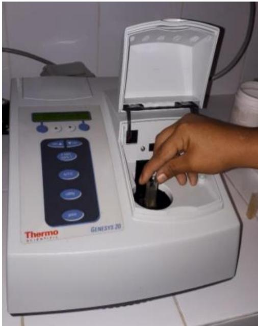
**Figura 46: Medición por espectrofotómetro**
