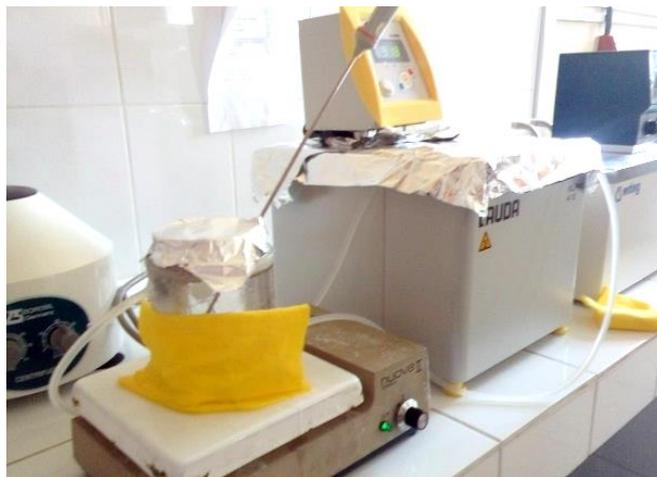
*Figura 16. Minireactor con agitador acoplado a baño María para hidrólisis de almidón.*
