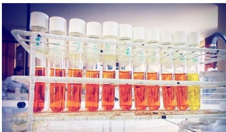
**Figura 40: Ensayo para la curva de calibrado del DNS**
