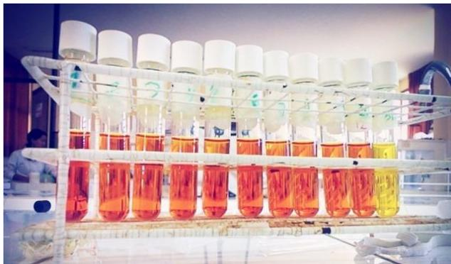
*Figura 18. Determinación de azúcares reductores por DNS*
