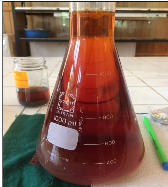
Figura 49. Medio de cultivo 9K homogeneizado antes de ser distribuido en matraces para el proceso de biooxidación.
