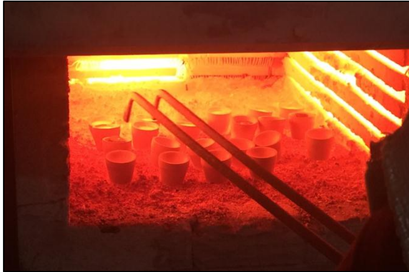
Figura 65. Etapa de copelación en el proceso de ensayo al fuego (Fire Assay). Se observan las copelas (previamente calentadas) en el horno de fundición y la operación de colocar los regulos sobre cada una de ellas, con ayuda de una pinza.
