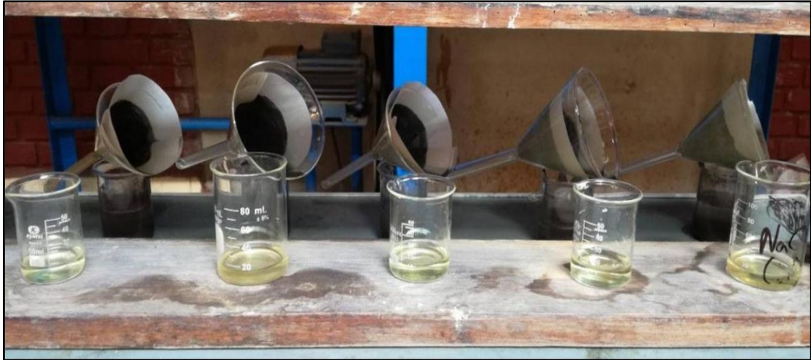
Figura 55. Obtención de soluciones pregnant y relaves luego de la cianuración, mediante proceso de filtración.
