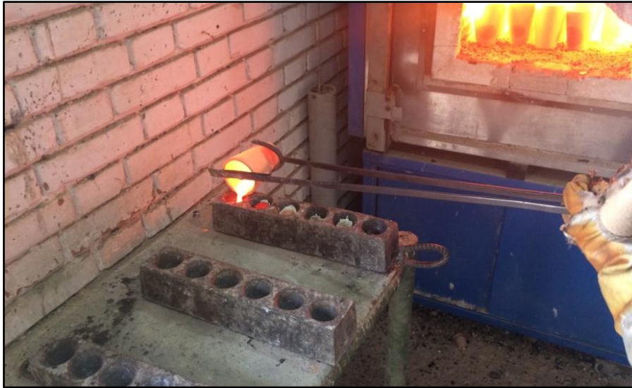
Figura 63. Muestra en estado líquido luego del proceso de fundición siendo colocada sobre las lingoteras para posteriormente a partir de esta obtener el régulo.
