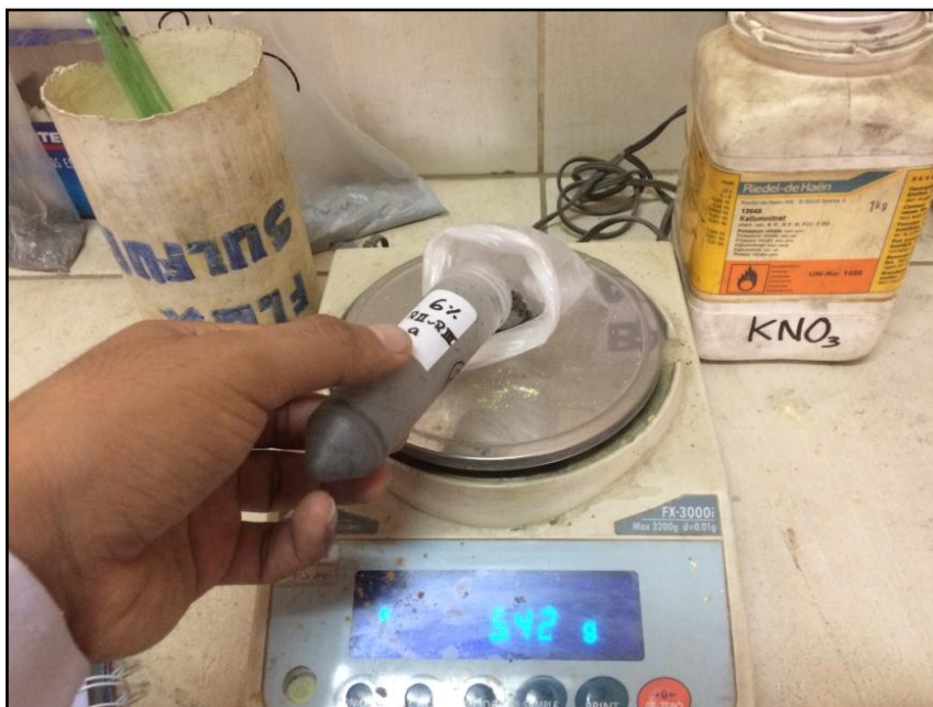
Figura 60. Pesaje de la muestra de relave (mineral) para mezclarlo con fundente y realizar la fundición. A la derecha se observa el nitrato de potasio (KNO 3 ), el cual forma parte de los fundentes y a la izquierda el Flux sulfuros.
