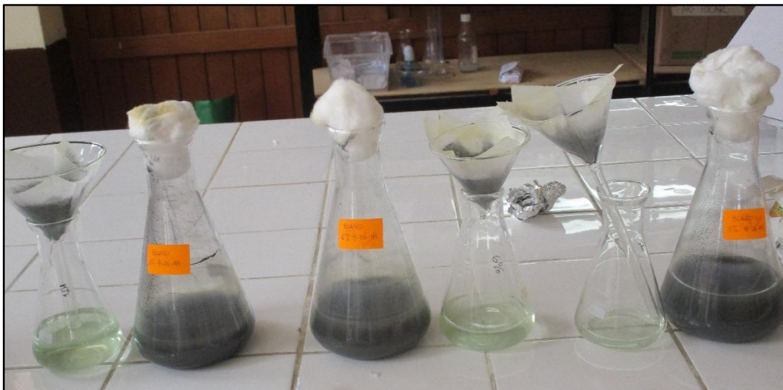
Figura 52. Finalización del proceso de biooxidación. Se observan las muestras listas para ser filtradas.
