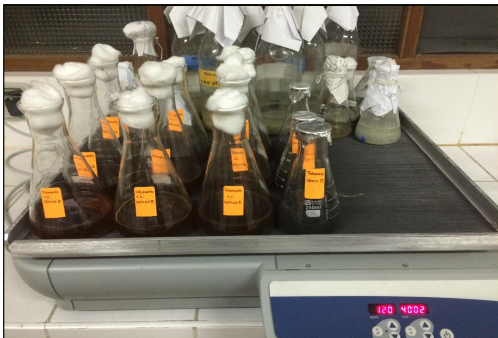
Figura 50. Proceso biooxidativo realizado en matraces, conteniendo medio 9K con mineral. Condiciones de operación a agitación de 120 rpm y a temperatura ambiente.
