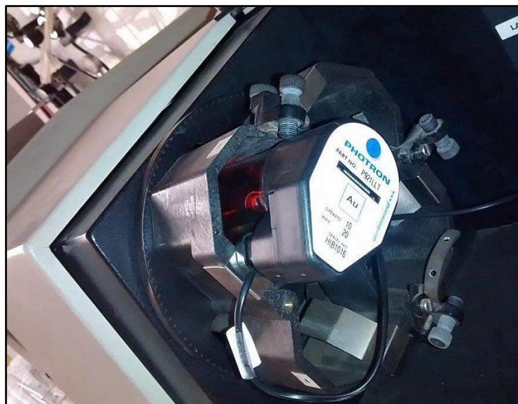
Figura 58. Lámpara de cátodo hueco para lectura de oro colocado en la torreta con capacidad para 4 lámparas.
