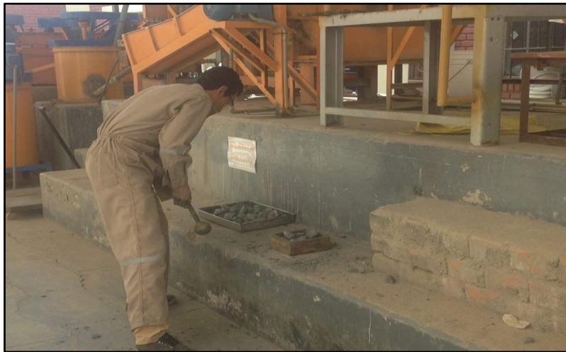
Figura 35. Mineral en bruto reducido a trozos utilizando un combo y mortero para posteriormente enviar la muestra a la chancadora de quijadas.
