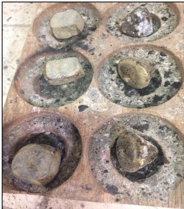
Figura 64. Régulos de plomo conteniendo oro y plata obtenidos luego del proceso de fundición listos para darles forma de cubos (para facilitar su manipulación) y realizar la copelación.
