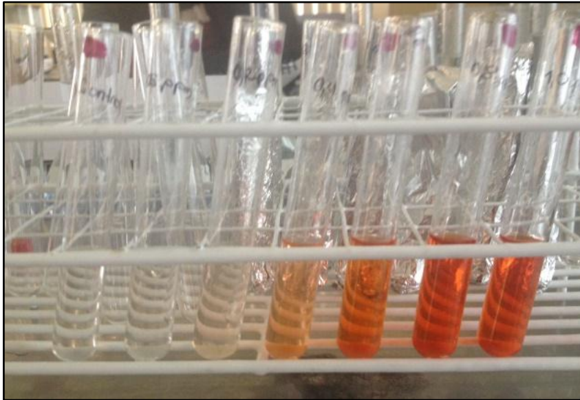
Figura 51. Muestras listas de sulfato ferroso y fenantrolina para realizar lectura en espectrofotómetro.
