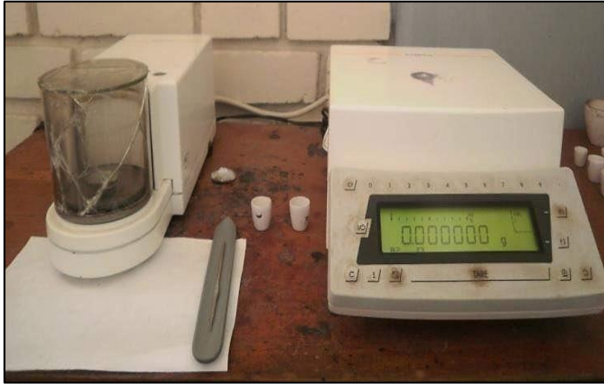
Figura 67. Microbalanza modelo, Sartorius ME5 en donde se realiza el pesado del oro luego del proceso de refinado en el Fire Assay.
