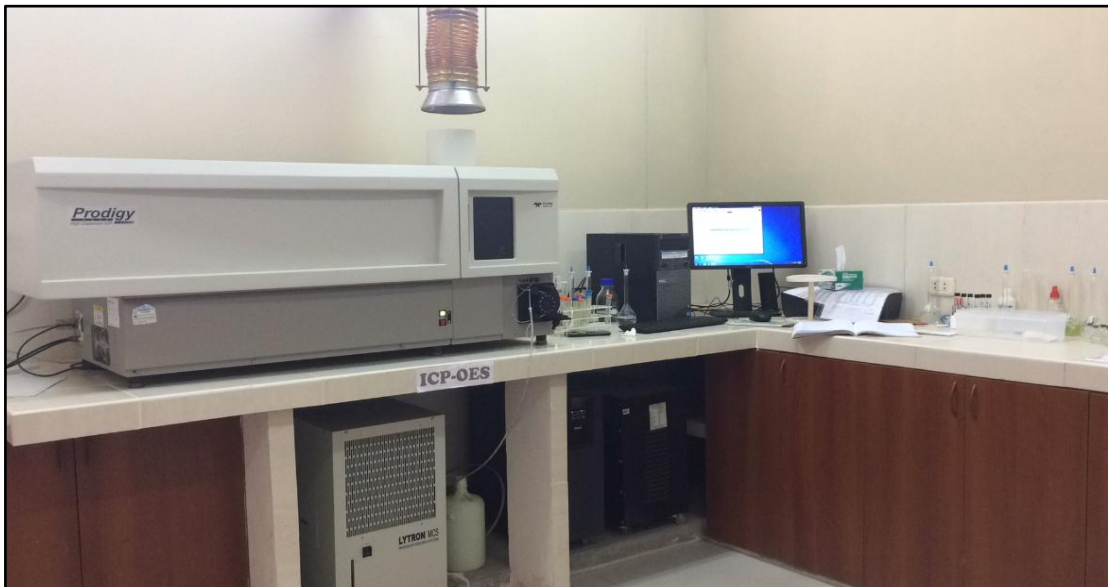
Figura 40. Equipo espectrofotómetro de emisión óptica con acoplamiento de plasma inductivo (ICP-OES), modelo Prodigy. Este equipo realizó el análisis químico multielemental de la muestra de mineral.
