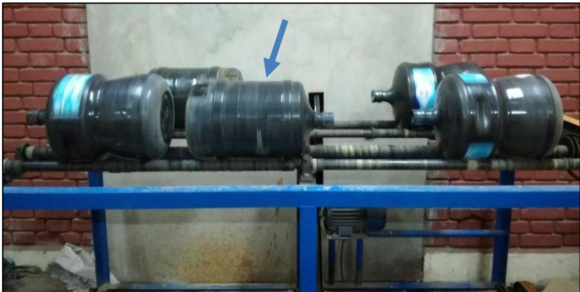
Figura 54. Proceso de cianuración en botella: Se observa la mesa roladora y sobre ella las botellas en constante agitación. La botella de forma cilíndrica uniforme (señalada) contiene las muestras experimentales.
