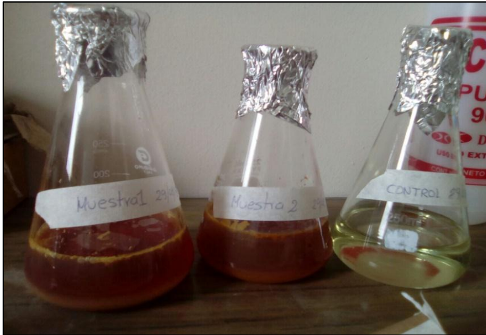
Figura 45. Cultivos de microorganismos acidófilos quimilitoautótrofos en medio 9K. Se observa color rojo característico en el medio lo cual evidencia una oxidación parcial del Fe presente. A la derecha se observa el matraz control, el cual no fue inoculado.
