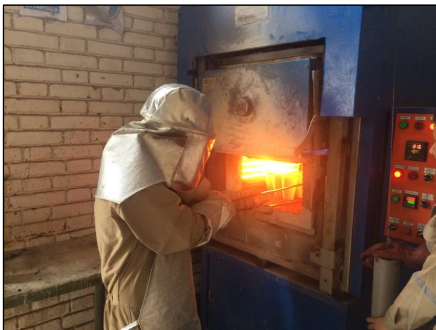
Figura 62. Fundición de las muestras sólidas. Se observa el acto de colocación de los crisoles en el horno, en donde el operador está con su respectivo equipo de protección personal (EPP).
