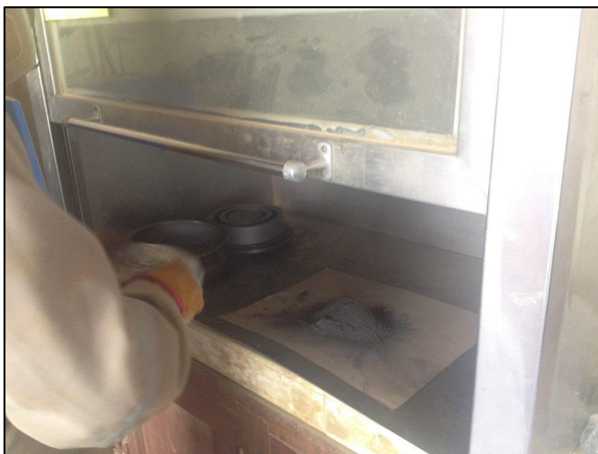
Figura 37. Obtención de la muestra pulverizada luego de haber pasado por la pulverizadora de anillos. Dentro de la cabina, a la izquierda, se observan una de las ollas y los anillos que forman parte del pulverizador.
