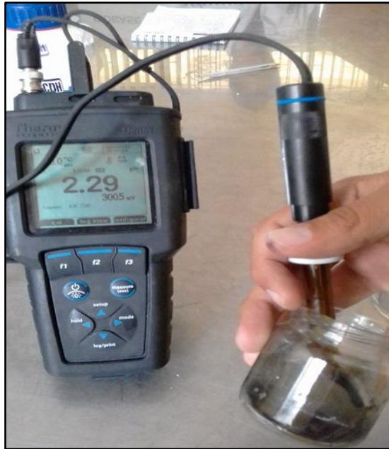
Figura 41. Medición del pH del mineral aurífero refractario.
