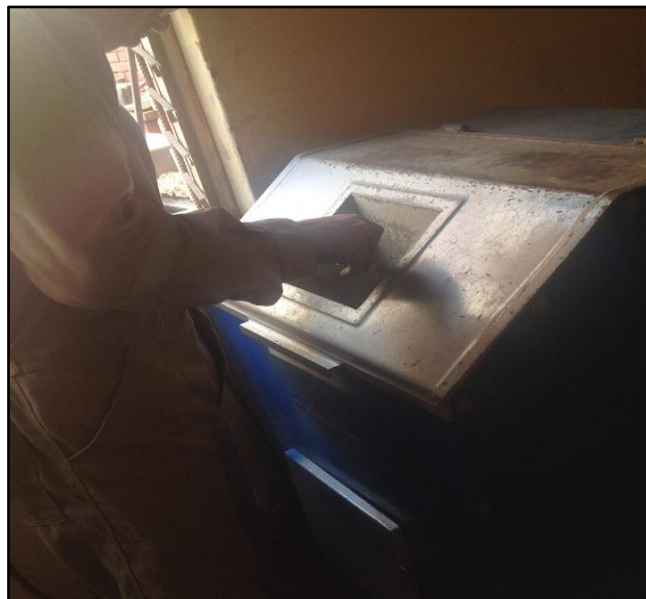
Figura 36. Colocación de la muestra de mineral en la chancadora de quijadas para posteriormente enviar al cuarteador de rifles.
