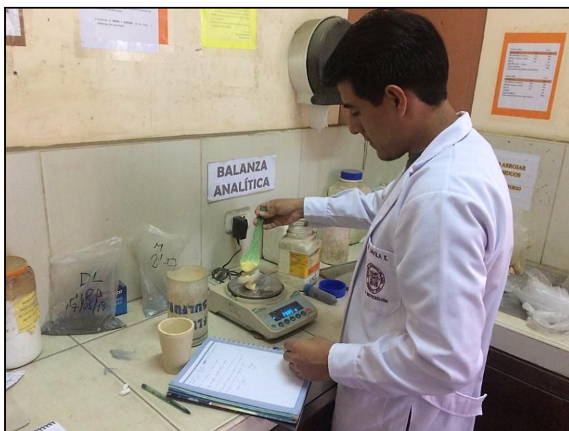
Figura 61. Preparación de las muestras de relaves con fundente para sulfuros (Flux Sulfuros) para realización de ensayo al fuego (Fire Assay).
