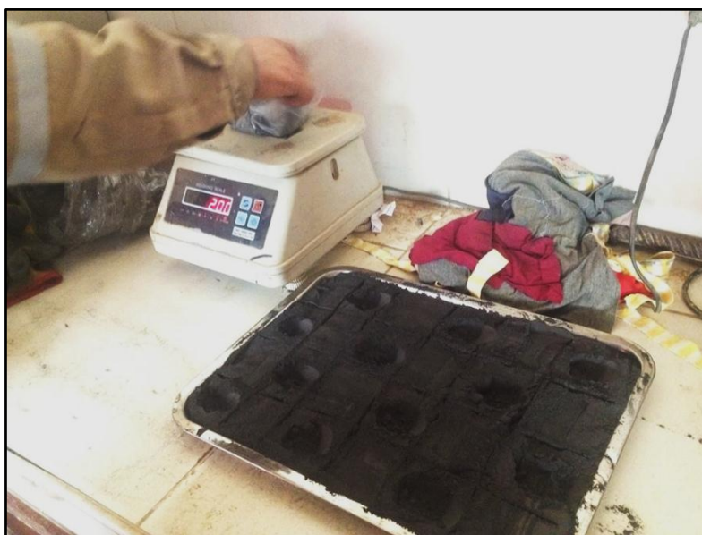
Figura 38. Homogeneización de la muestra de mineral pulverizado por el método del damero: Paleo fraccionado y alternado.
