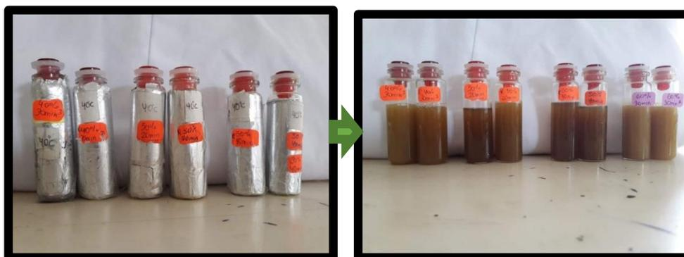
Figura 35. Extractos obtenidos a temperatura de 40 °C, con diferentes concentración de solvente y tiempo.
