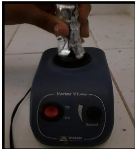
Figura 43. se agrego el reactivo trolox, colocar al ultrasonido por 1 hora, luego agitar
