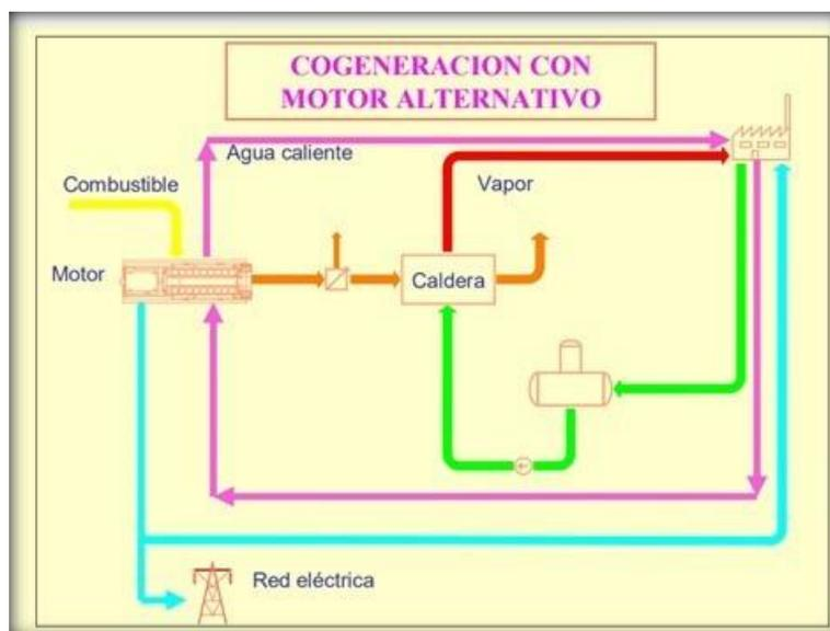
**Figura 6. Planta de Cogeneración con Motor Alternativo.**
