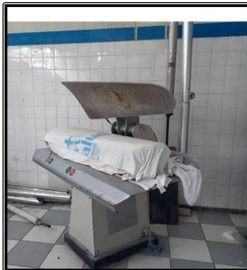
**Figura 19. Planchadora a vapor tipo Prensa.**
