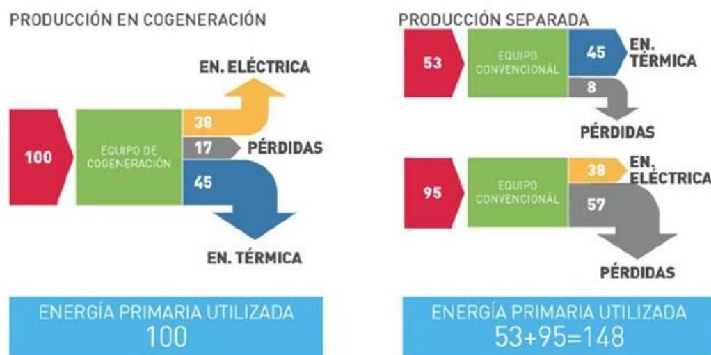
**Figura 22. Diagrama Comparativo entre producción con cogeneración y producción separada.**
