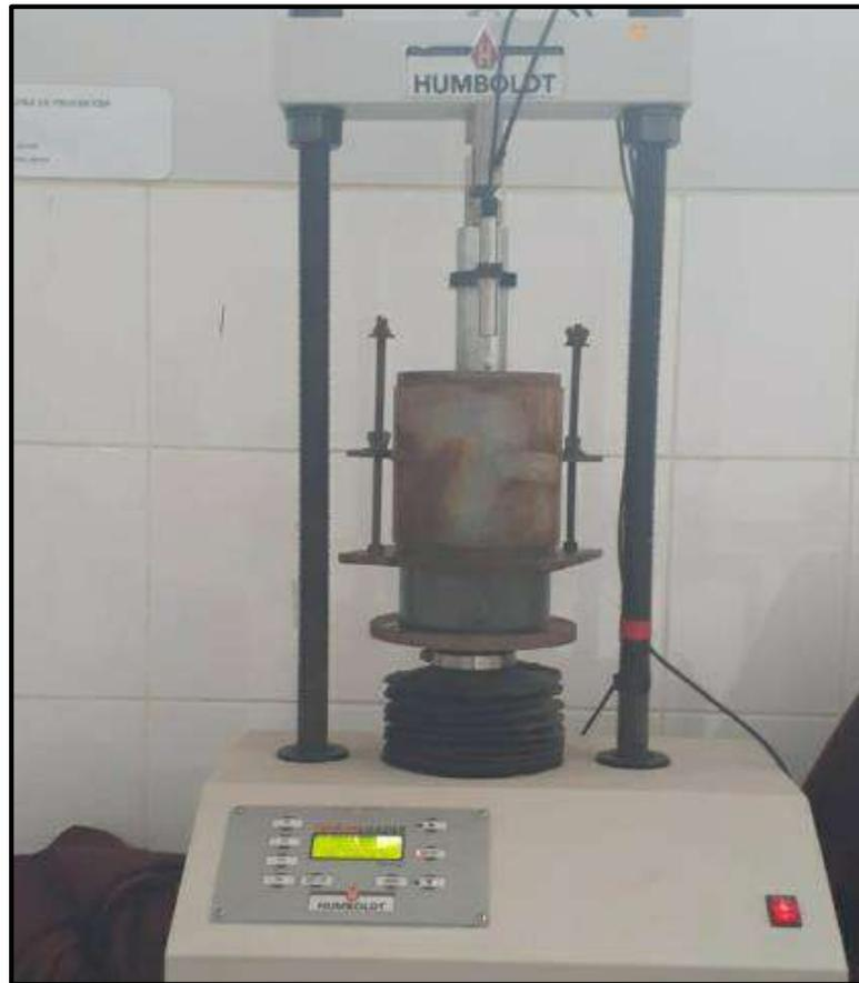
**Foto N°31.-** En la imagen observamos el procedimiento realizado para el test de penetración, se ensayaron las muestras en un equipo electrónico Humboldt la cual contaba con una capacidad de 50 KN. Posteriormente tomamos nota de los datos de carga y penetración en la muestra ensayada. Y al final tomamos una muestra para el cálculo de contenido de humedad.
