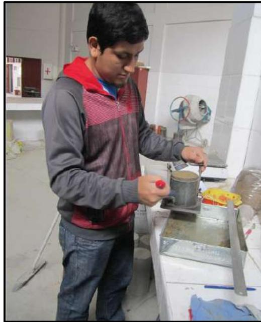
**Foto N°27.-** En la imagen se aprecia el razado del material utilizando una espátula, para proceder a su pesaje.
