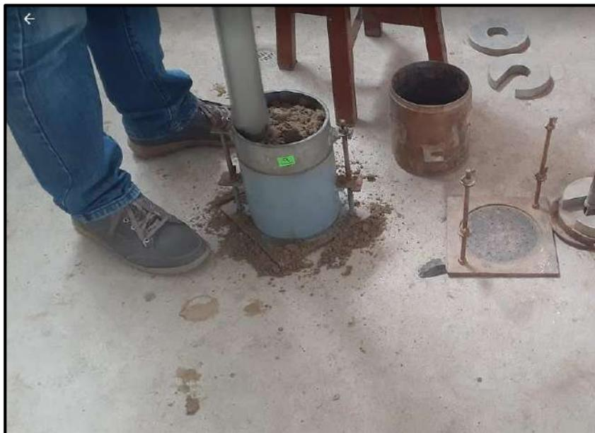
**Foto N°26.-** En la imagen observamos la muestra siendo compactada en la última capa de la superficie, en este caso se tomaron 5 capas por tratarse del molde del Proctor Modificado se aplicó un sistema de compactación de 55, 26 y 12 golpes por capa
