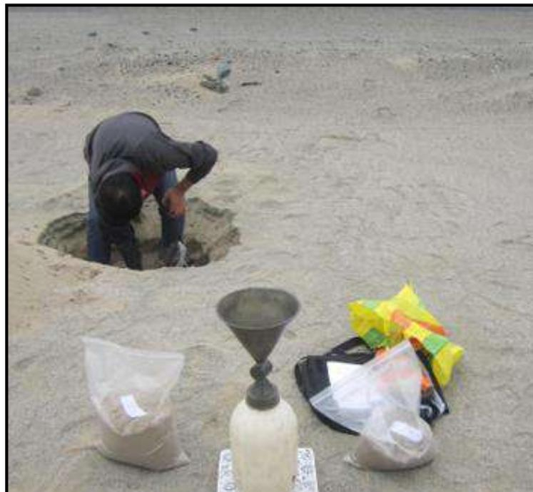
**Foto N°08.-** En el proceso de exploración del suelo, se encontraron diferentes estratos, los cuales fueron seleccionados en bolsas herméticas para el posterior evaluación en el laboratorio de mecánica de suelos.
