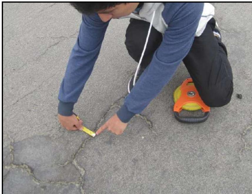
**Foto N°04.-** Vista de evaluación de condición del pavimento, un tipo de falla que presentó mayor incidencia fue el fisuramiento longitudinal y transversal en la pista de aterrizaje.
