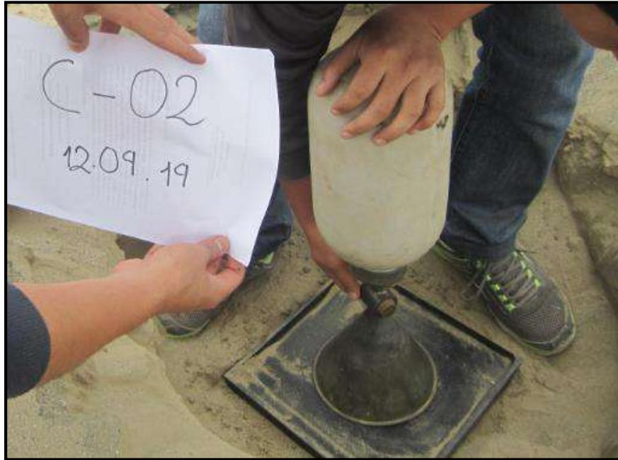
**Foto N°07.-** Vista de proceso de ensayo de densidad de campo con el cono de arena en la calicata C-02 en la zona de estudio.
