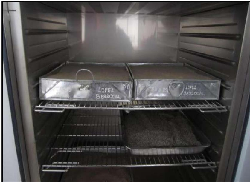
**Foto N°23.-** Luego de realizar los ensayos de Proctor modificado, en la imagen observamos la toma de muestras para realizar el ensayo CBR, siendo secadas dentro el horno.
