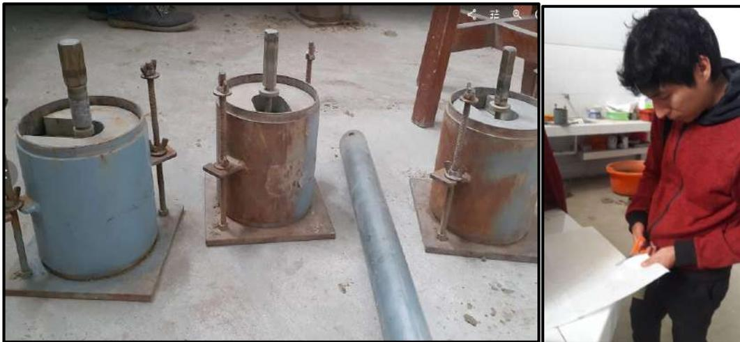
**Foto N°28.-** Terminada la compactación, se quitó el collar y se volvió a montar pero de forma invertida, sin disco espaciador, colocando un papel filtro entre el molde y la base para posteriormente ser pesado.
