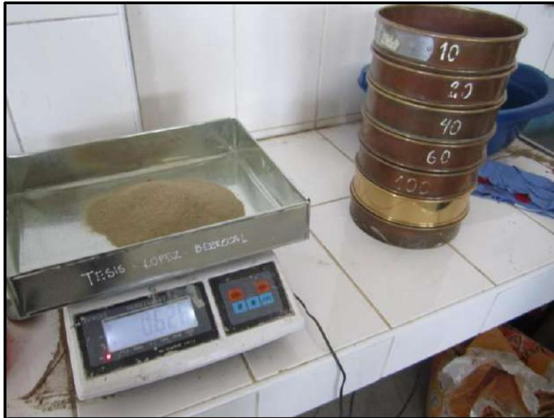
**Foto N°15.-** En la imagen apreciamos el pesaje de las muestras que se usaran para los ensayos de laboratorio: Granulometría, contenido de humedad, Proctor y CBR. Además del pesaje de los equipos que usaremos para cada ensayo.
