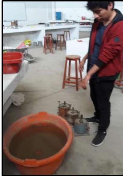
**Foto N°29.-** En la imagen apreciamos el proceso de inmersión, se realizó la colocación de los moldes dentro de recipientes con agua para saturar las muestras aprox 48 horas, para proceder con el test de penetración.
