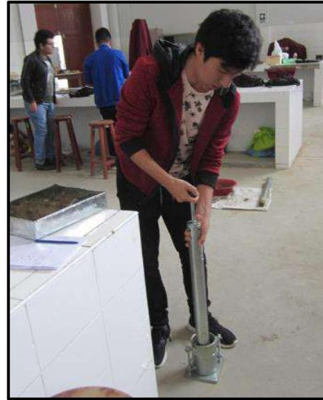
**Foto N°19.-** En la imagen observamos la compactación de la muestra haciendo uso del pistón para la primera capa..
