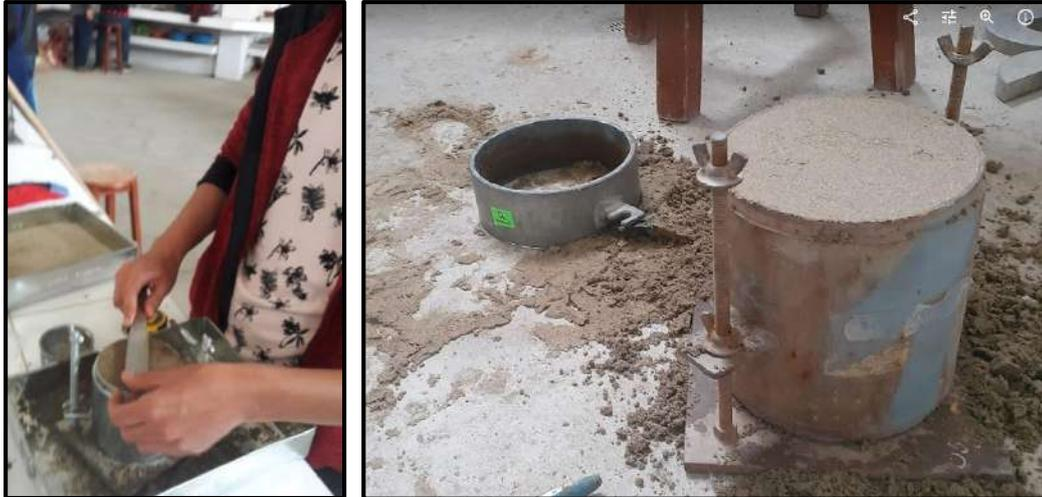
**Foto N°21.-** En las imágenes se aprecia el nivelado de la superficie de las muestras, procediendo al pesado para los cálculos.
