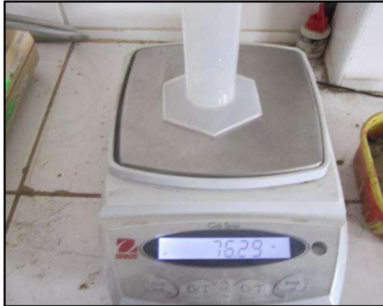
**Foto N°17.-** Con los datos de las muestras tomadas se determinó el método A (menos del 20% de peso de material fue retenido en el tamiz 4.75mm (N°4) para el cálculo del óptimo contenido de humedad para los ensayos Proctor (5%, 7%, 9%, 11% y 13%)
