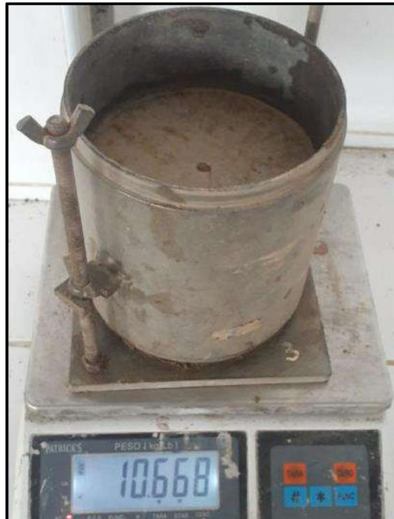
**Foto N°30.-** Después del tiempo de reposo, se retiraron las muestras saturadas, se procede a quitar la sobrecarga y la placa perforada, inmediatamente fueron pesados para proceder al ensayo de penetración.
