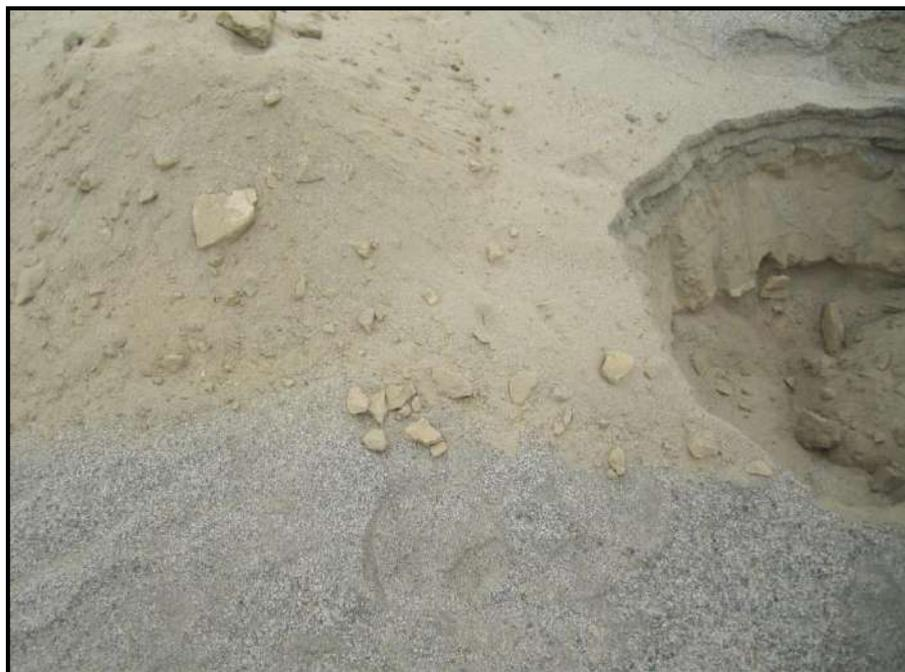
**Foto N°06.-** Se notó la presencia de una ligera capa de arcilla en los primeros 20cm de excavación en la exploración del suelo en la zona de estudio.
