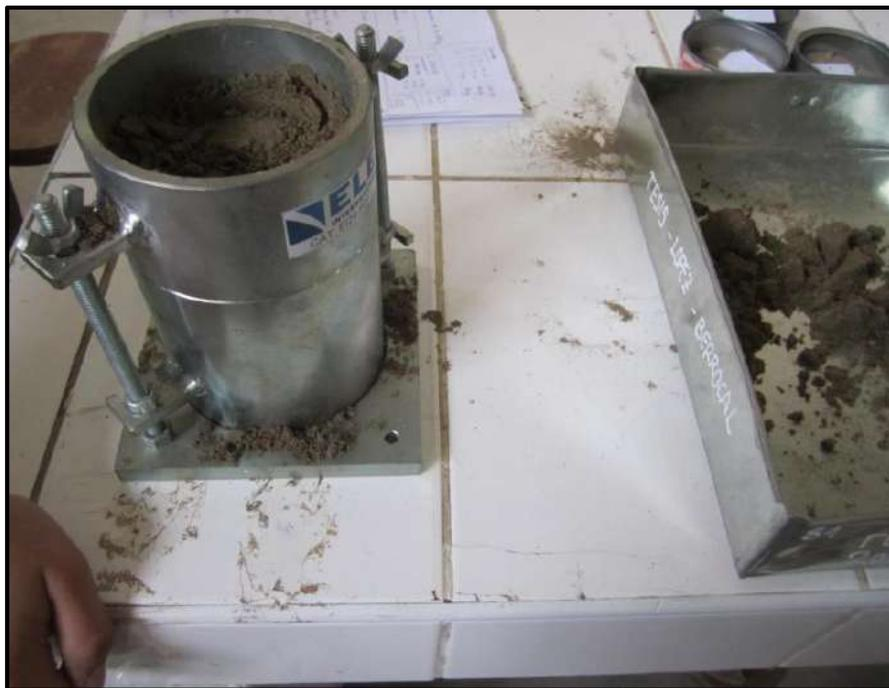
**Foto N°20.-** La compactación se realiza para cinco capas, llenando cada capa a 1/5 de altura del cilindro, Procediendo a realizar 5 capas de 25 golpes cada una
