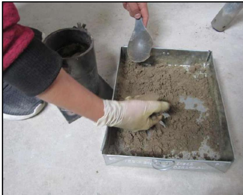
**Foto N°18.-** En la fotografía notamos que la muestra fue preparada hasta obtener una mezcla de suelo homogénea que procederá colocada en el molde cilíndrico.
