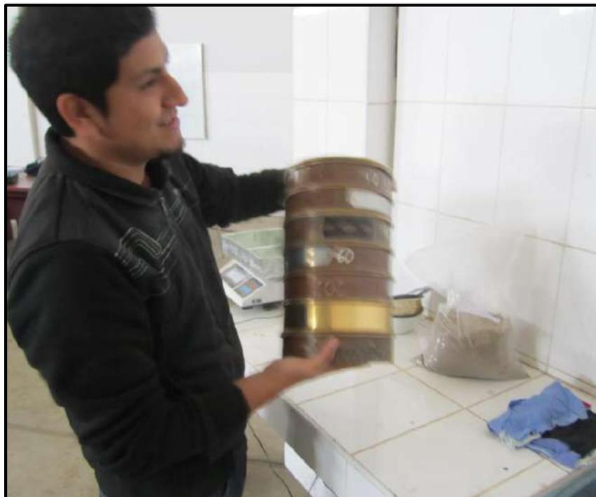
**Foto N°16.-** Con la muestra seleccionada se procede a realizar el ensayo de Granulometría, mediante los tamices N°10, N°20, N°40, N°60, N°100 y N°200 eliminamos los residuos y muestras orgánicas.
