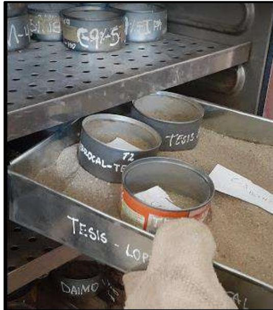
**Foto N°25.-** En la fotografía se observa que también se separó una porción de aproximadamente 150g de muestra para el cálculo de su contenido de humedad por cada ensayo.
