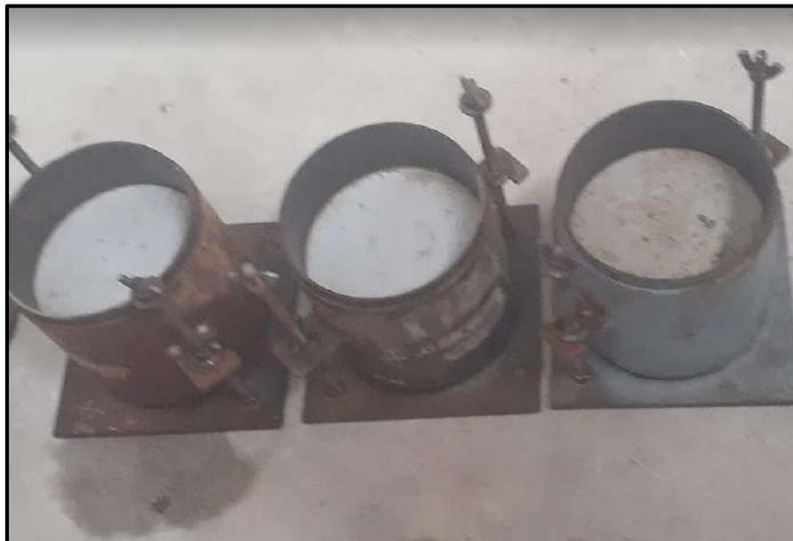
**Foto N°24.-** Se procede al armado de los 03 moldes, asegurándose que no queden fugas, se colocó el collar y el disco espaciador y sobre este un papel filtro del mismo diámetro.
