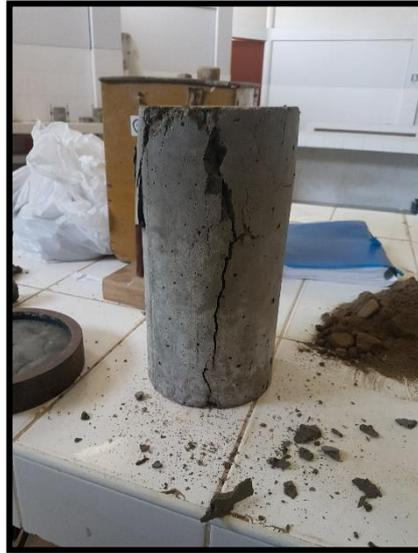
**Foto 13:** Testigo (probeta) de concreto ensayado.
