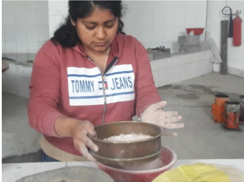
**Foto 7:** Análisis granulométrico por tamizado del agregado fino
