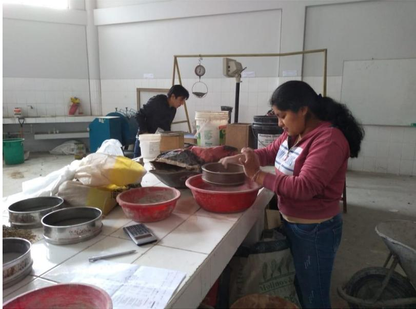
**Foto 5:** Tamizado con las mallas estándar del agregado fino para hallar su granulometría.
