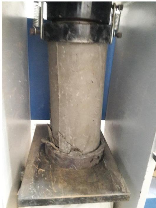
**Foto 14:** Testigo (probeta) de concreto ensayado.
