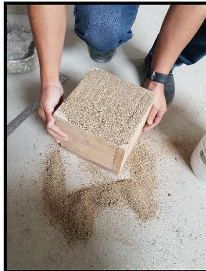
**Foto 8:** Ensayo para resultado de peso unitario del agregado fino.
