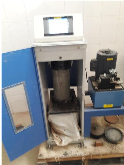
**Foto 15:** Ensayo de compresión de testigos (probeta).
