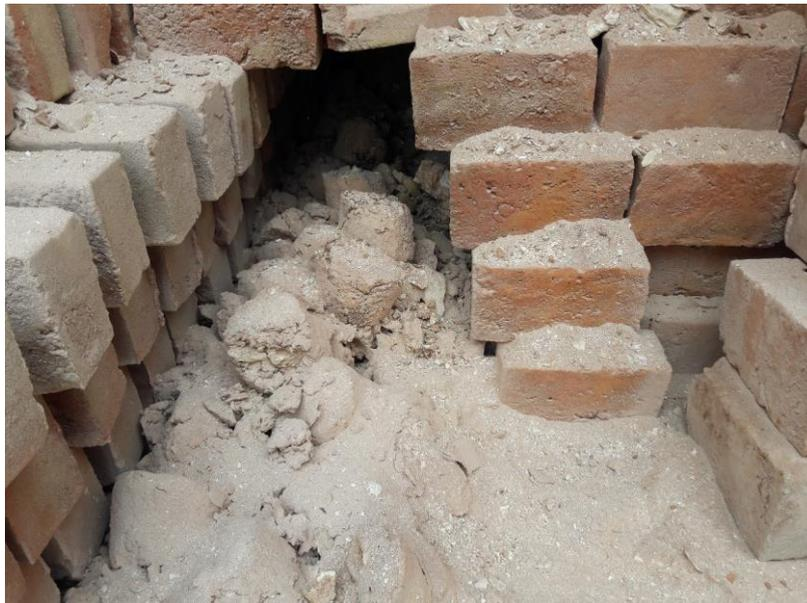
**Foto 4:** Cenizas de briquetas de carbón, posterior al cocido de ladrillos.
