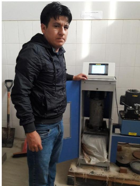
**Foto 16:** Ensayo de compresión de testigos (probeta).
