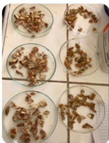
Pesar las placas y anotar; Luego pesar la muestras + la placa
