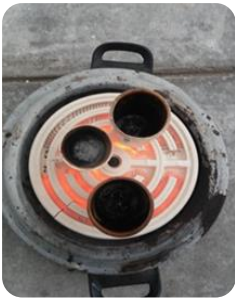
Anotar peso de crisoles y Quemar la muestra
