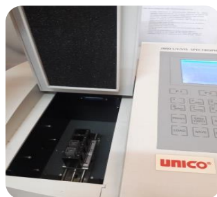
colocar las celdas en el equipo
