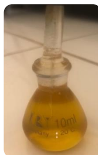
adición de muestra en picnómetro
