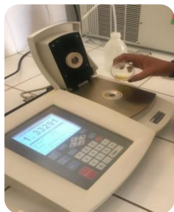
Limpiar la parte del sensor con agua destilada
