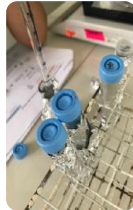
Añadir 50 uL de \text{Na}_2\text{CO}_3 a todos los tubos
