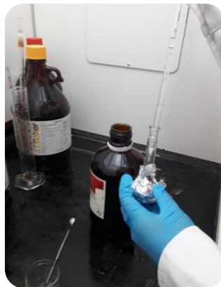
Adición en fiola de 25 ml y agregar el ácido acético
