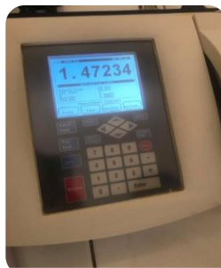
Agregar la muestra al refractómetro y lecturar.
